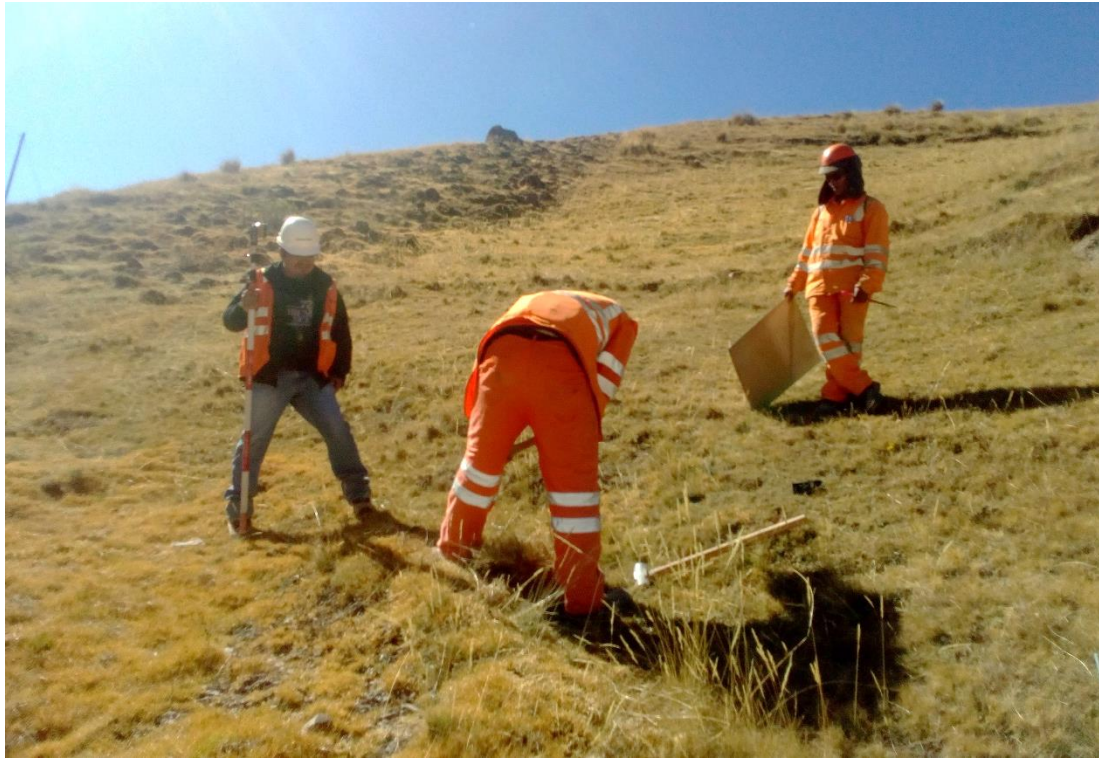
Fotografía 7. Ubicación para puntos de control terrestre GCP.
