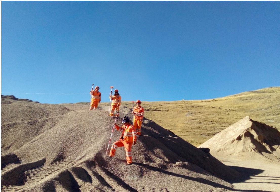
Fotografía 13. Levantamiento topograficos con estacion total.
