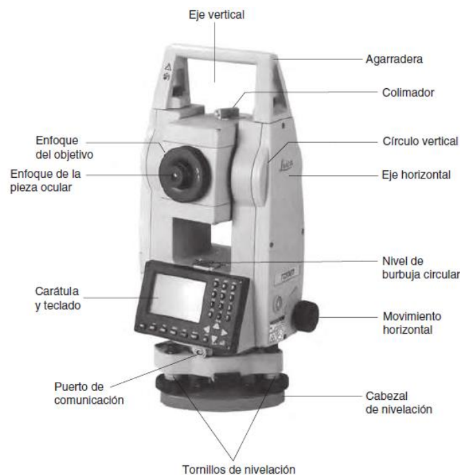
Figura 6. Partes de un instrumento de Estación Total Leica
