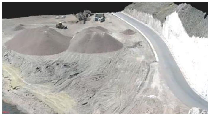
Figura 18. Modelo 3D de terreno, de fotogrametría digital
