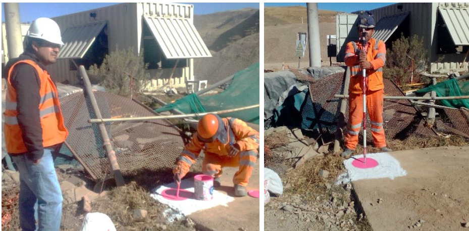
Figura 67. Señalización de puntos de control terrestre
