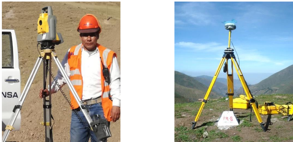
Figura 3. Estación total Trimble 5603-DR200 y GPS Receptor GNSS Trimble R8
