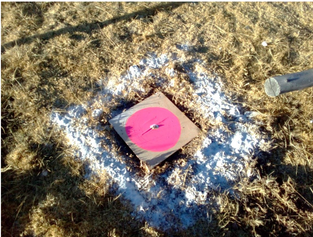
Fotografía 10. Demarcacion y pintado de GCP.
