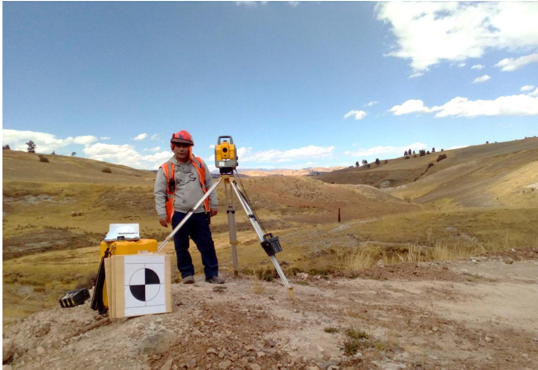
Fotografía 11. Posicionamiento (estacionamiento) de la Estacion Total.
