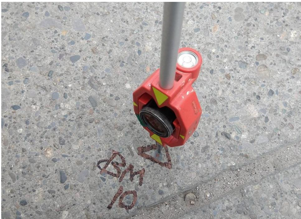
Imagen 8: Marcado de puntos BMs para el levantamiento topográfico.
