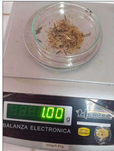
Fotografía 6. Pesado de las muestras de 01 g para la determinación de pureza de la semilla.
