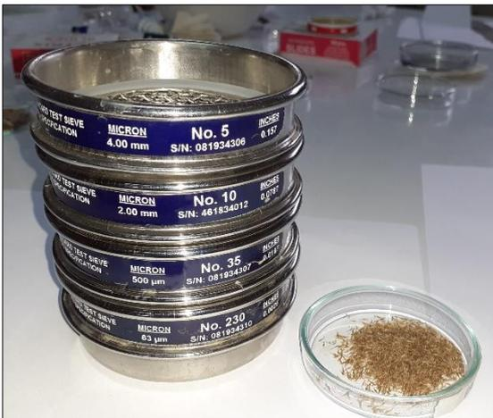
Fotografía 7. Tamizado de la semilla de capirona para determinar la pureza de las semillas.
