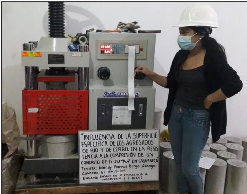
*Figura N° 43: Ensayo de la resistencia a la compresión a los 7 días - Cantera El Gavilán.*
