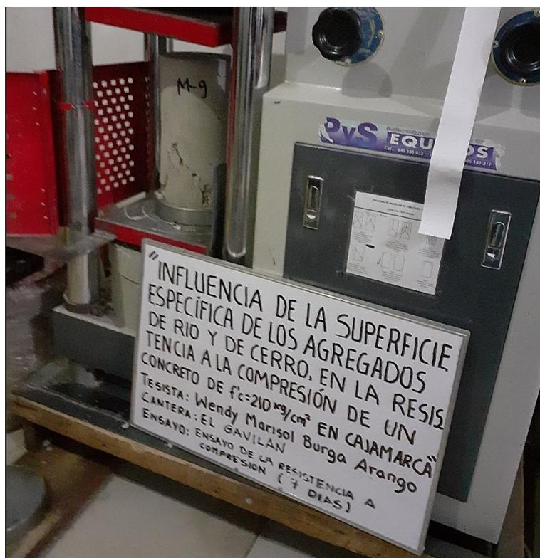
*Figura N° 44: Fractura del espécimen de concreto, tipo 5.*
