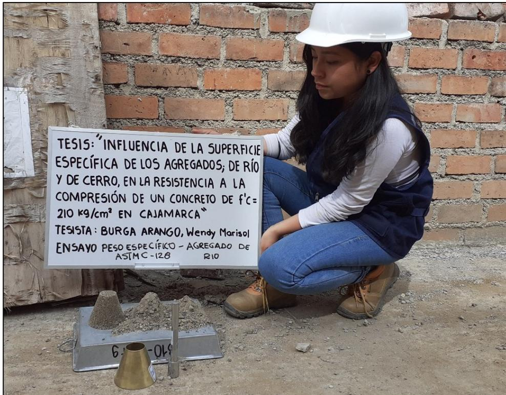
**Figura N° 20:** *Peso específico del agregado fino de río.
