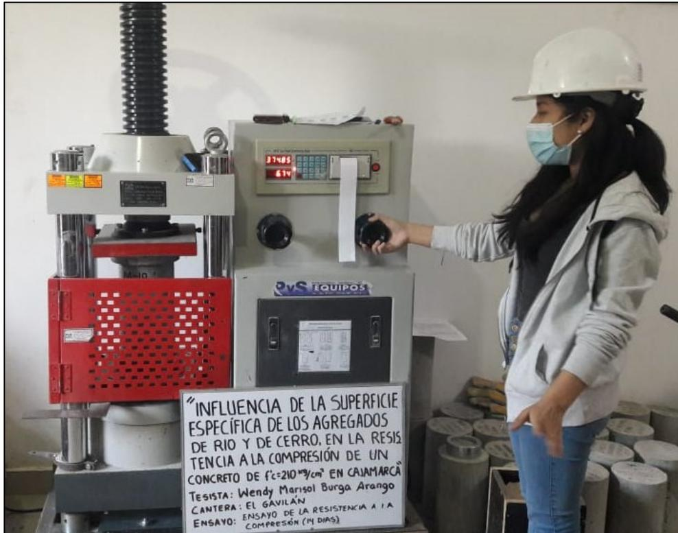
*Figura N° 45: Ensayo de la resistencia a la compresión a los 14 días - Cantera El Gavilán.*
