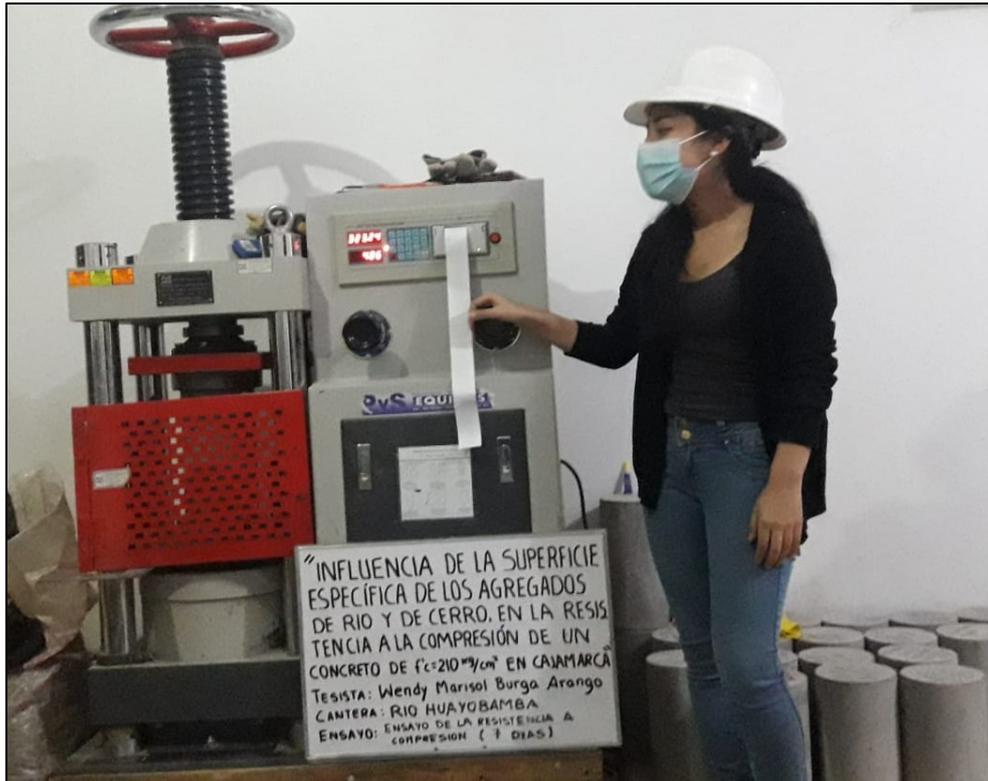
*Figura N° 37: Ensayo de la resistencia a la compresión a los 7 días - Cantera Huayobamba.*
