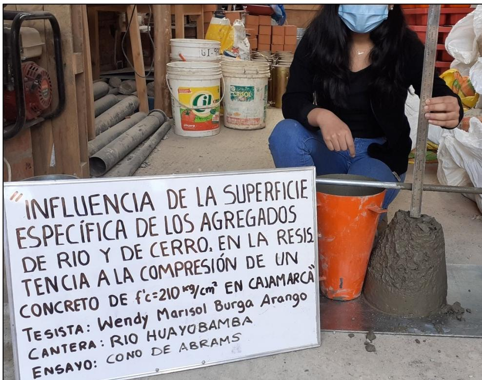
*Figura N° 30: Determinación de la consistencia del concreto - Cantera Huayobamba.*
