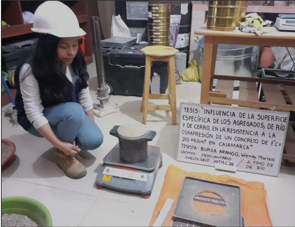
*Figura N° 12: Peso unitario suelto seco del agregado fino de río.*
