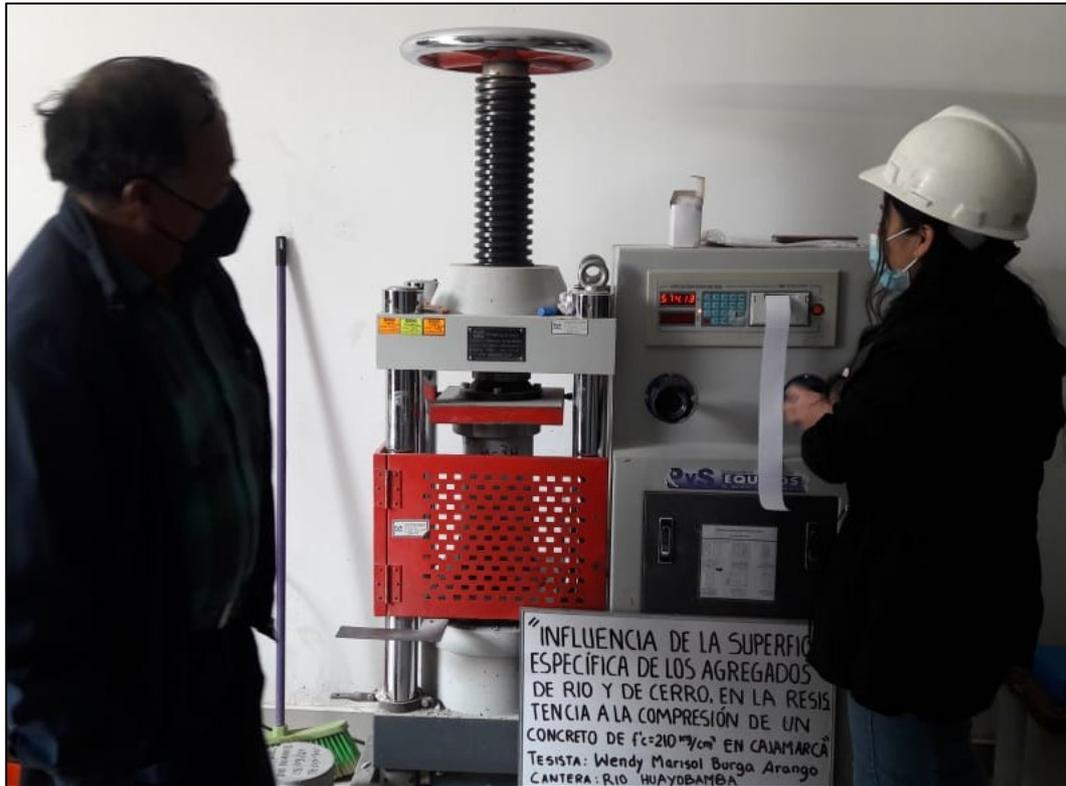
*Figura N° 41: Ensayo de la resistencia a la compresión a los 28 días - Cantera Huayobamba.*
