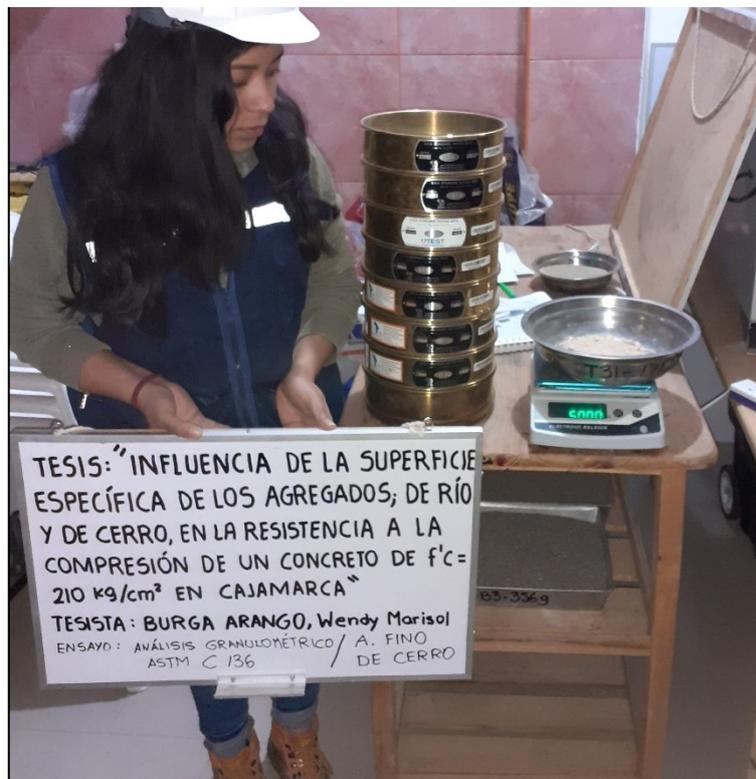
*Figura N° 28: Análisis Granulométrico del agregado fino de cerro.*
