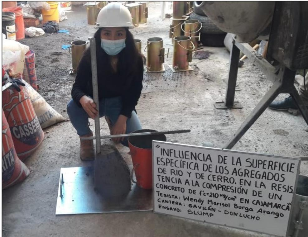
*Figura N° 33: Determinación de la consistencia del concreto - Cantera El Gavilán.*
