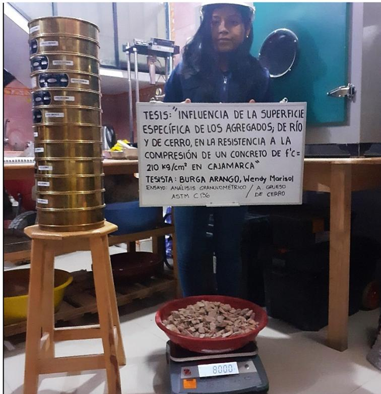
*Figura N° 27: Análisis Granulométrico del agregado grueso de cerro.*
