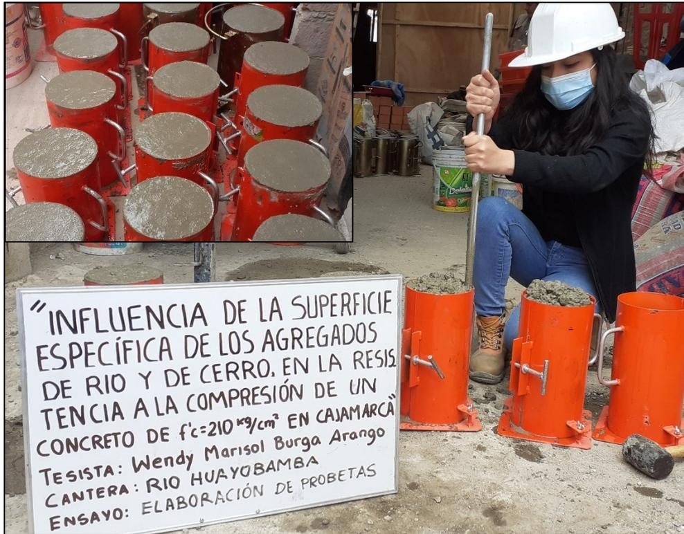
*Figura N° 31: Elaboración de los especímenes de concreto - Cantera Huayobamba.*
