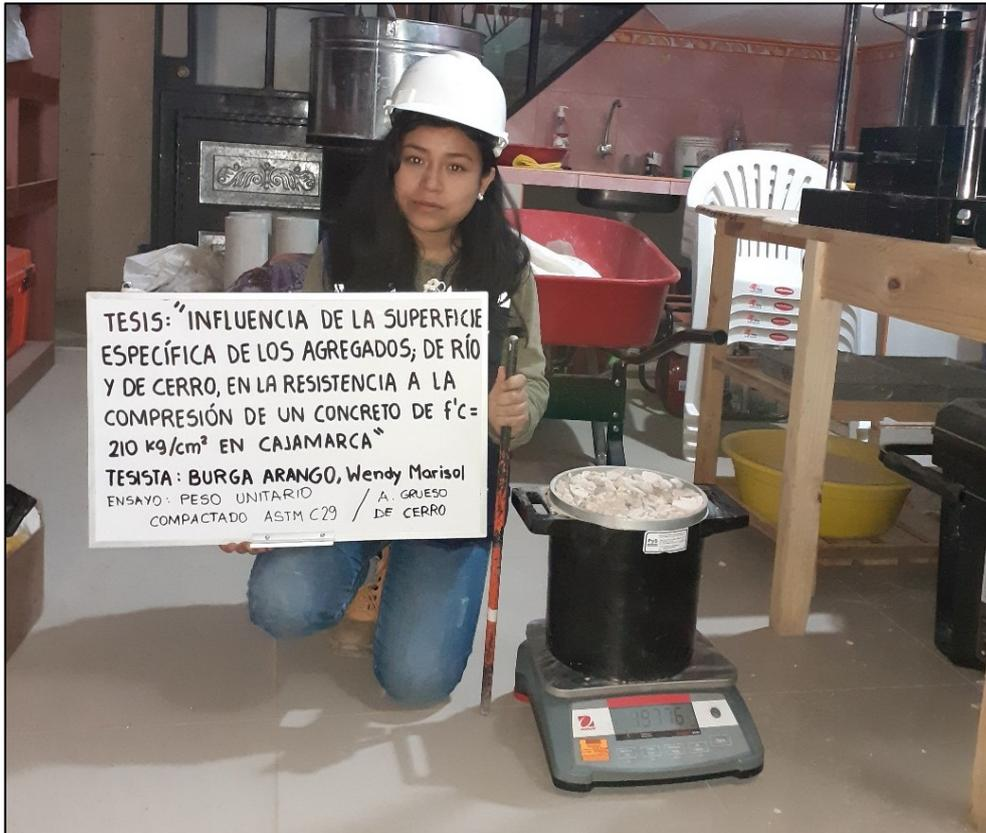
*Figura N° 17: Peso unitario compactado del agregado grueso de cerro.*
