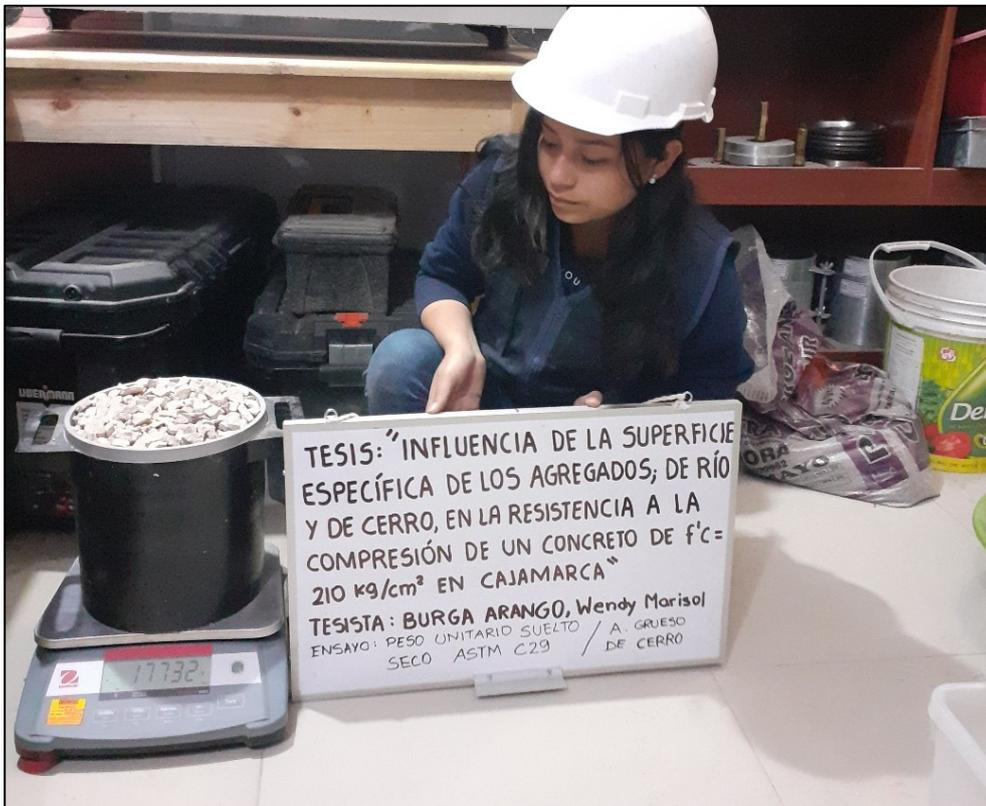
*Figura N° 13: Peso unitario suelto seco del agregado grueso de cerro.*
