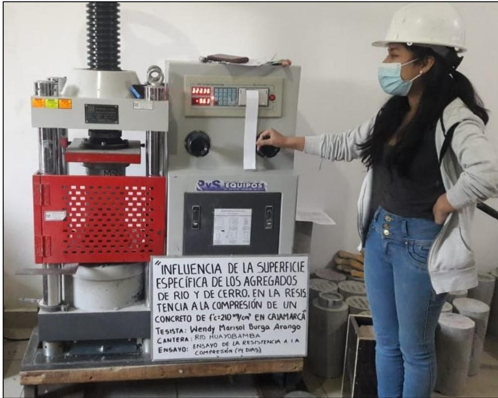
*Figura N° 39: Ensayo de la resistencia a la compresión a los 14 días - Cantera Huayobamba.*
