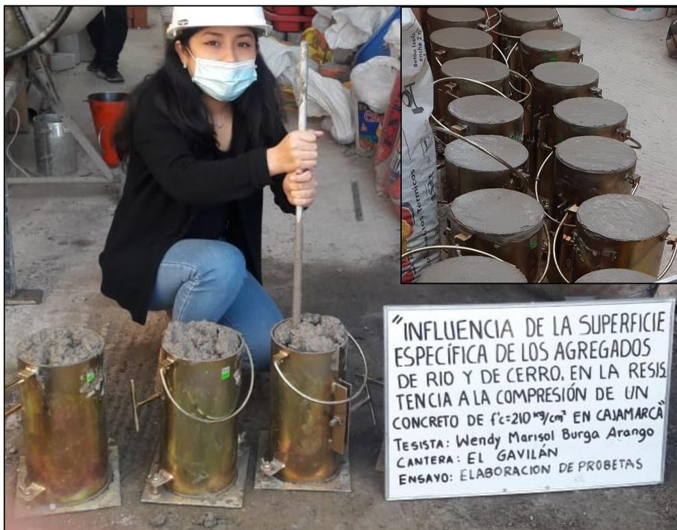
*Figura N° 34: Elaboración de los especímenes de concreto - Cantera El Gavilán.*
