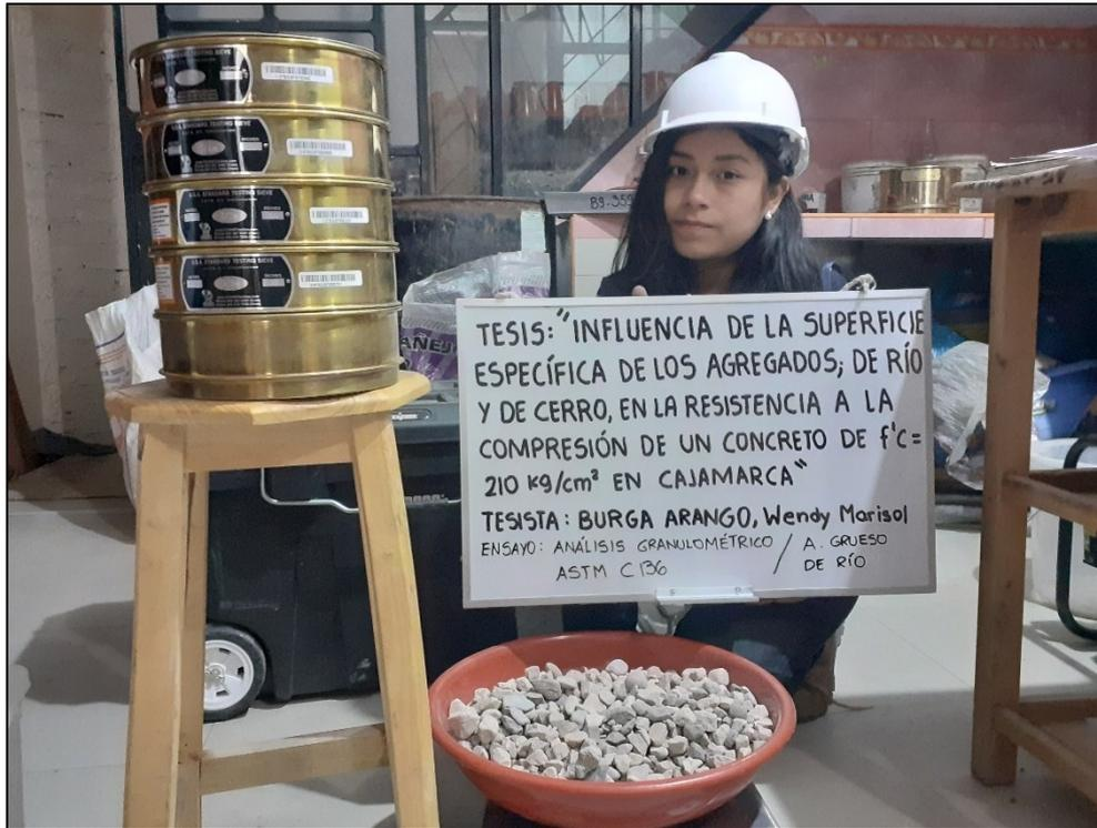
*Figura N° 25: Análisis Granulométrico del agregado grueso de río.*
