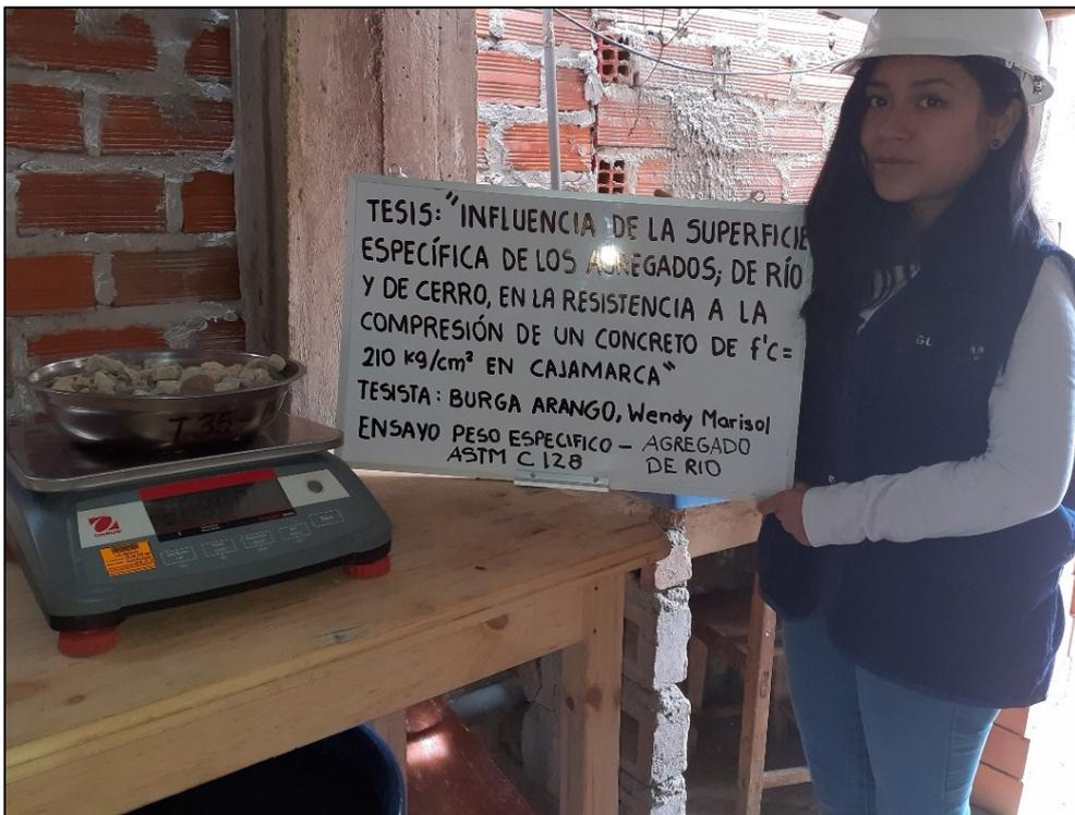
**Figura N° 19:** *Peso específico del agregado grueso de río.
