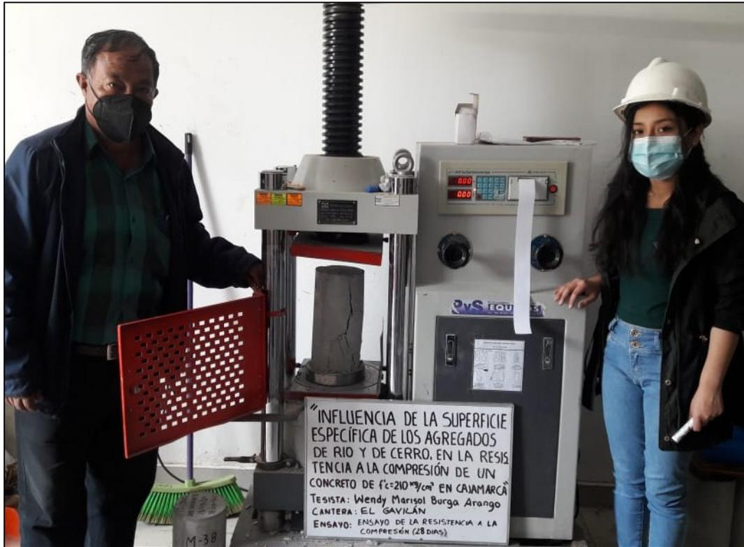
*Figura N° 47: Ensayo de la resistencia a la compresión a los 28 días - Cantera El Gavilán.*
