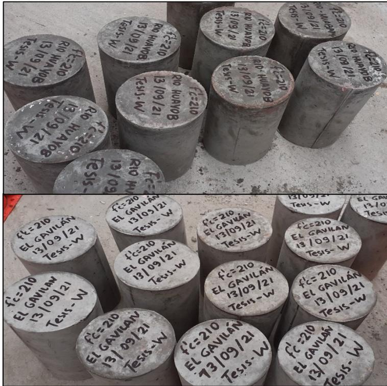
*Figura N° 35: Especímenes de concreto desencofrados.*
