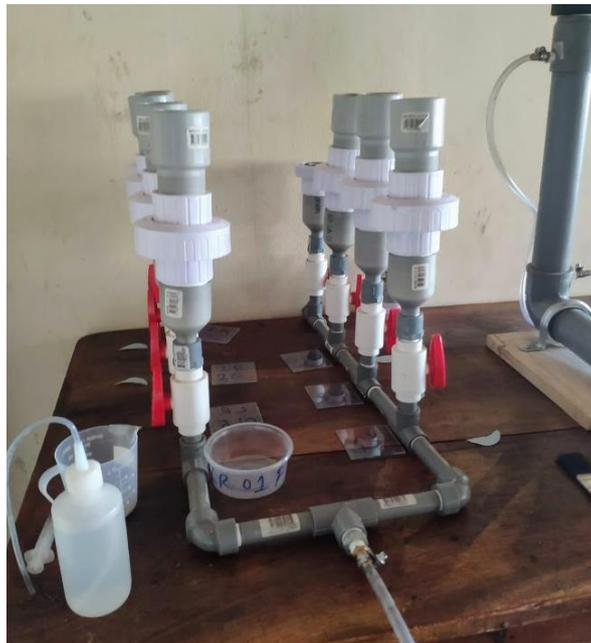
*Figura 84 Filtrado de las muestras de sedimentos*
