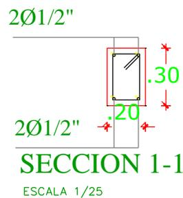
**Figura 3.22** Sección única de la viga de amarre
