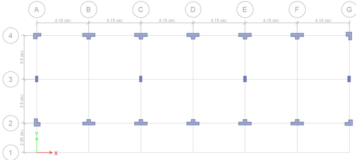
**Figura 3.23 Configuración en planta de los elementos resistentes pabellón III teniendo dos bloques con la misma configuración.**
