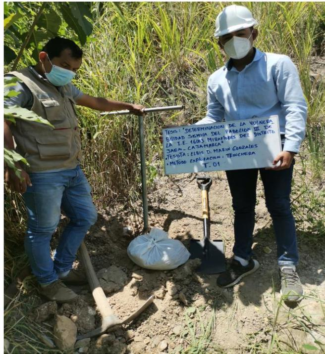
Fotografía 7. Estudio de mecánica de suelos por método de exploración Trinchera en talud
