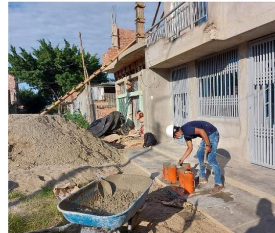
**Figura 70.** Proceso de nivelado de concreto en los moldes
