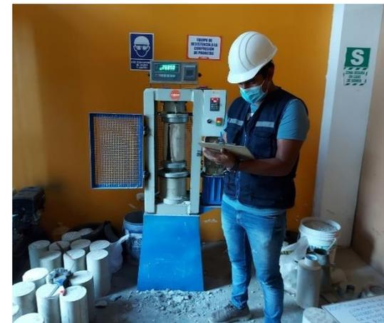
**Figura 76.** Rotura de testigos de concreto de obra 10, a la edad de 14 días
