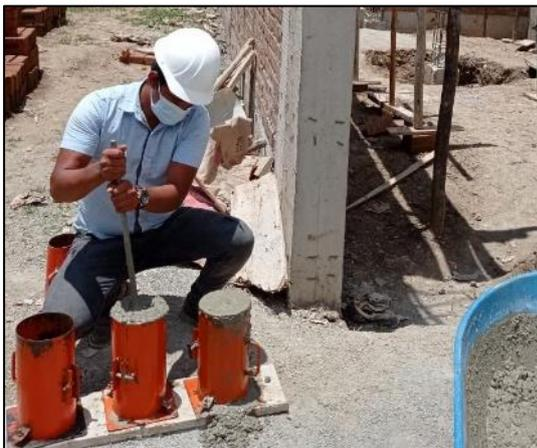
**Figura 41.** *Testigos de concreto*
