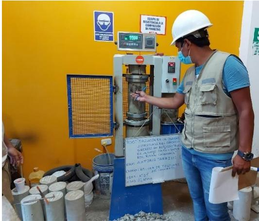
**Figura 73.** Rotura de testigos de concreto de obra 02, a la edad de 28 días
