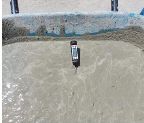
**Figura 58.** *Temperatura del concreto = 32.4 °C*
