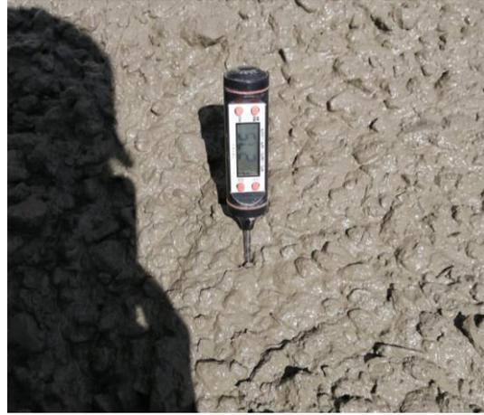
**Figura 56.** *Temperatura del concreto = 29.5 °C*
