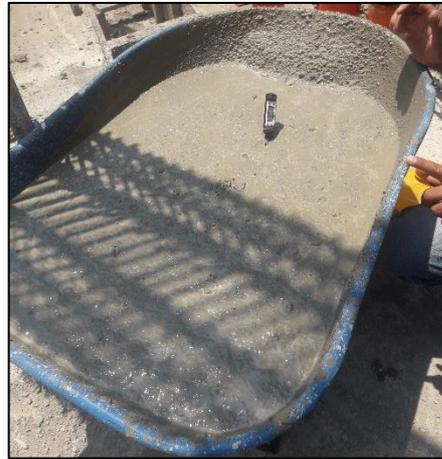
En la Figura 36 y 37, se presenta la realización del ensayo para medir la temperatura del concreto en estado fresco, se observa el termómetro introducido en la mezcla de concreto fresco, este ensayo fue realizado tres veces en cada obra, se hizo siguiendo los procedimientos y utilizando los equipos e instrumentos de la NTP 339.184, 2013 “CONCRETO. Método de ensayo normalizado para determinar la temperatura de mezclas de concreto.
