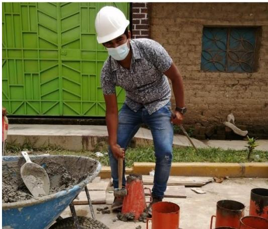
**Figura 63.** *Asentamiento del concreto = 6 pulgadas*
