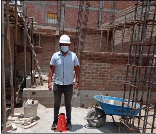
**Figura 39.** *Asentamiento del concreto*
