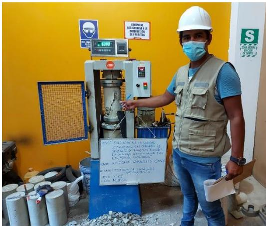
**Figura 75.** Registro de cargas de rotura de los testigos de concreto
