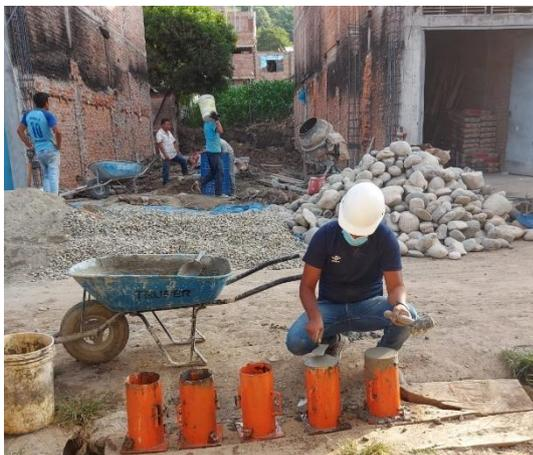
**Figura 71.** Testigos de concreto elaborados en obra
