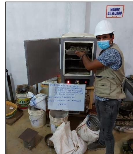
En la Figura 48 y 49, se presenta el proceso de colocación de las muestras en el horno de agregado fino y grueso respectivamente, parte del proceso del ensayo de contenido de
