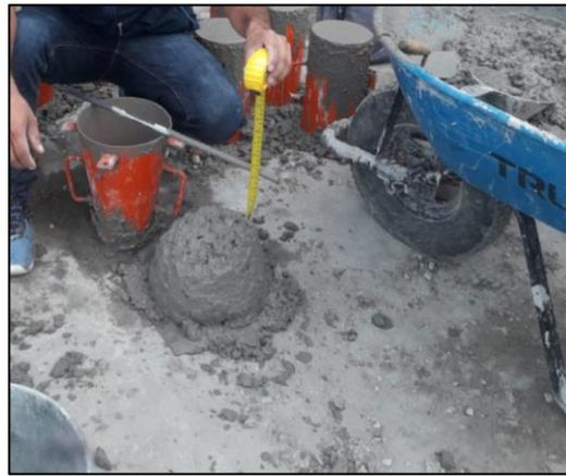
En la Figura 38 se presenta el proceso de fijado del cono de Abrams sobre el terreno para la realización del ensayo para medir el asentamiento (slump) del concreto en estado fresco; mientras que en la Figura 39 se observa la medición del asentamiento. Todos los equipos, instrumentos y los procedimientos fueron de acuerdo con la NTP 339.035, 2009 “CONCRETO. Método de ensayo para la medición del asentamiento del concreto de cemento Portland”
