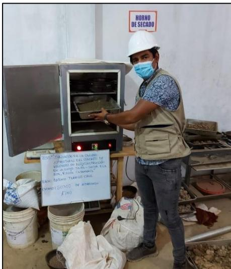
**Figura 49.** Colocación al horno de la muestra de agregado grueso
