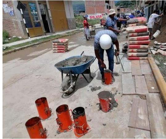
**Figura 68.** Proceso de martillado del molde con concreto
