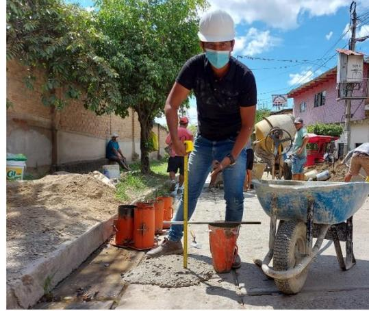
**Figura 62.** *Realización de ensayo con el cono de Abrams*
