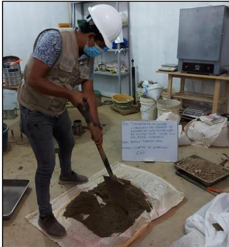
**Figura 47.** Cuarteo de agregado grueso
