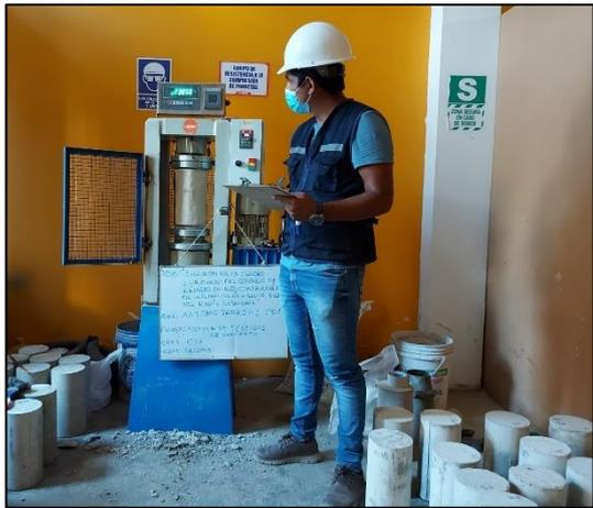
En la **Figura 44** se presenta el ensayo de rotura de testigos de concreto a la edad de los 3 días de curado de los testigos extraídos de la obra 10; mientras que en la **Figura 45** se muestra la rotura de un testigo de concreto a la edad de 28 días de curado de la obra 03. Para este ensayo
