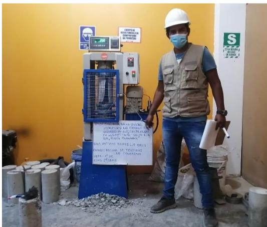
**Figura 77.** Rotura de testigos de concreto de obra 10, a la edad de 7 días
