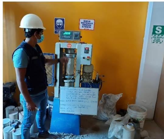
**Figura 74.** Rotura de testigos de concreto de obra 01, a la edad de 14 días
