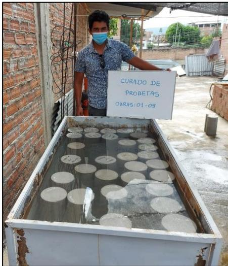
**Figura 43.** Curado de testigos de concreto
