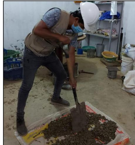
En la Figura 46 y 47, se presenta el proceso de reducción de las muestras a tamaño de ensayo (cuarteo) de agregados fino y grueso respectivamente, los que fueron realizados de acuerdo con la NTP 400.010.
