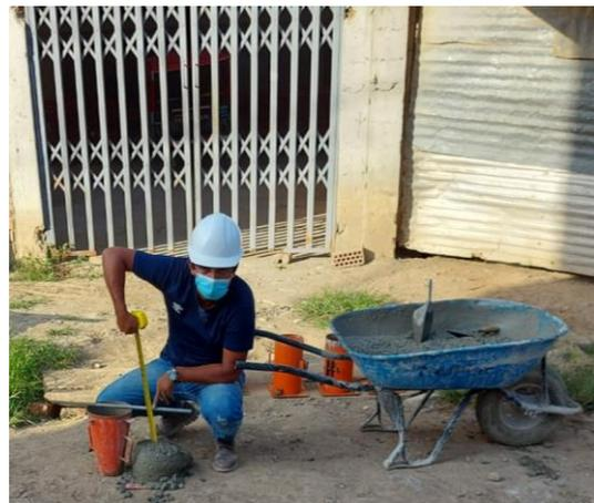
**Figura 64.** *Ubicación de varilla sobre el cono invertido*
