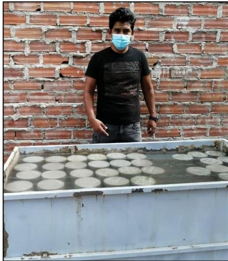
En la **Figura 42 y 43** se presenta el proceso de curado en agua potable de testigos de concreto, lo cual fue realizado cumpliendo los requisitos de la NTP 339.033.
