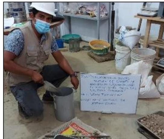
En la Figura 50 se presenta la realización del ensayo de análisis granulométrico, el cual fue realizado de acuerdo con la NTP 400.012; mientras que en la Figura 51 se presenta el proceso de colocación de agregado en el molde, como parte del ensayo de peso unitario, siguiendo lo establecido por la NTP 400.017.
