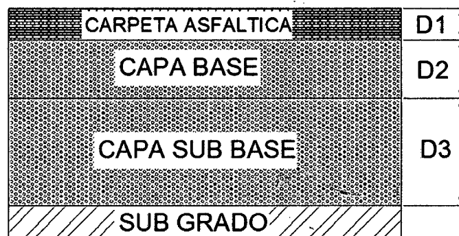
Figura 14 Estructura esquemática de un pavimento flexible
