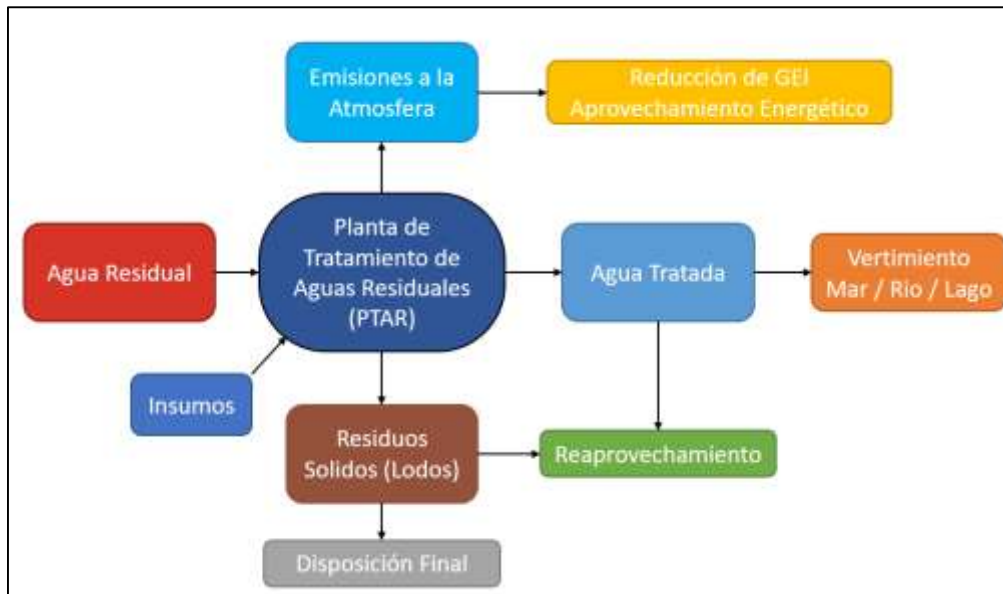
Fig. 3. Esquema conceptual de un sistema de tratamiento de aguas residuales.
