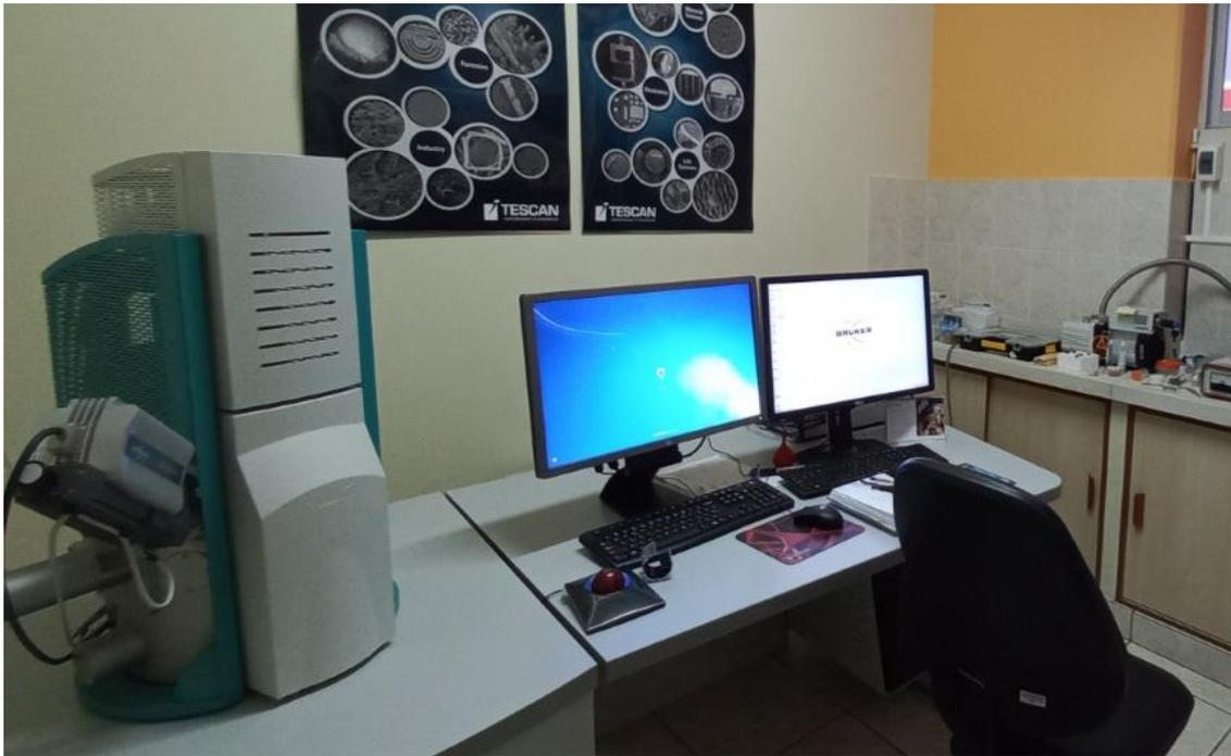
**Figura 38:** Microscopio electrónico de barrido (SEM) TESCAN VEGA3
