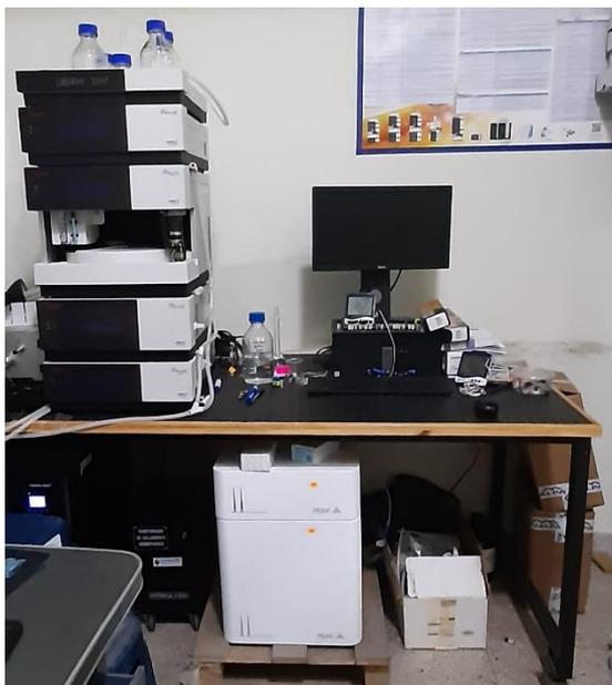
**Figura 30:** Sistema de cromatografía líquida HPLC-UV con un equipo UHPLC Thermo Scientific Ultimate 3000 Rapid Separation
