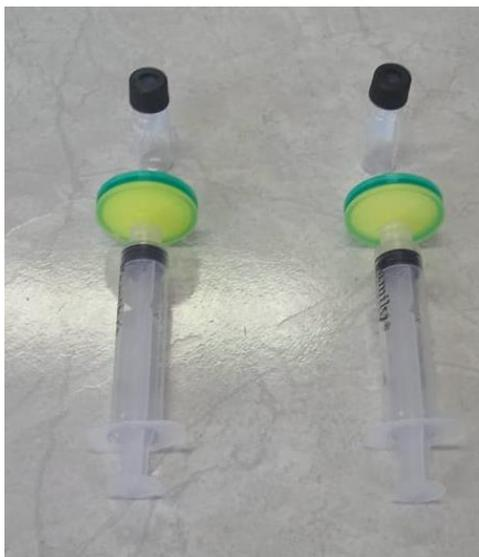
**Figura 32:** Filtrado de muestras para análisis HPLC
