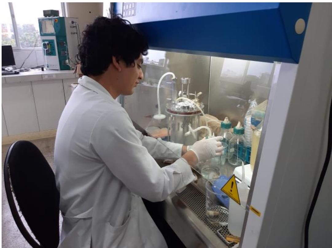
**Figura 24:** Instalación de las conexiones, componentes y filtros del biorreactor para la producción de PHB
