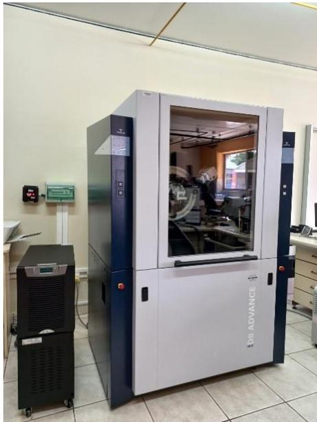
**Figura 39:** Difractómetro de Rayos X
