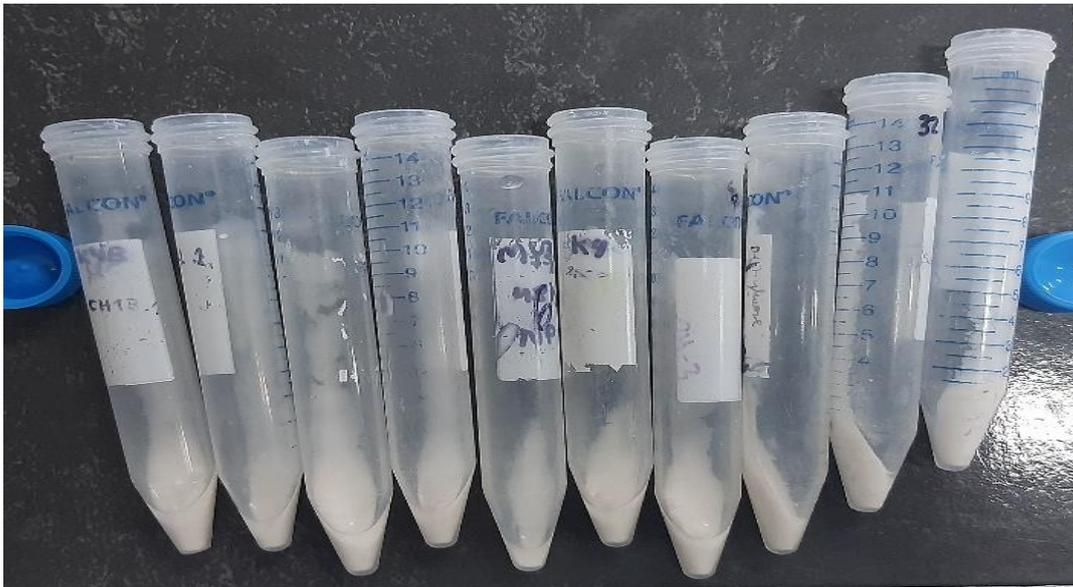
**Figura 28:** PHB centrifugado posterior a la extracción
