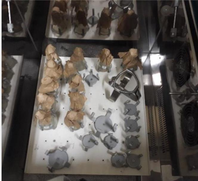
**Figura 21:** Incubación en shaker orbital de matraces.
