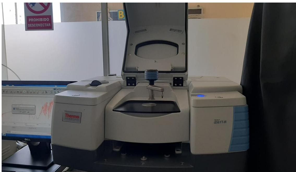
**Figura 34:** Equipo FT-IR Thermo Scientific Nicolet IS50 en modo de Reflectancia Total Atenuada (ATR)
