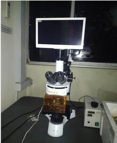
**Figura 16:** Microscopio de fluorescencia marca AMSCOPE
