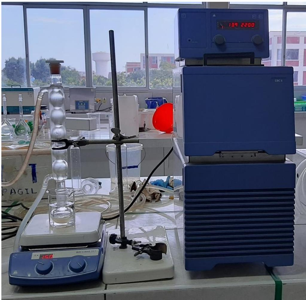
**Figura 36:** Sistema de síntesis de nanoandamios poliméricos acoplado a un intercambiador de calor
