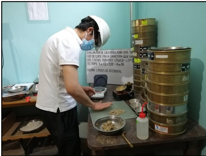
Fotografía 25. Preparación de rollitos para determinar el límite plástico
