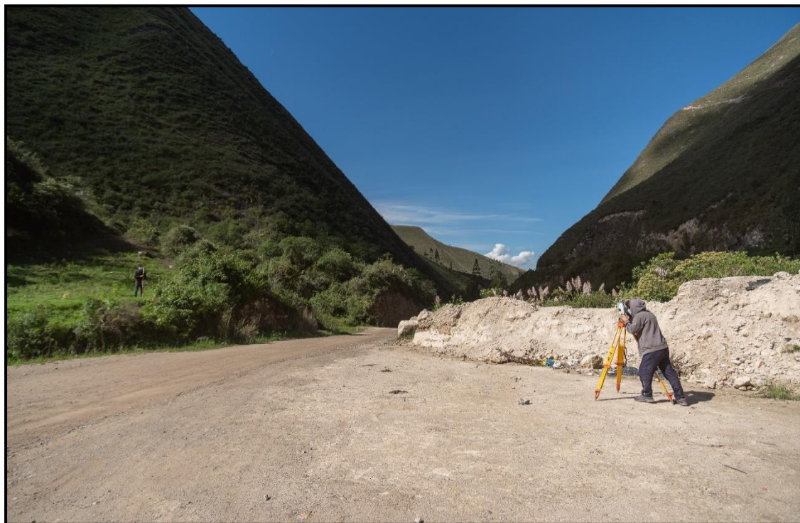
Fotografía 7. Levantamiento Topográfico, toma de puntos en ladera del talud. Progresiva 03+500km
