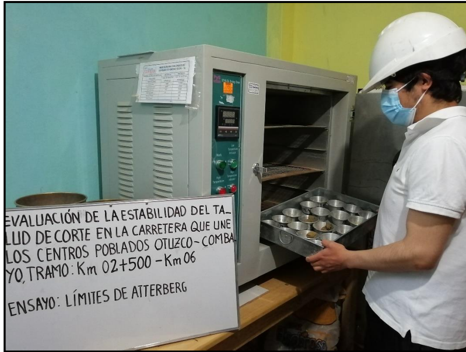
Fotografía 26. Muestras secadas al horno, para establecer los contenidos de humedad
