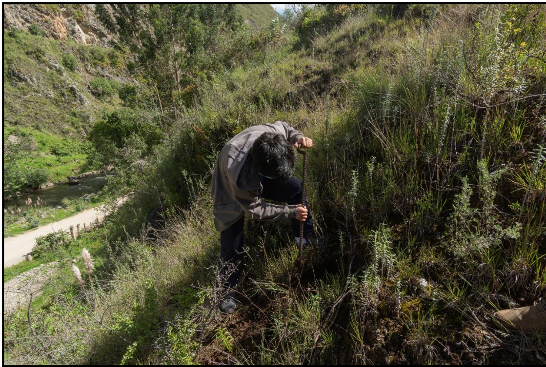
Fotografía 13. Excavación para calicata. Progresiva 04+330 km
