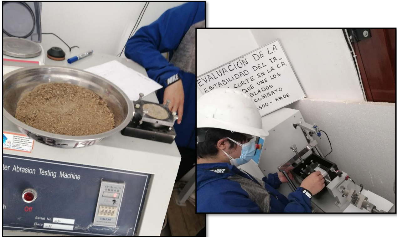
Fotografía 28. Corte Directo: Preparación y ensayo de muestra CD-02
