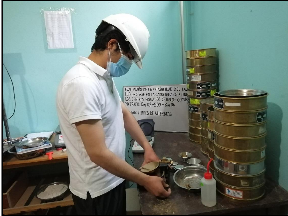
Fotografía 24. Registro del número de golpes, para el primer contenido de humedad
