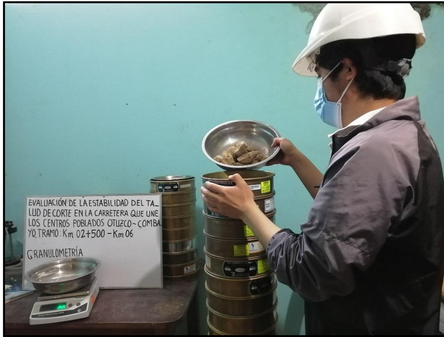
Fotografía 22. Ensayo Granulométrico, fracción retenida el tamiz N°4
