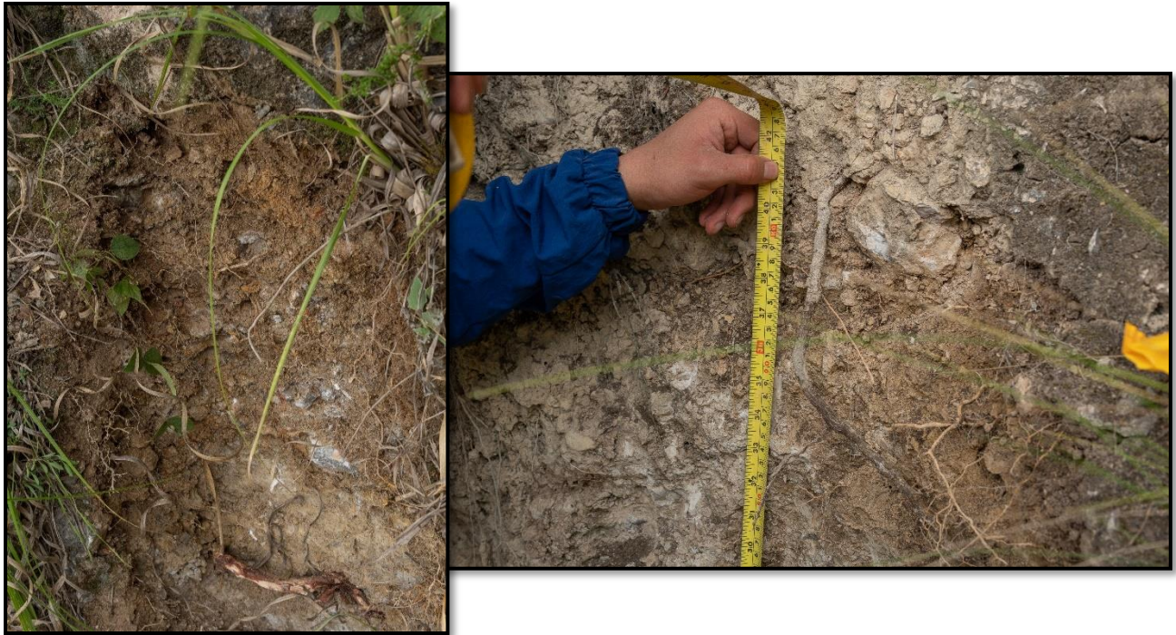
Fotografía 17. Calicata N°4: material de calicata y profundidad. Progresiva 04+330 km
