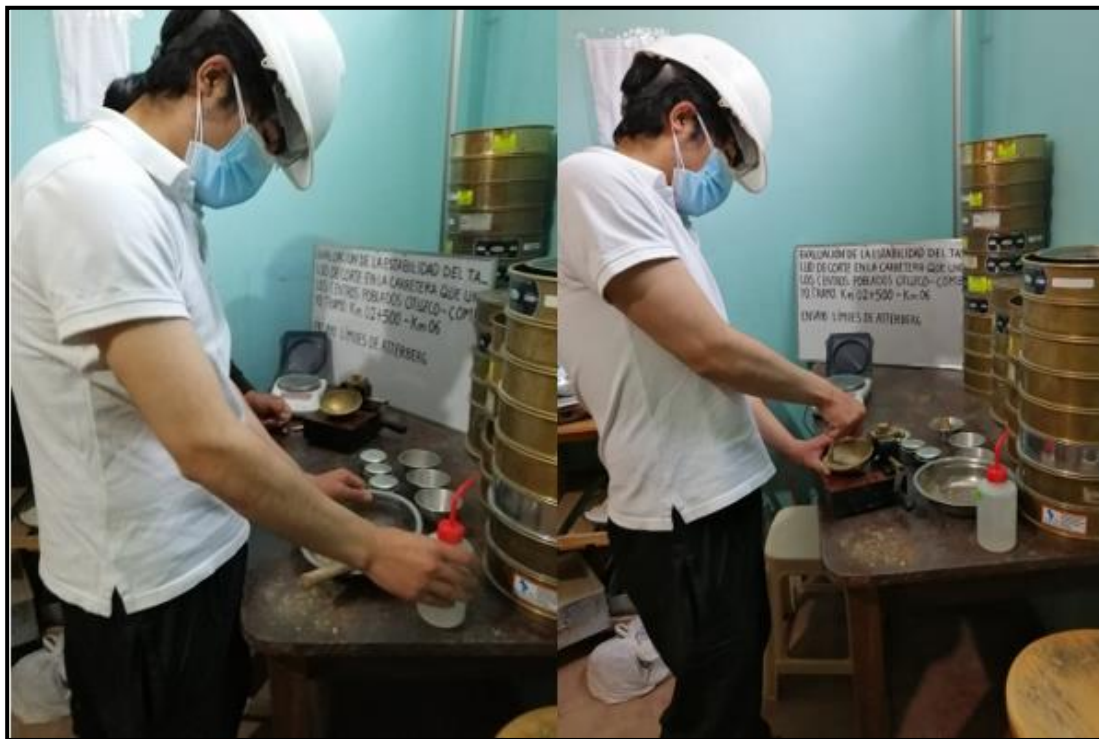
Fotografía 22. Ensayo Granulométrico, fracción retenida el tamiz N°4
