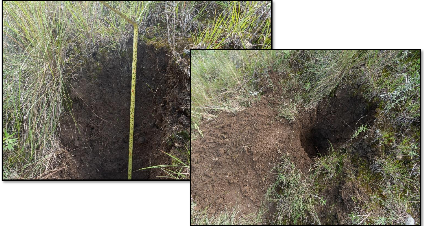
Fotografía 15. Calicata N°6: profundidad y material extraído. Progresiva 05+700 km
