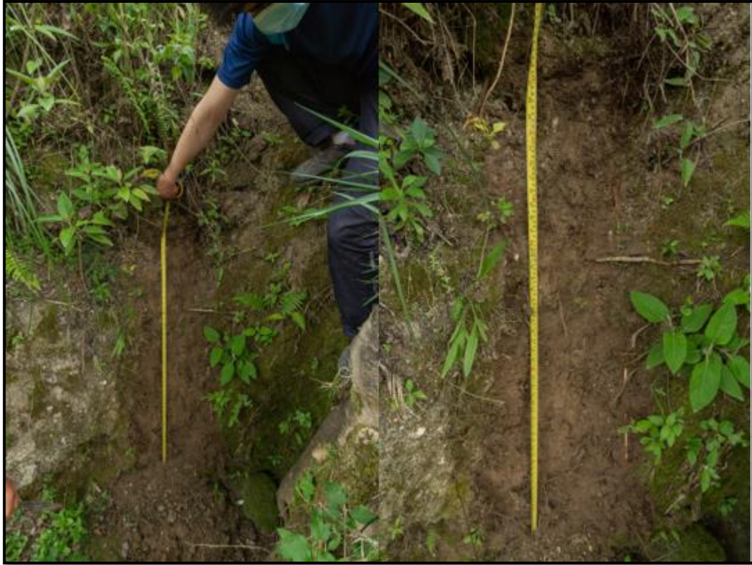
Fotografía 20. Calicata N°1, en talud expuesto: profundidad y material. Progresiva 02+530 km
