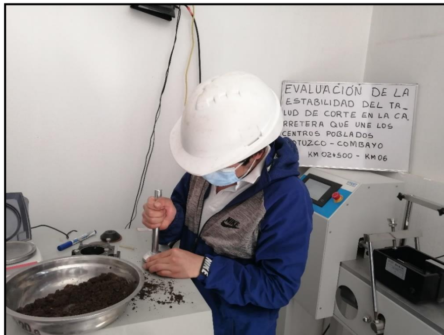
Fotografía 28. Corte Directo: Preparación y ensayo de muestra CD-02
