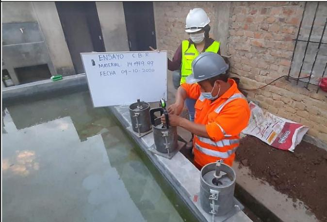
**Fotografía 05.** Ensayo de CBR, Km 14+999.93
