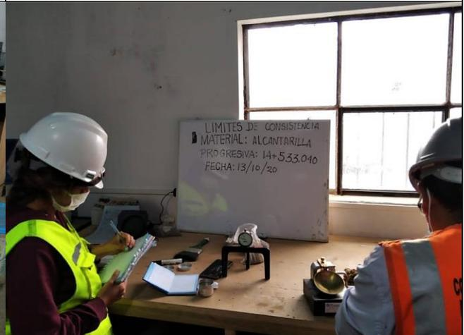
**Fotografía 04.** Ensayo de límites de consistencia, Km 14+533.04
