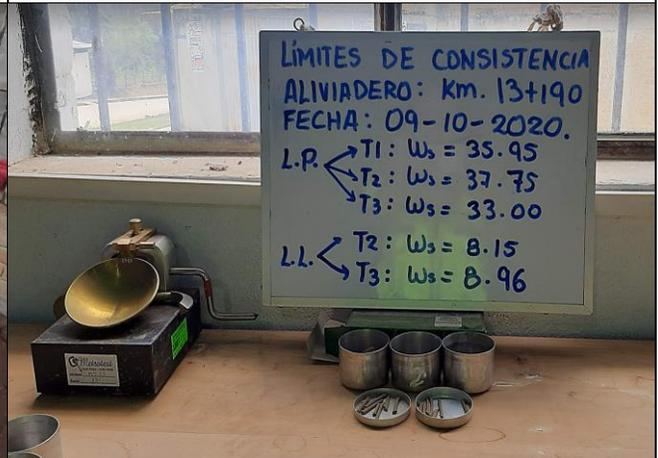
**Fotografía 06.** Ensayo de límites de consistencia, Km 13+190.00
