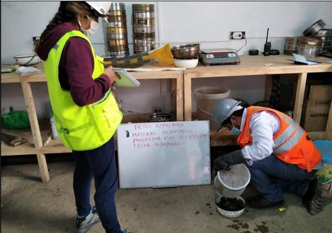
**Fotografía 03.** Ensayo de peso específico, Km 14+533.04
