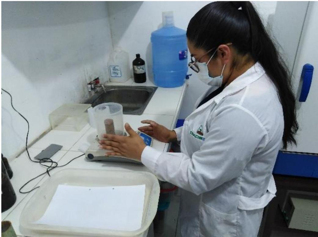
Foto 15: Pesaje de las muestras de suelo en la balanza analítica
