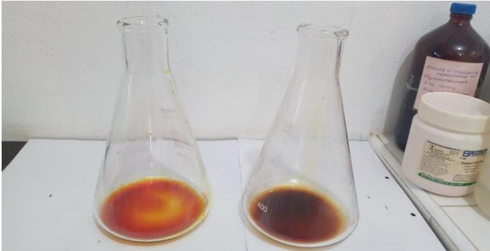
Foto 17: Muestra de suelo sometida a reacción química, donde se muestra la lixiviación del suelo empleado mezcla sulfocrómica
