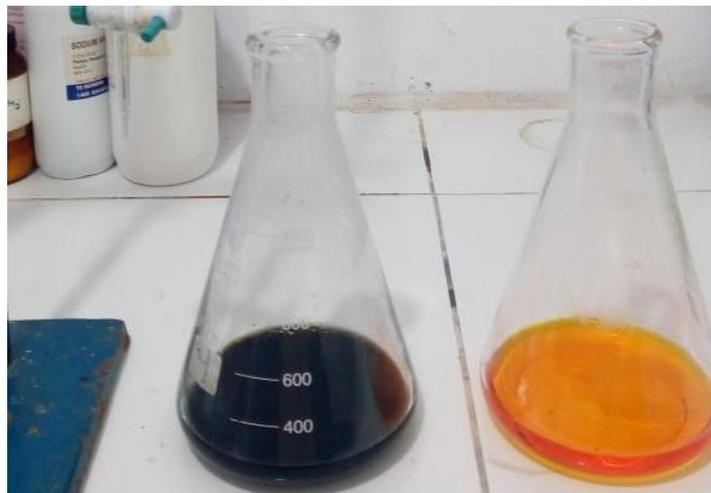
Foto 18: Valoración con sulfato ferroso
