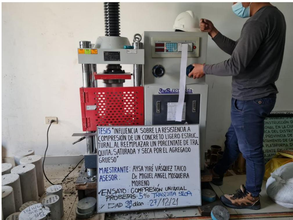
**Figura 29:** Ensayo de Resistencia a compresión a 28 d. para las probetas con 5% de reemplazo de traquita seca.
