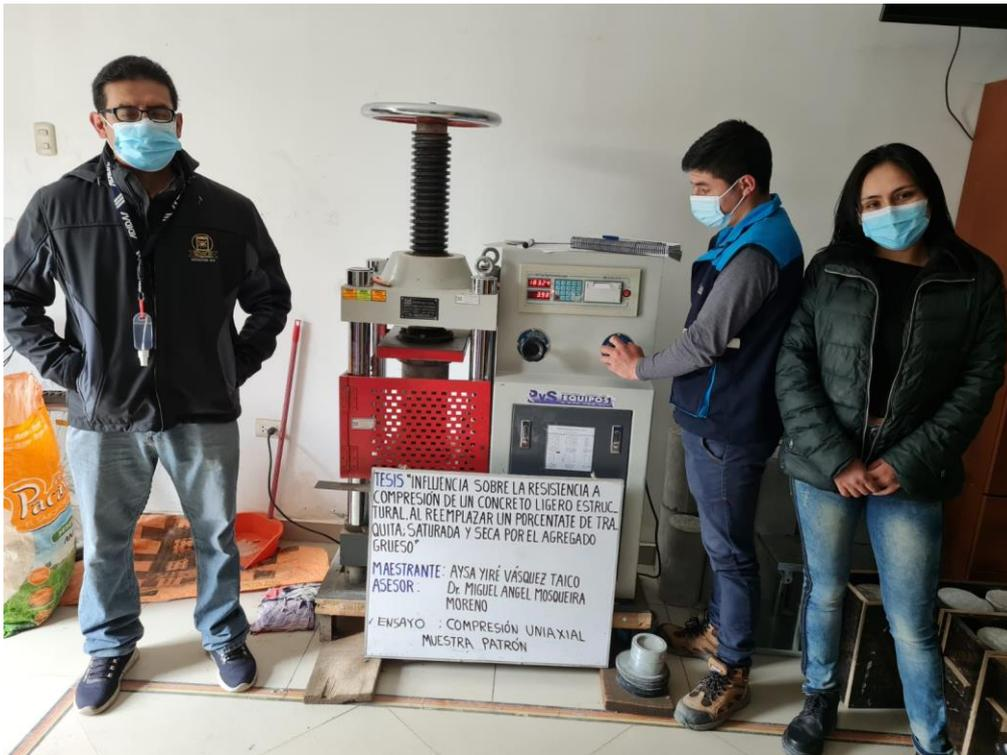
**Figura 26:** *Ensayo de Resistencia a compresión a 7 d. para probetas patrón.*
