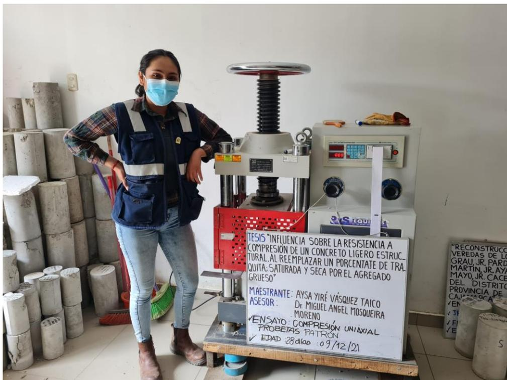
**Figura 27:** *Ensayo de Resistencia a compresión a 28 d. para las probetas patrón.*
