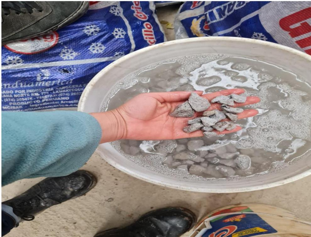
**Figura 20:** Muestra de traquita saturada.
