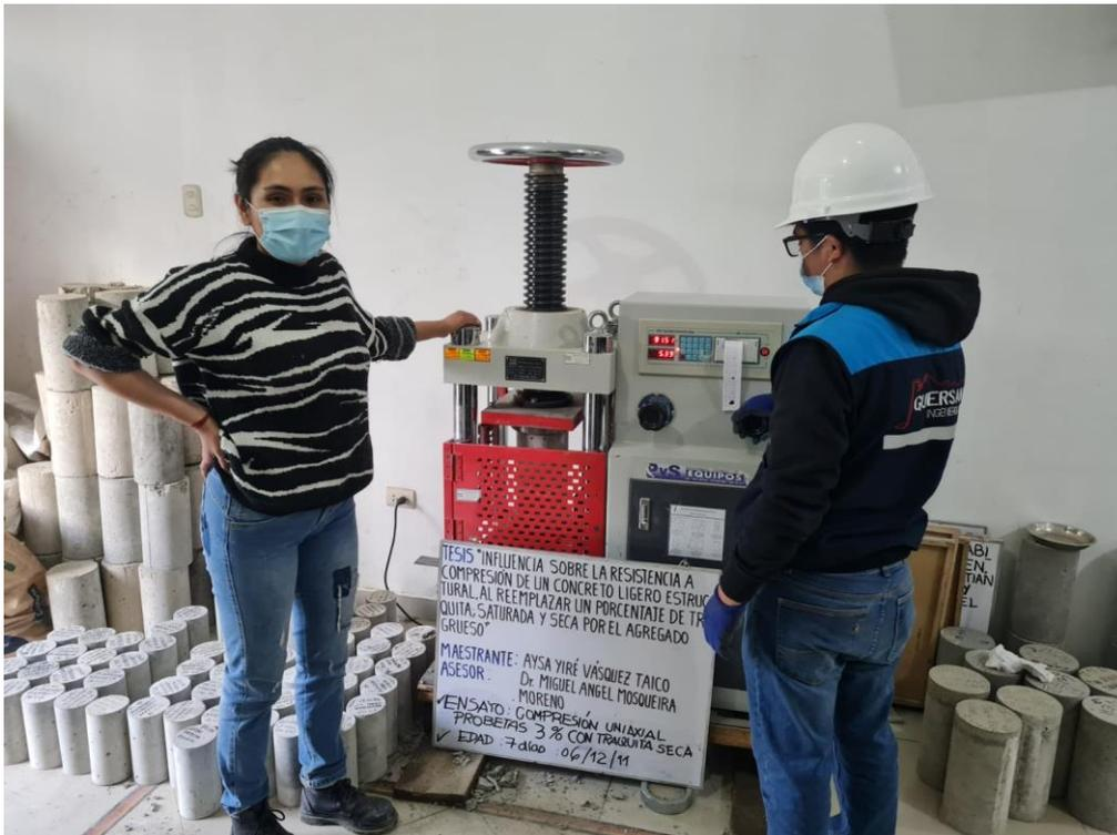
**Figura 28:** Ensayo de Resistencia a compresión a 7 d. para las probetas con 3% de reemplazo de traquita seca.
