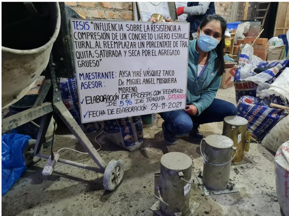
**Figura 23:** *Elaboración de las probetas del tratamiento III*
