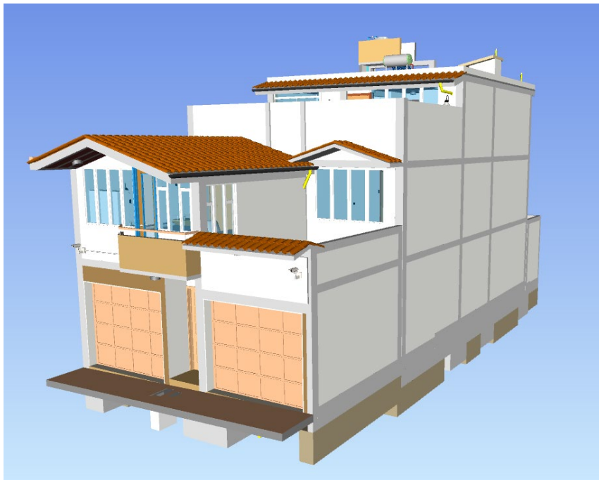
Figura 48. Análisis de interferencias e incompatibilidades del Proyecto HU-03-22 empleando Autodesk Navisworks – 01.
