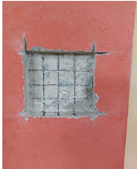
Fotografía 2: Ensayo con esclerómetro en columnas del 1er Nivel
