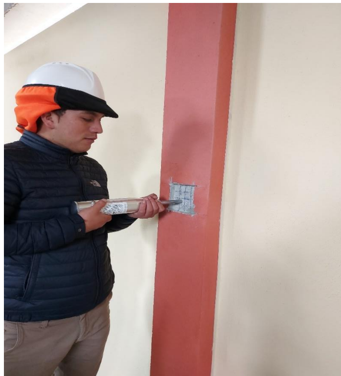
Fotografía 2: Ensayo con esclerómetro en columnas del 1er Nivel
