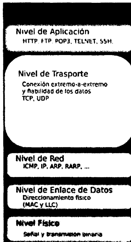
Fig02: Grafico Modelo TCP/IP
