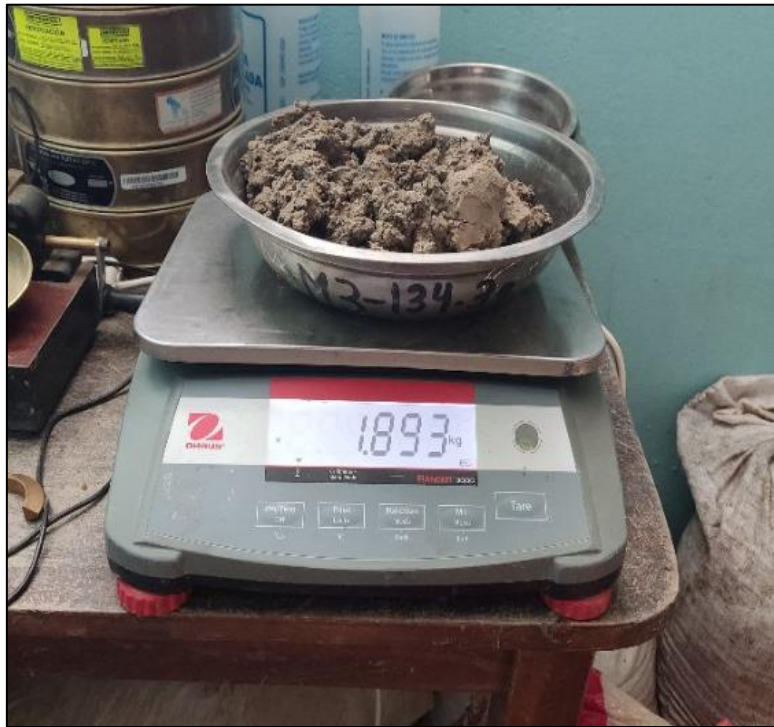
Fotografía 07. Ensayo de contenido de humedad en la calicata C-3.
