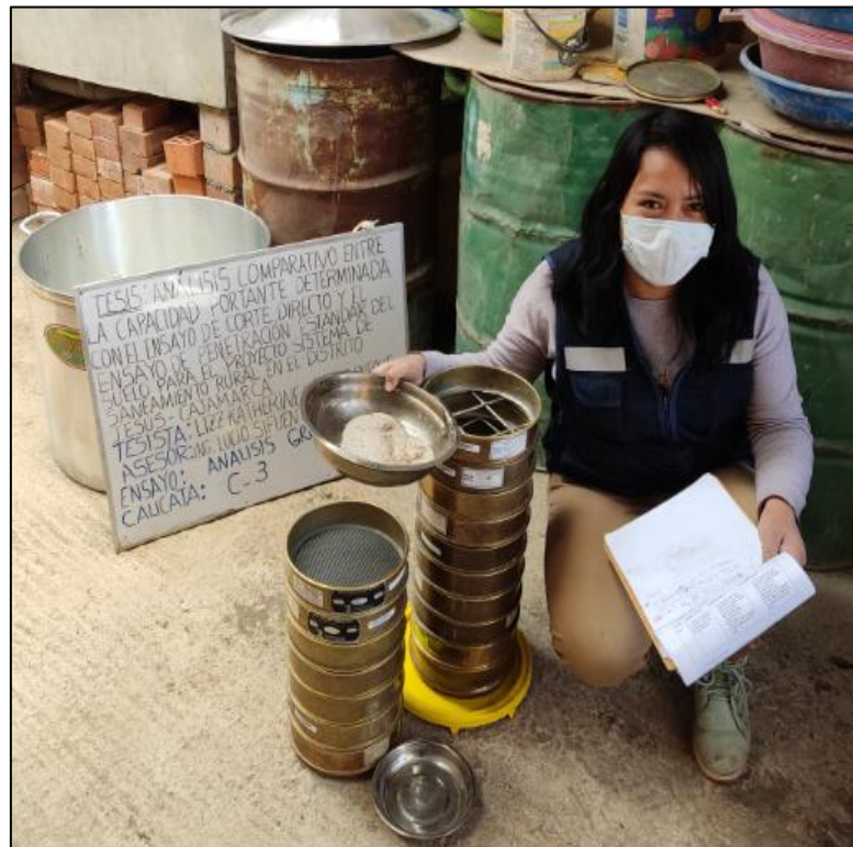
Fotografía 12. Ensayo de granulometría en la calicata C-3.
