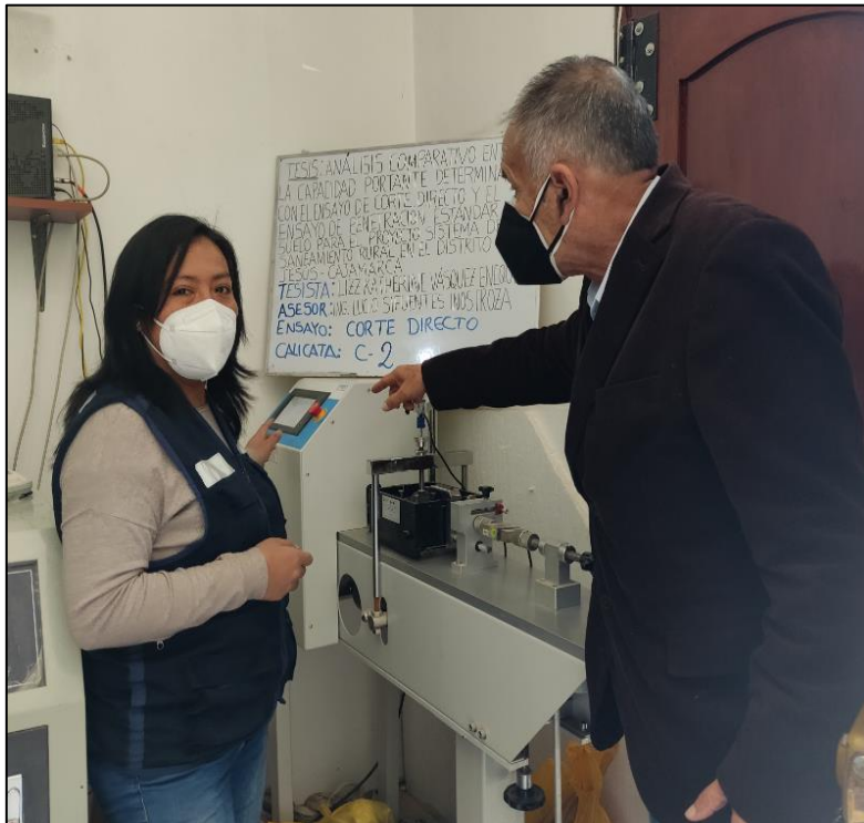
Fotografía 15. Realización del ensayo de corte directo.
