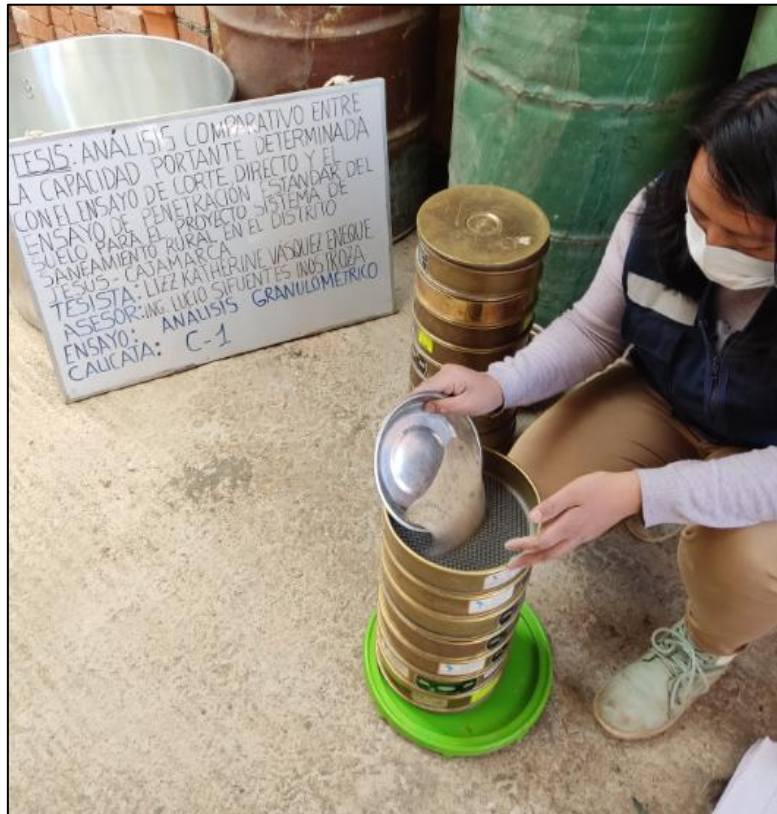
Fotografía 11. Ensayo de granulometría en la calicata C-1.
