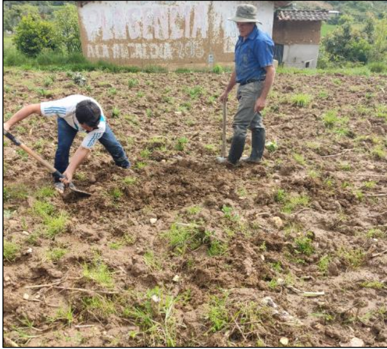
Fotografía 01. Preparación del terreno para excavación de calicatas.
