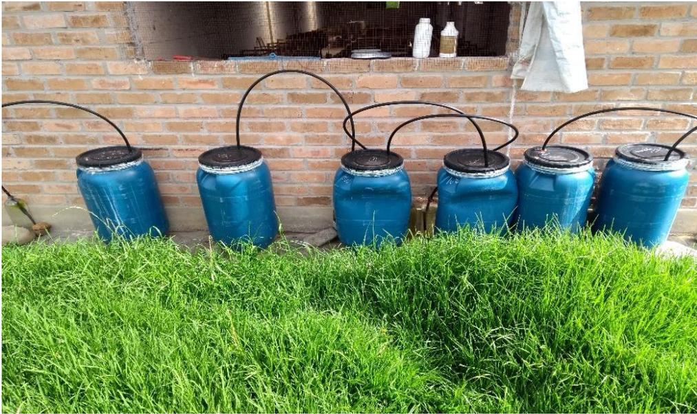
**FOTO 02: Biodigestores.**
