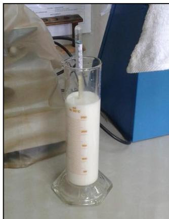
**Figura 15:** Determinación de la densidad de la leche.
