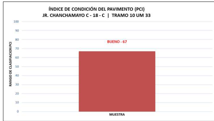
Figura N°106: Índice de Condición del Pavimento (PCI) Tramo 10 UM – 33
