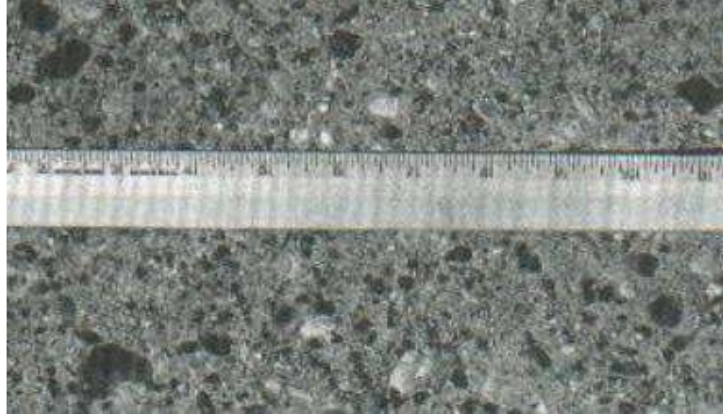
Fotografía N°11: Vista típica de pulimiento de agregados
