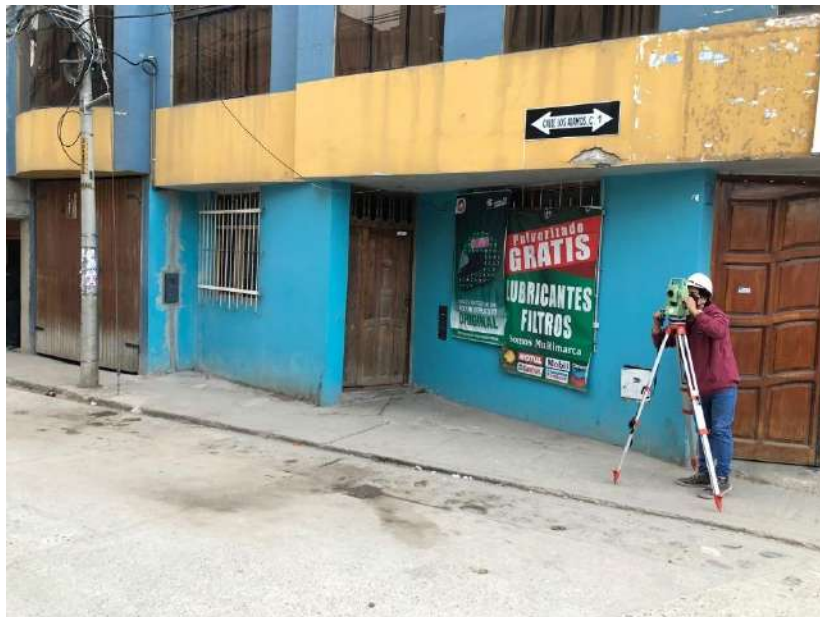
Fotografía N°63:Levantamiento topográfico calle Los Álamos Cuadra 01
