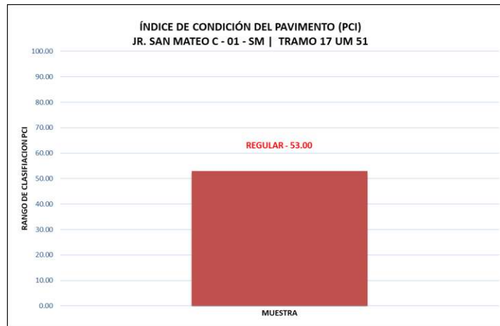
Figura N°142: Índice de Condición del Pavimento (PCI) Tramo 17 UM - 51
