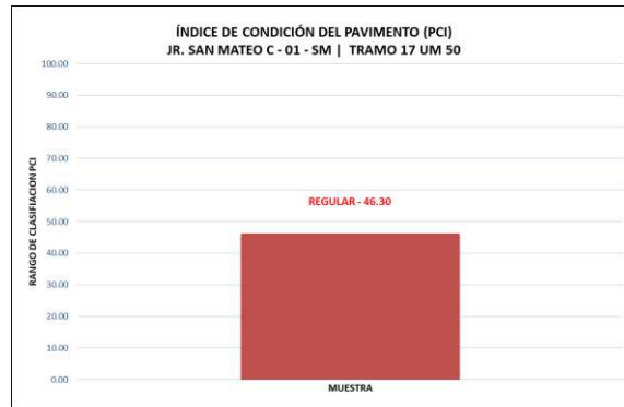
Figura N°140: Índice de Condición del Pavimento (PCI) Tramo 17 UM - 50
