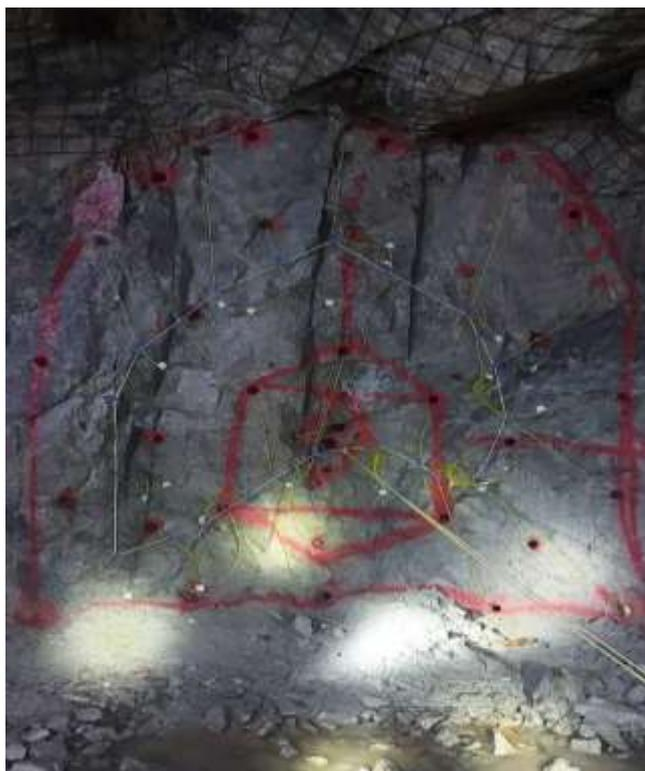
Fotografía 10: Frente cargado en la Cámara 1 – nivel 3175 MARSA
