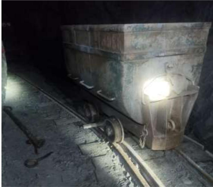
Fotografía 8: Uso de carros U 35 para limpieza de carga de material fragmentado ya sea mineral o desmonte
