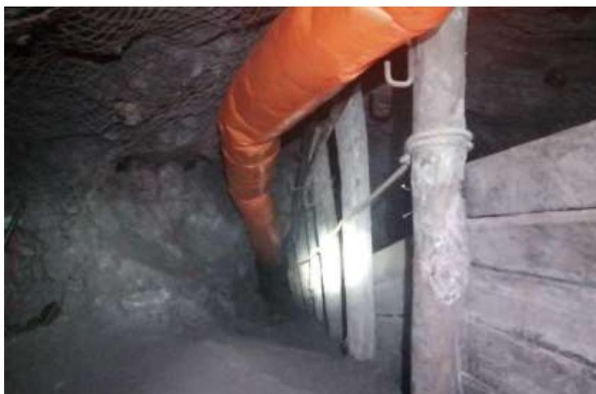
Fotografía 6: Uso de mangas de ventilación de labores horizontales
