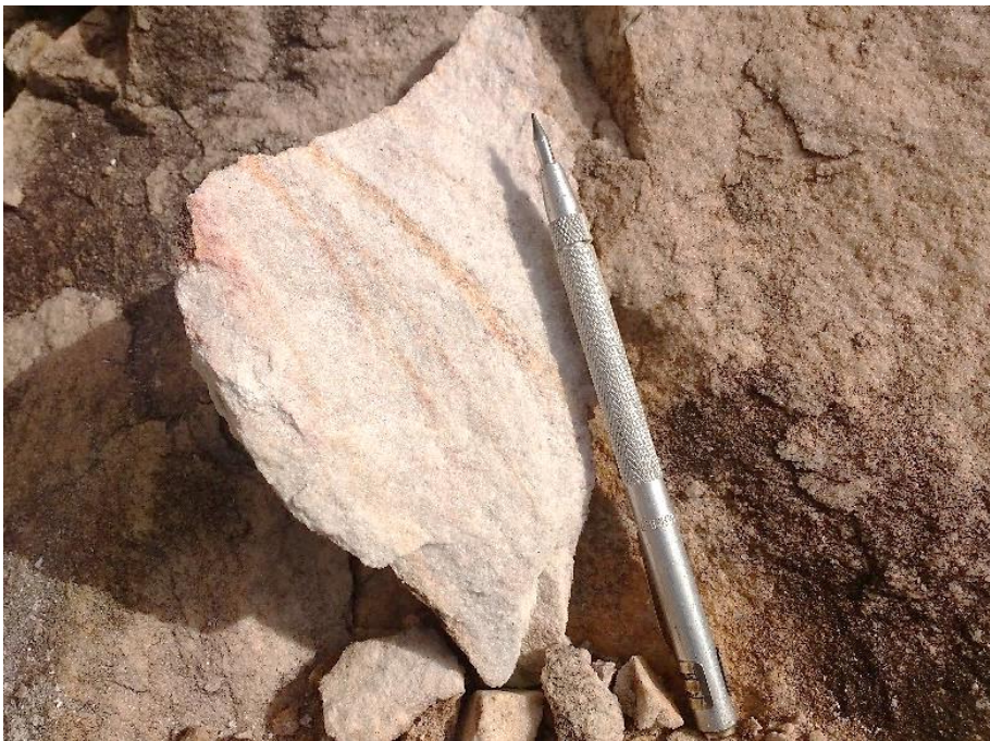
Figura 18. Clastos de cuarzo mayores a 2mm. en arenisca cuarzosa de la F. Farrat
