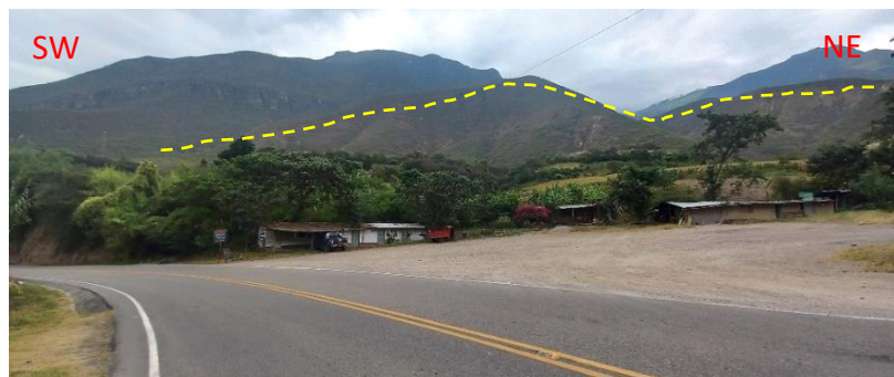
Figura 59. Loma estructural kárstico de dirección NW-SE ubicado al W del Caserío Huaquillas
