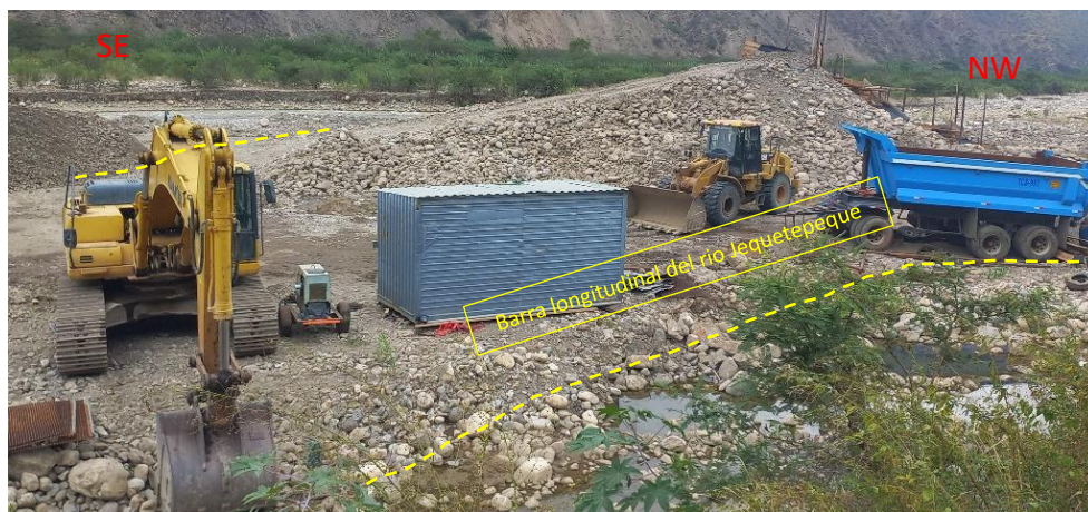
Figura 75. Explotación de materiales de construcción en una de las barras longitudinales ubicadas en el margen derecho aguas abajo del río Jequetepeque
