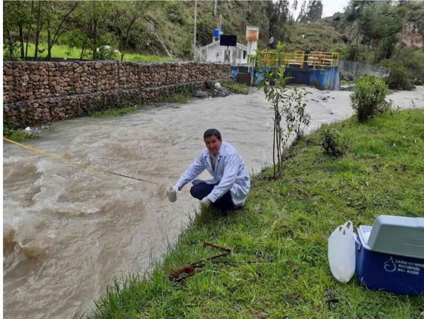
Figura 8. Toma de muestras agua pre tratada del río Grande (RGAM).
