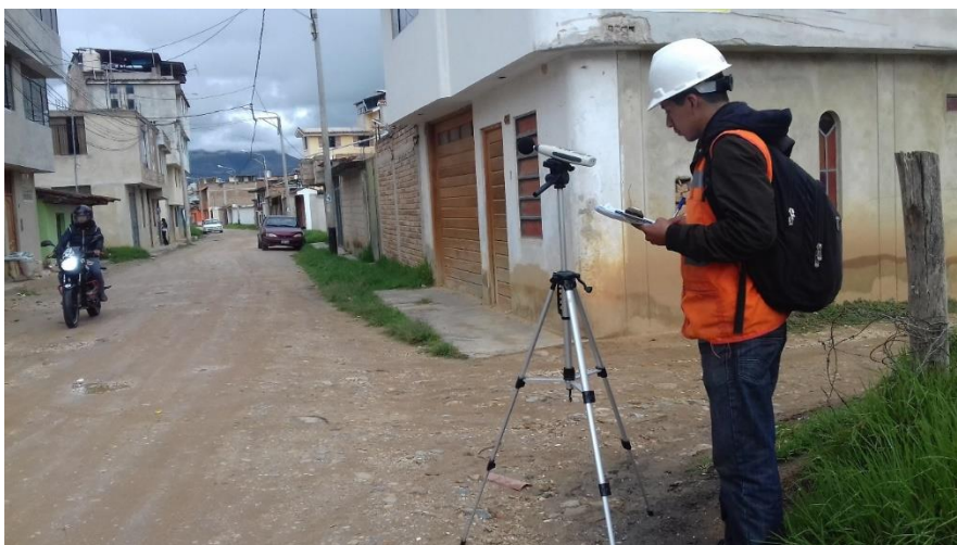
Foto 21. Medición de ruidos y control de vehículos, turno mañana en el PC 29 (21-02-2019)
