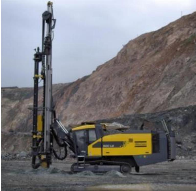
Figura N° 11: Perforadora Roc L8-30. (Minera Yanacocha, 2020)
