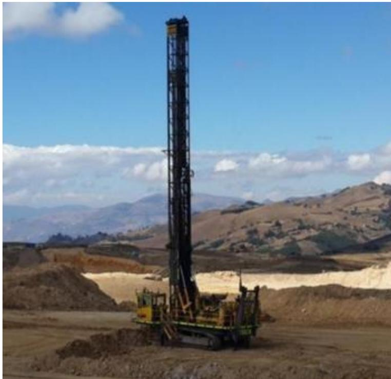
Figura N° 12: Perforadoras Pit Viper 271. (Minera Yanacocha, 2020)
