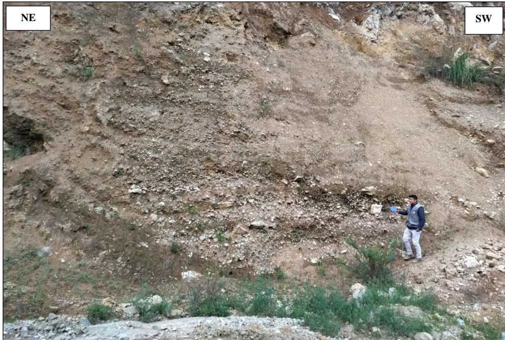
Foto 10: Depósito del tipo aluvial constituido principalmente por lentes de gravas en una matriz de limos y arcilla en la progresiva km 07 + 170. Coordenadas: E 787263, N 9216263.
