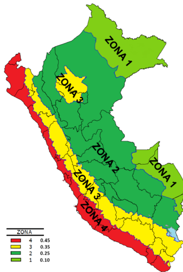
Figura 09: División del territorio nacional en cuatro zonas de acuerdo a la Norma E.030. Diseño Sismo-Resistente del Reglamento Nacional de Edificaciones. (Ministerio de Vivienda, Construcción y Saneamiento, 2018).
