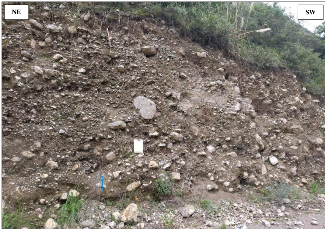
Foto 09: Depósito coluvio – aluvial constituido por fragmentos angulares heterométricos en una matriz de limos y arcillas en la progresiva km 05 + 960. Coordenadas: E 786821, N 9215279.
