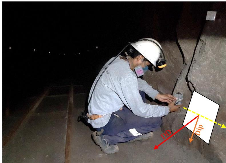
Figura 43. Nota. Medición de Dip y DD en familias de discontinuidades de la Estación Geomecánica N°2 con brújula Brunton azimutal.
