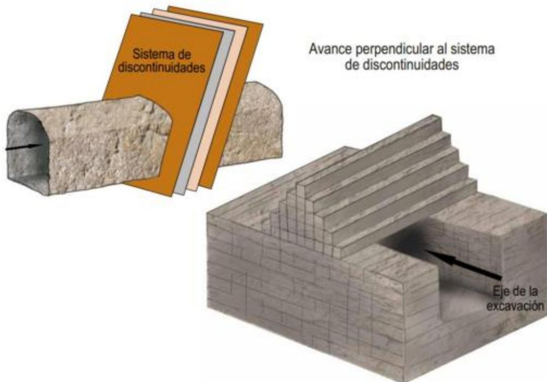
Figura 7. Condiciones de avance muy favorables para la estabilidad. (SNMPE, 2004).
