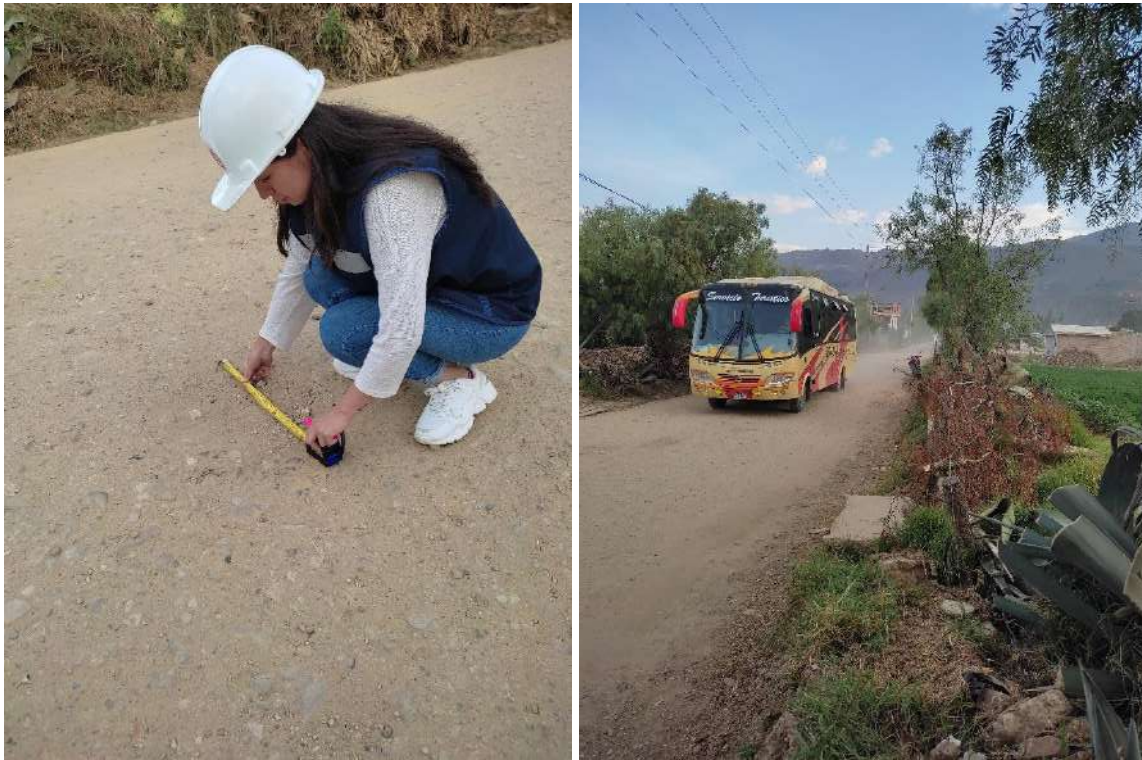
Fotografía 9 Toma de datos de fallas presentes en una unidad muestral para el método URCI
