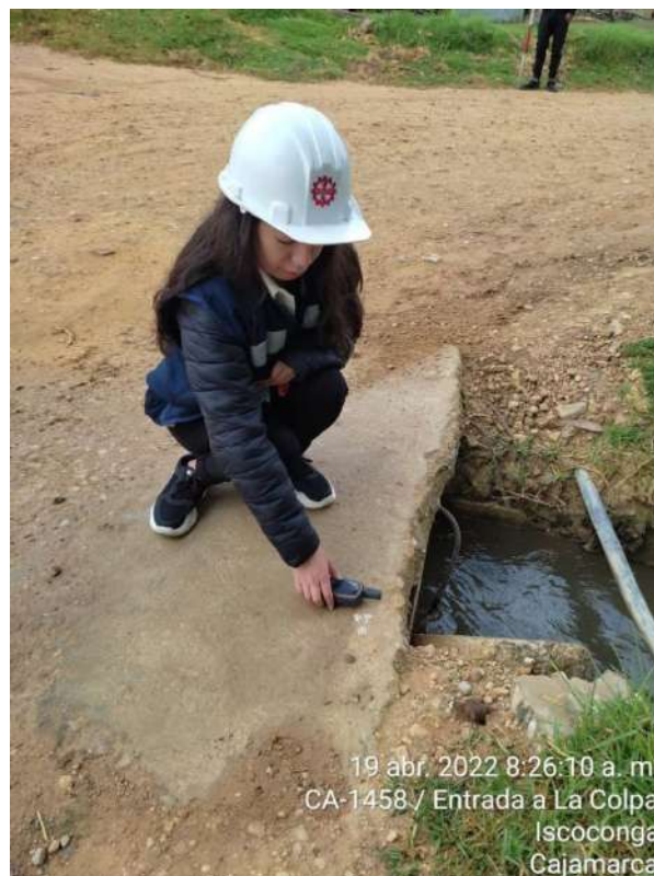
Fotografía 4 Levantamiento topográfico: Toma de coordenadas de BM para orientación de la estación
