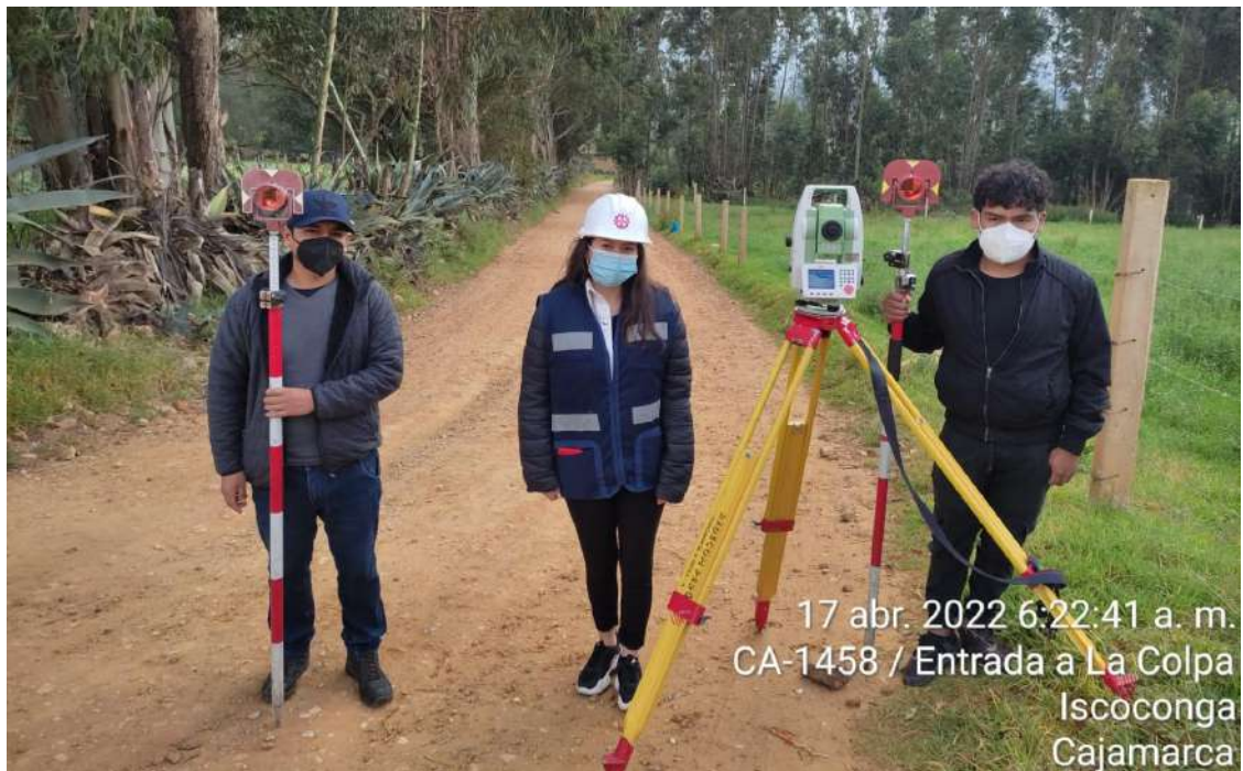
Fotografía 1 Instrumentos utilizados para el levantamiento topográfico de la carretera Huacariz San Antonio - La Colpa
