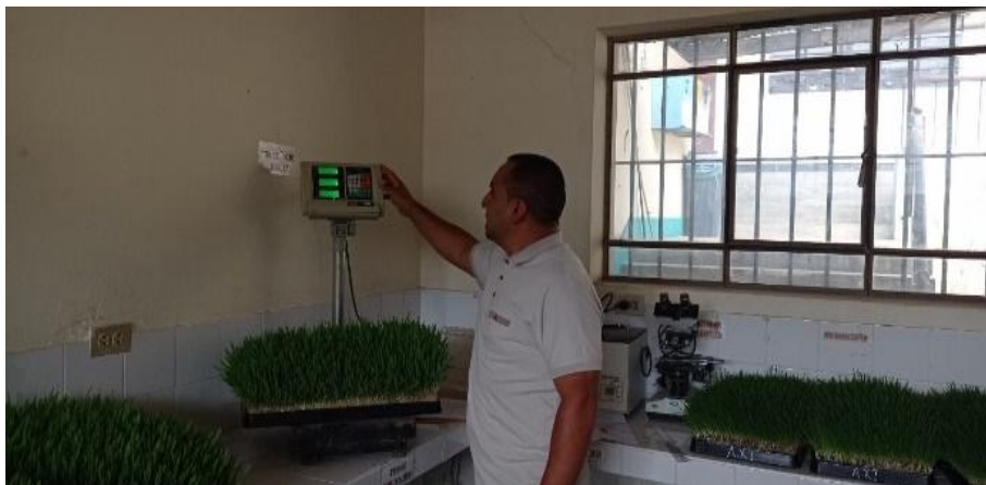
Imagen 28; Pesado de Forraje Verde Hidropónico en el laboratorio del CEFOP San Miguel.
