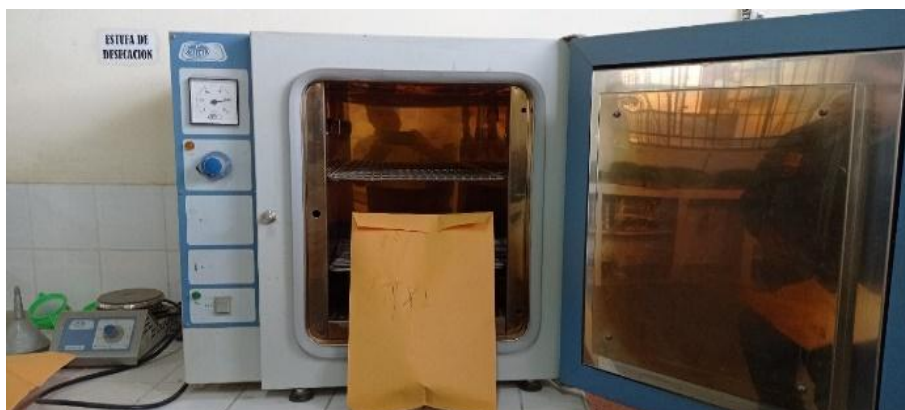
Imagen 33; Pesado después de sacado de la estufa para el cálculo de materia seca de forraje verde hidropónico.
