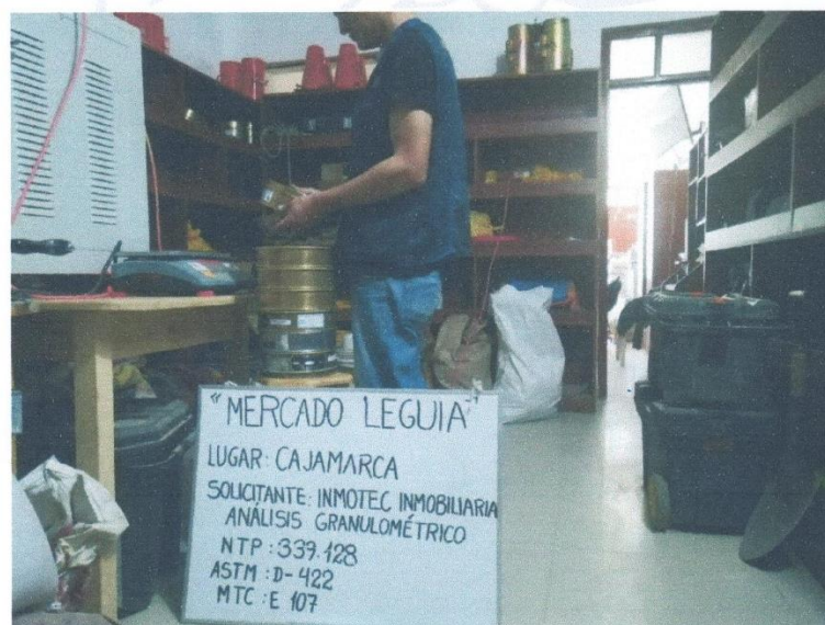
Fotografía N° 10: Ensayo de Análisis Granulométrico.
