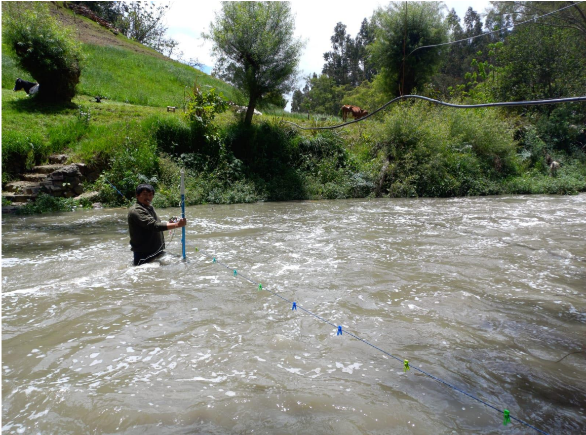
Figura 46. Aforo en la sección N°5 del día 26/12/2022, Q= 6.585\text{m}^3/\text{s} y n= 0.053
