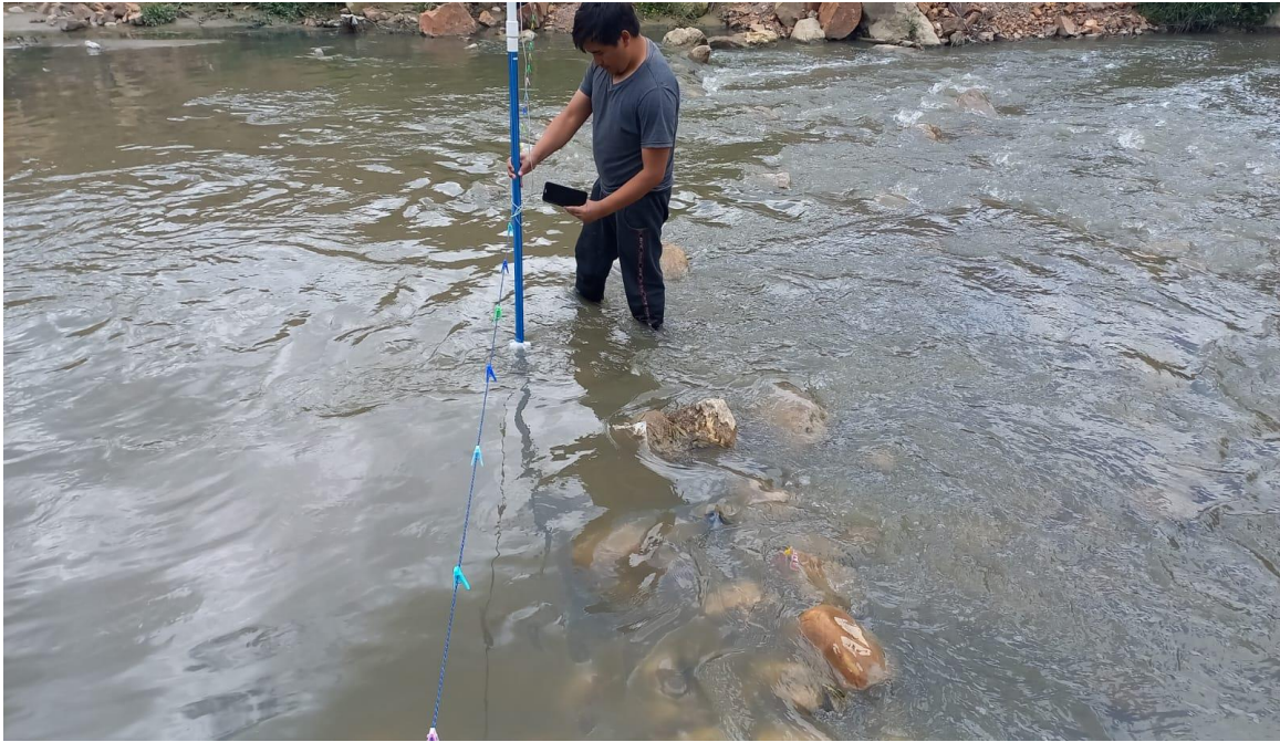
Figura 41. Aforo en la sección N°7 del día 21/09/2022, Q= 1.005\text{m}^3/\text{s} y n= 0.067
