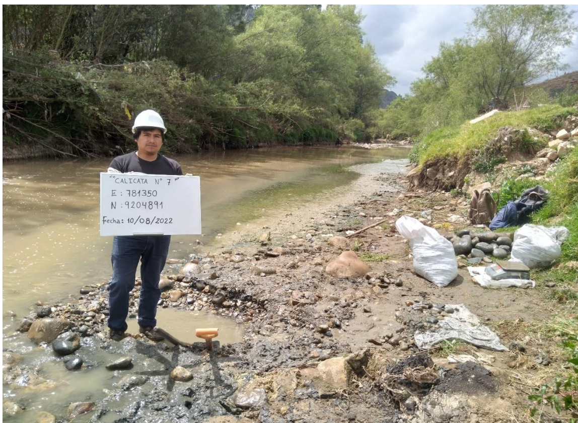
Figura 49. Muestreo de sedimentos en el punto N°7
