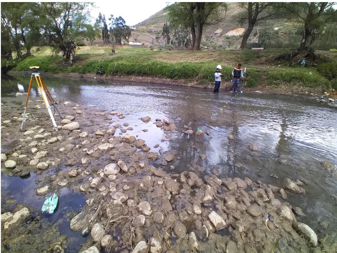
Figura 40. Aforo en la sección N°6 del día 17/07/2022, Q= 0.278m 3 /s y n= 0.096
