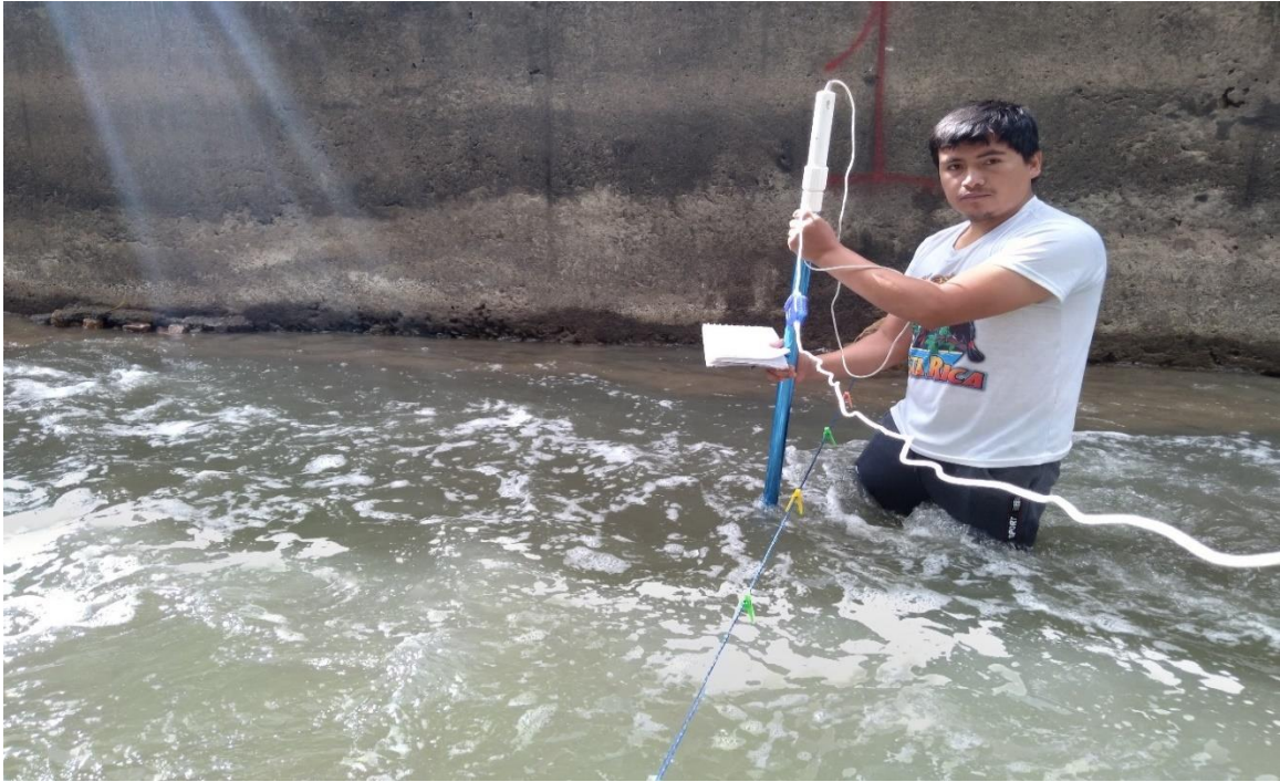
Figura 36. Aforo en la sección N°2 del día 25/07/2022, Q= 0.576\text{m}^3/\text{s} y n= 0.081
