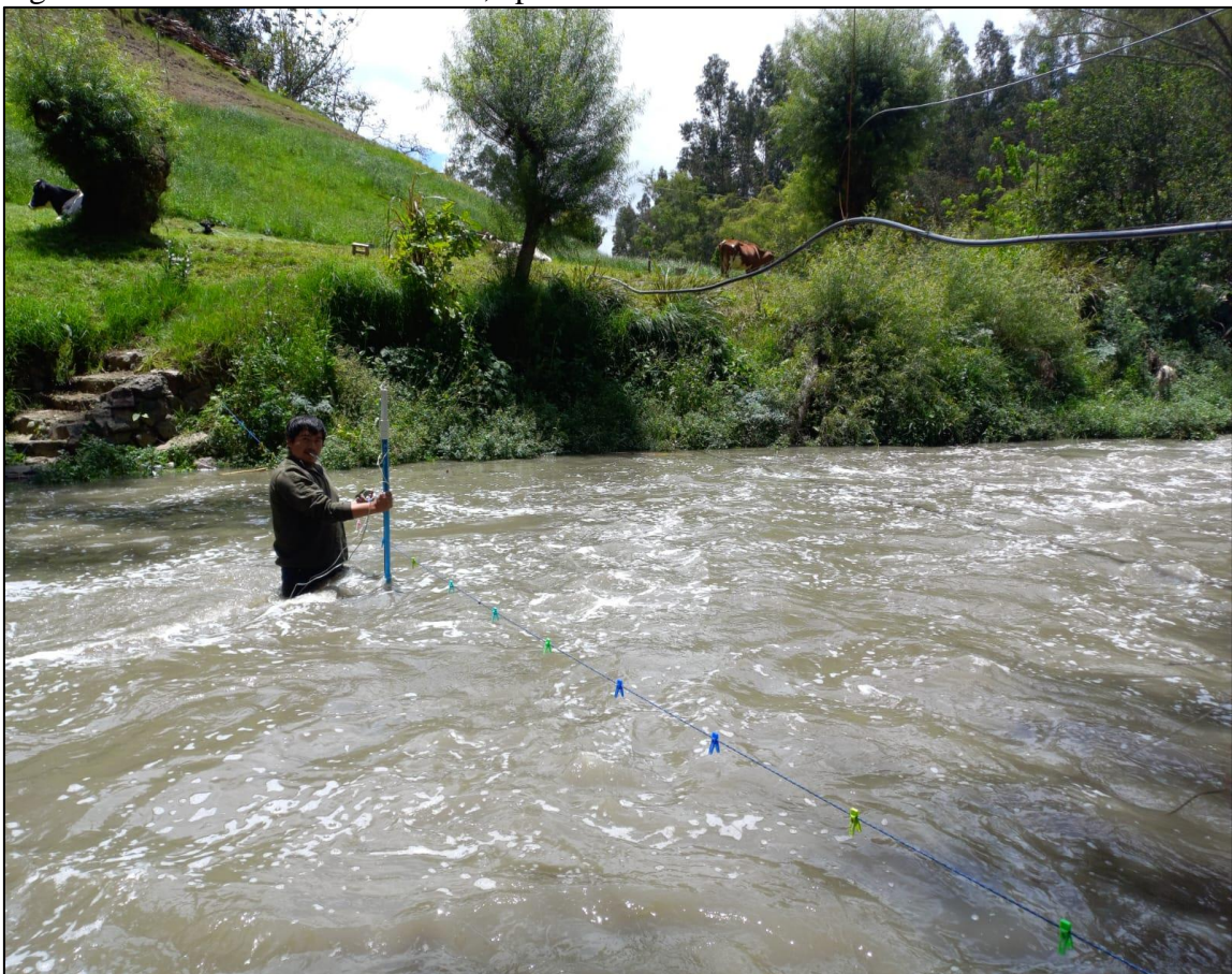
Figura 33. Aforo en la sección N°4, época de lluvias
