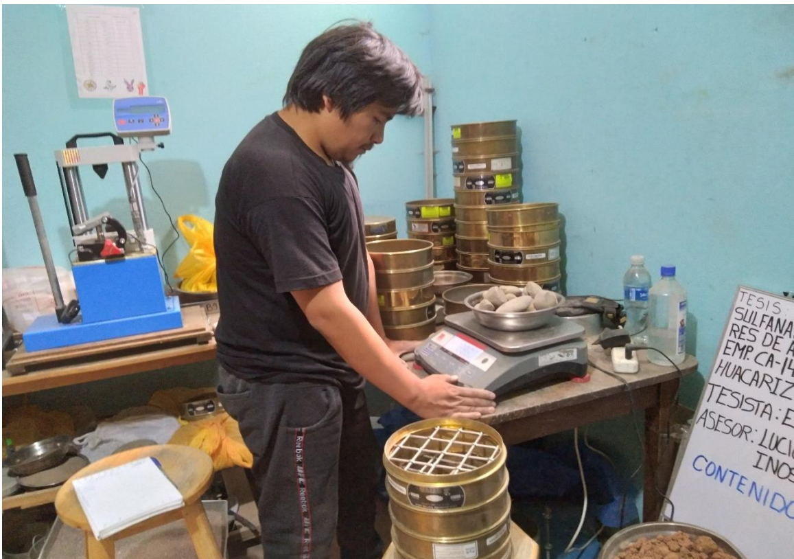
Figura 58. pesado de la muestra en el laboratorio.
