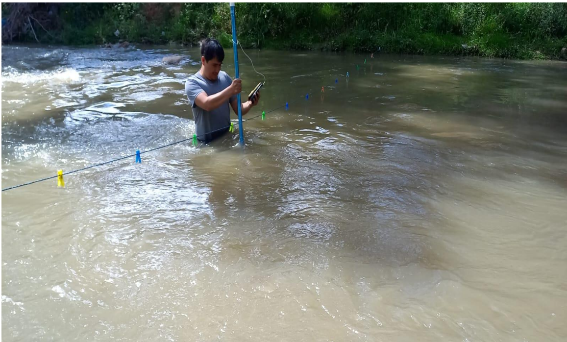
Figura 46. Aforo en la sección N°5 del día 26/12/2022, Q= 6.585\text{m}^3/\text{s} y n= 0.053
