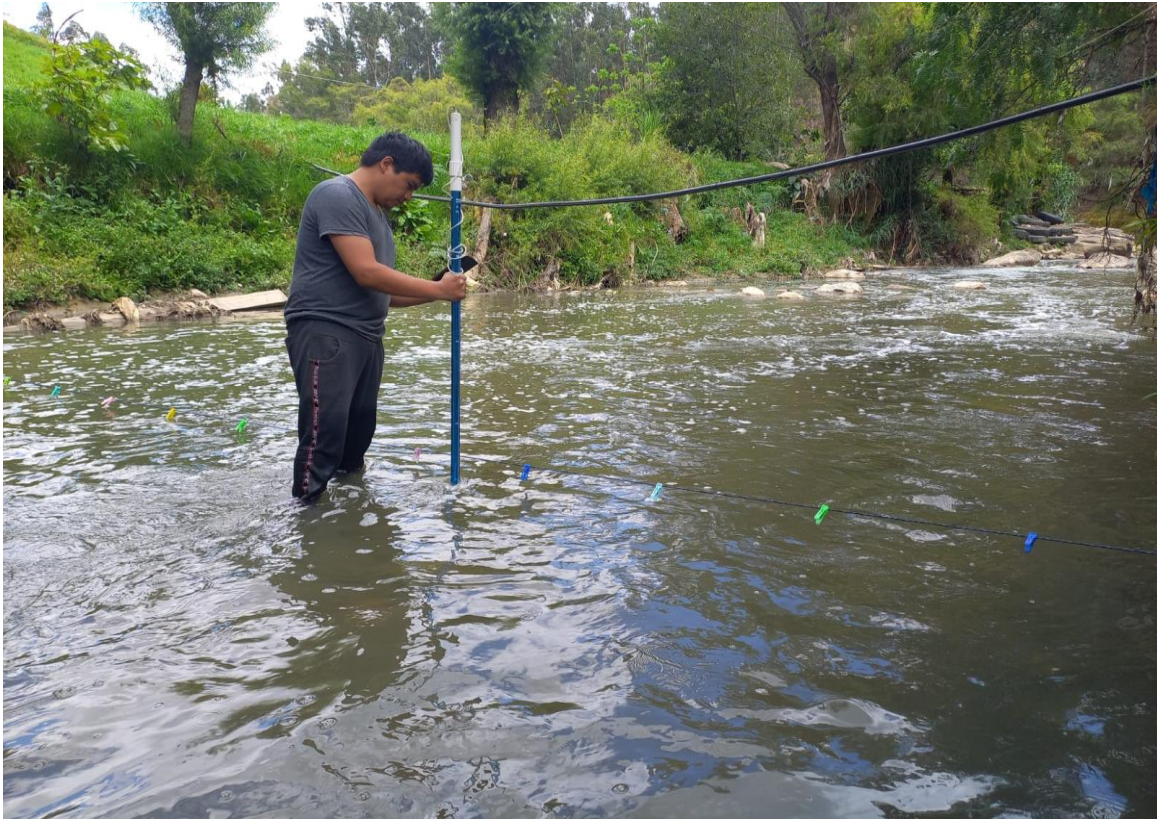
Figura 38. Aforo en la sección N°4 del día 17/07/2022, Q= 0.266\text{m}^3/\text{s} y n= 0.097
