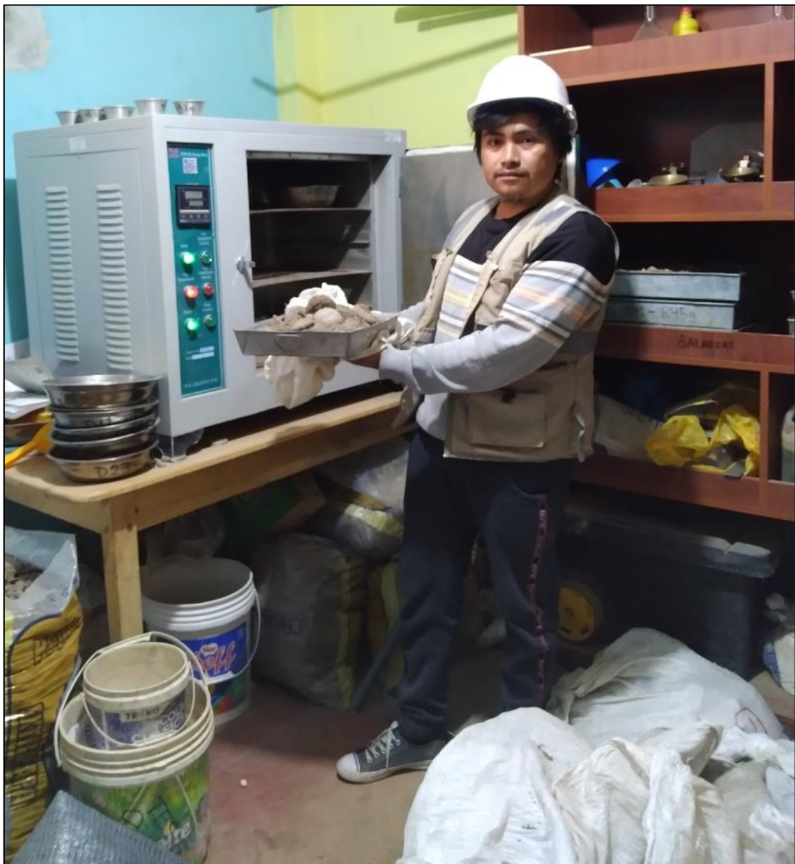
Figura 32. Secado de la muestra granulométrica de los sedimentos del río
