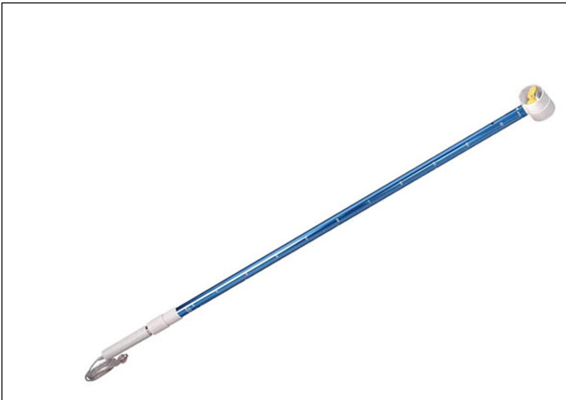
Figura 15. Sensor de caudal / temperatura PASCO PASPort (PS-2130)
