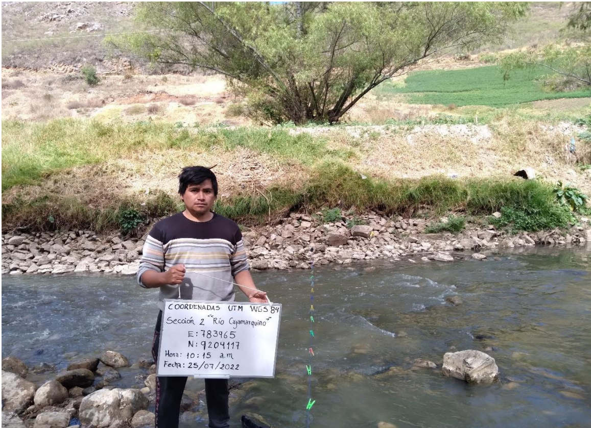
Figura 36. Aforo en la sección N°2 del día 25/07/2022, Q= 0.576\text{m}^3/\text{s} y n= 0.081
