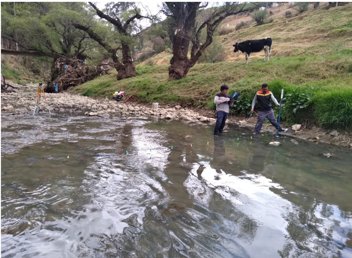
Figura 38. Aforo en la sección N°4 del día 17/07/2022, Q= 0.266\text{m}^3/\text{s} y n= 0.097
