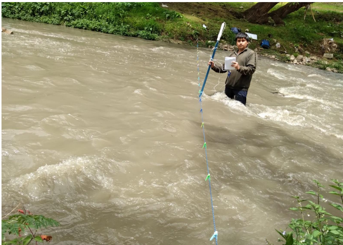
Figura 44. Aforo en la sección N°2 del día 25/10/2022, Q= 4.027\text{m}^3/\text{s} y n= 0.057
