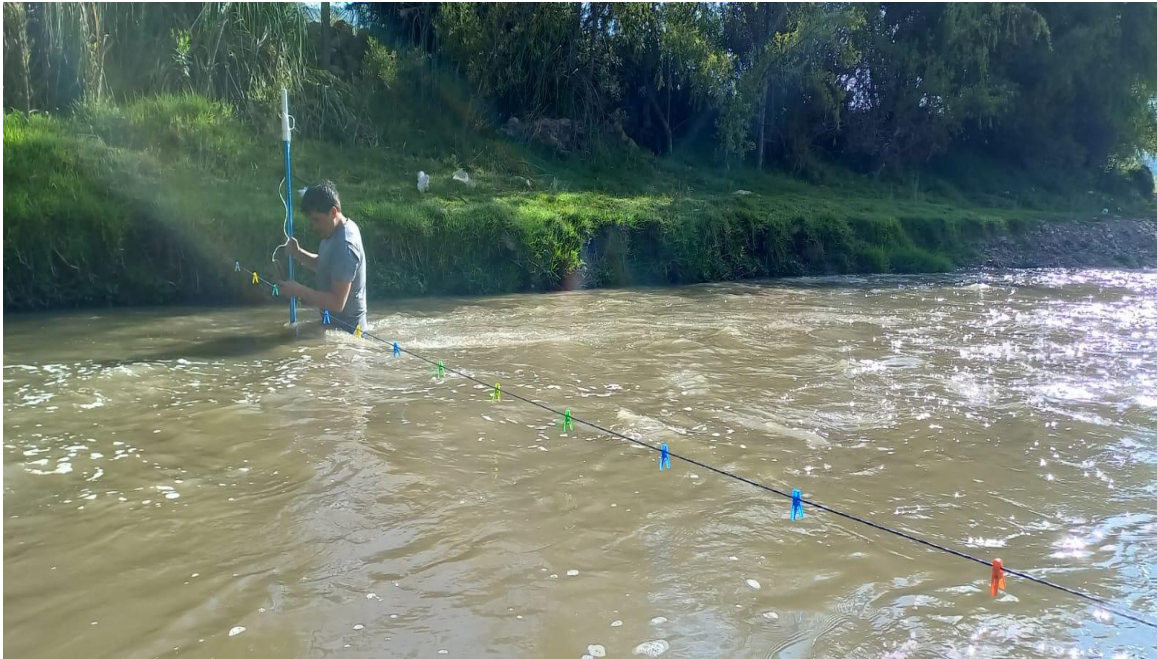
Figura 47. Aforo en la sección N°8 del día 12/01/2023, Q= 8.83\text{m}^3/\text{s} y n= 0.035
