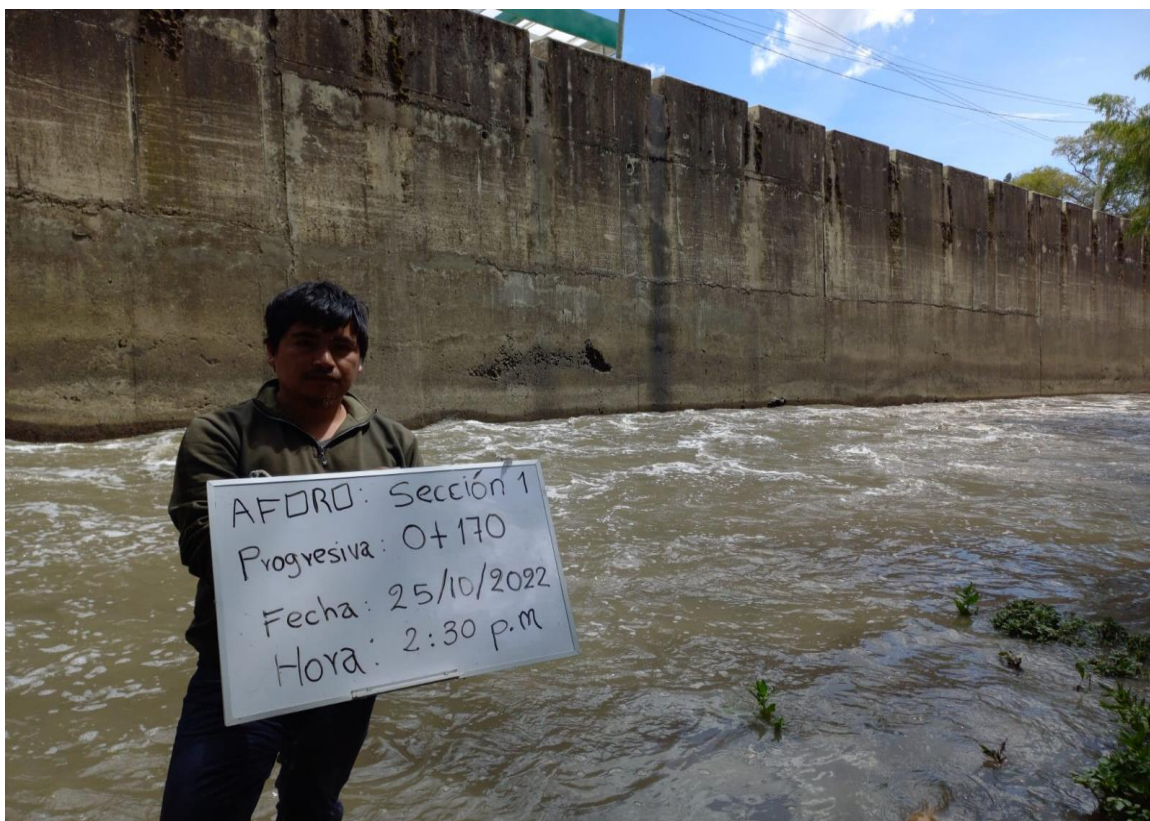
Figura 43. Aforo en la sección N°1 del día 25/10/2022, Q= 4.049\text{m}^3/\text{s} y n= 0.080
