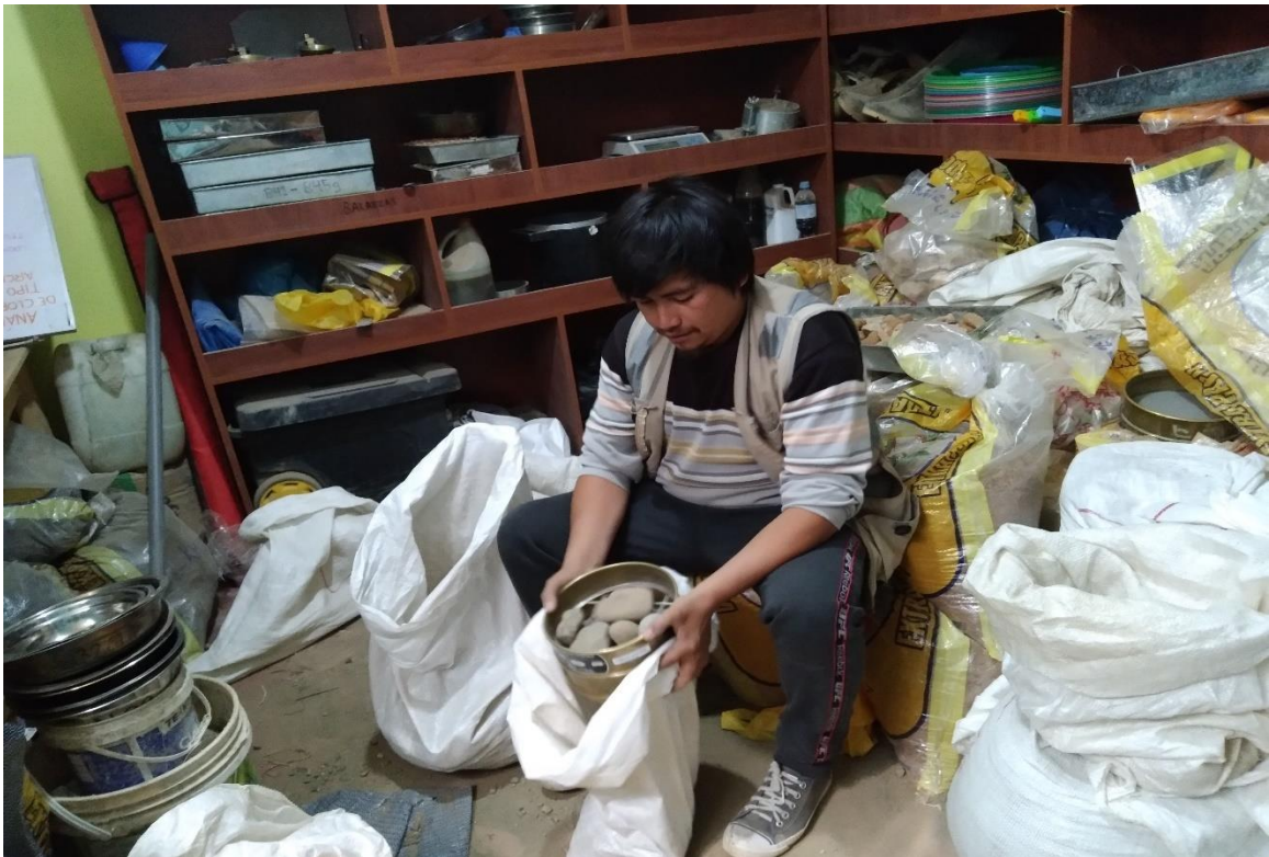
Figura 57. Tamizado de la muestra de sedimentos del río
