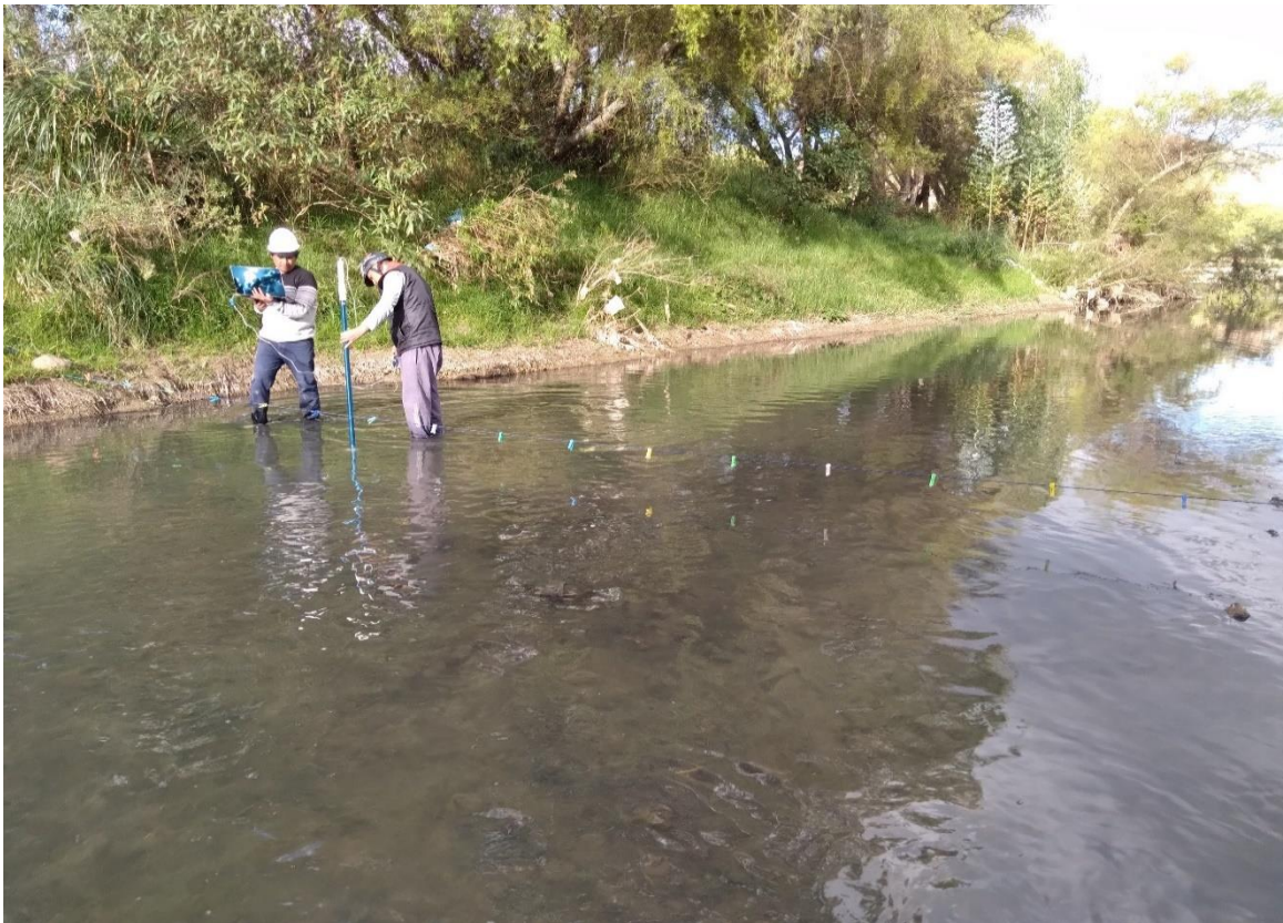
Figura 42. Aforo en la sección N°8 del día 13/08/2022, Q= 0.741\text{m}^3/\text{s} y n= 0.054
