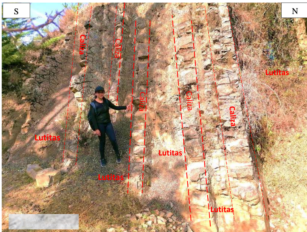
Figura 4.13. Intercalación de calizas (Espesor: 0.20 m. a 0.25 m.) y lutitas de espesor: 0.35 m. a 0.50 m., de colocación bituminosa de textura fisil.
