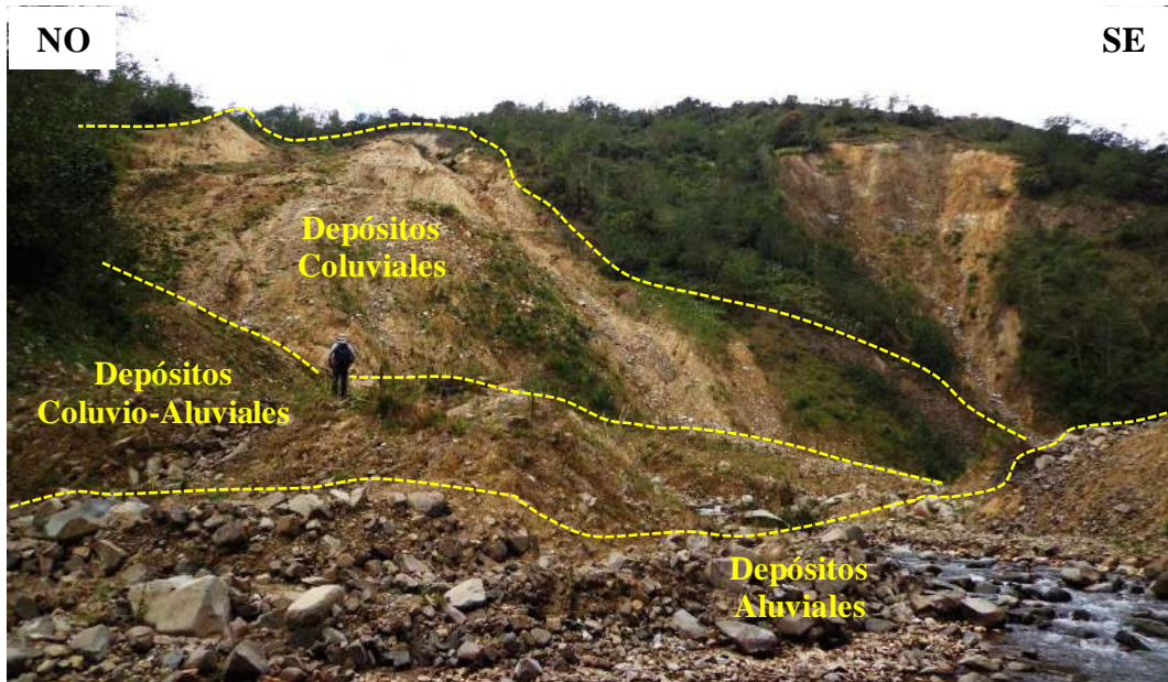
Foto 2. Depósitos Coluviales, Coluvio-Aluviales y Aluviales en la zona de estudio. Ubicación E:805583 N: 922623 C: 3123 msnm.
