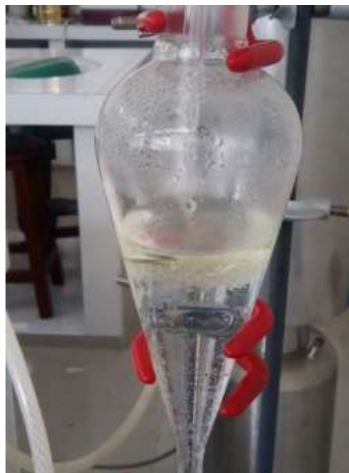
Figura 4. Obtención de aceite esencial de romero.
