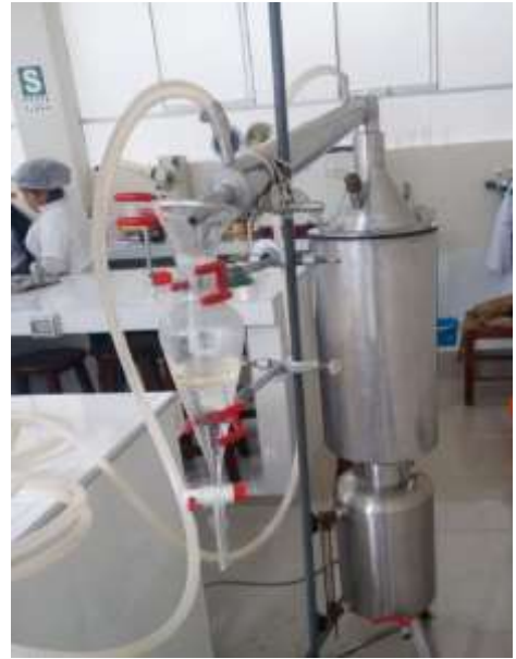
Figura 3. Sistema de extracción de aceite esencial por destilación por arrastre de vapor.
