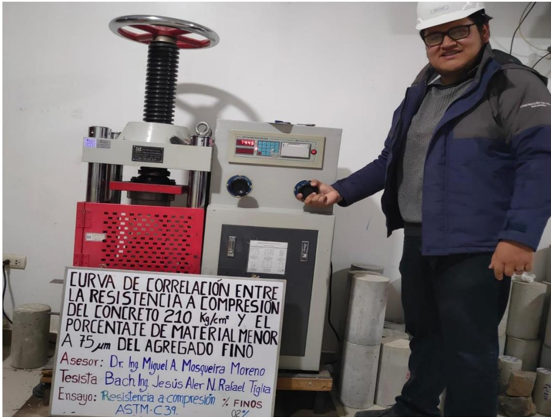
Fotografía 08. Tesisista y asesor durante la ruptura de testigos de concreto.
