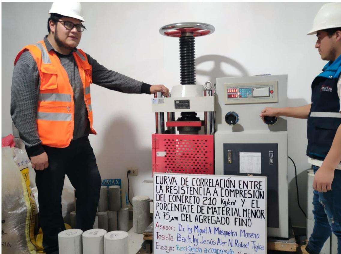
**Fotografía 07.** Tesista ensayando resistencia a compresión de concreto.
