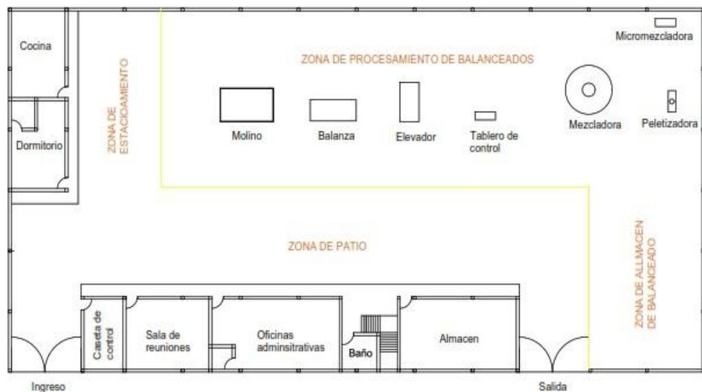
En la zona de procesamiento, se dispondrá con áreas adecuadamente distribuidas para el pesado de materias primas, molienda, mezclado y ensacado de concentrado.
