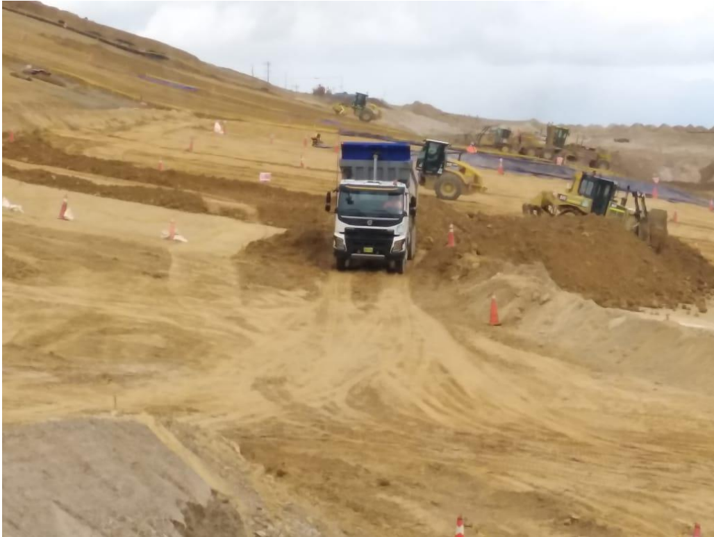
Figura 45. Volquete de 15 m 3 usado para el acarreo del mineral de lixiviación
