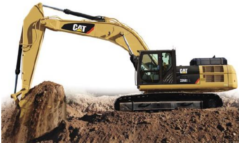
Figura 1. Excavadora Caterpillar 336 D2L
