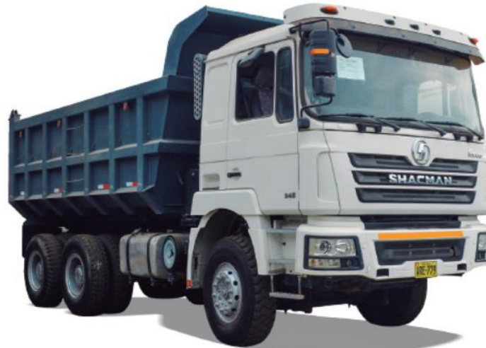
Figura 6. Camión volquete de 15 m 3 de capacidad
