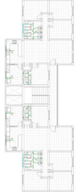
DESAGÜE SEGUNDO PISO - VIVIENDA Esc.1 : 360
