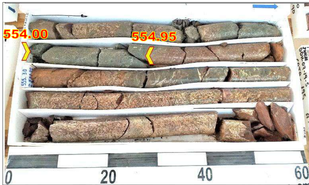
Figura 45. Brecha con clastos de cuarzo, calcita, epidota, clorita, asociado a fallamiento.
