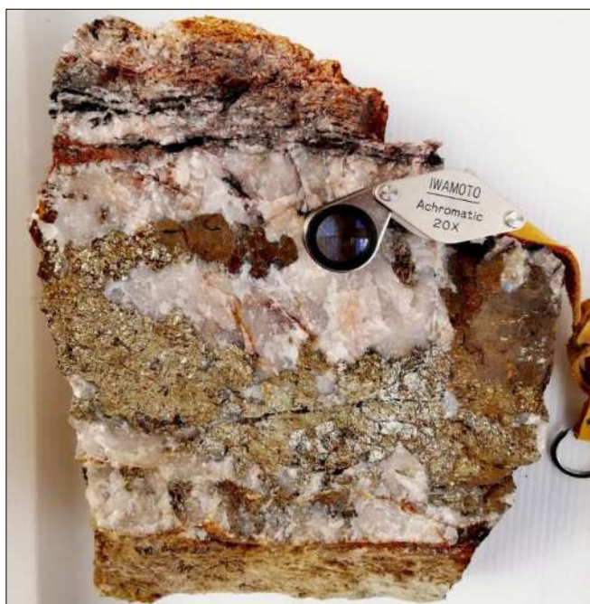
Figura 20. Vista de mineralización presente de cuarzo hialino, cuarzo gris, pirita, calcopirita esporádica y mineral secundario óxidos de hierro (hematita y limonita).
