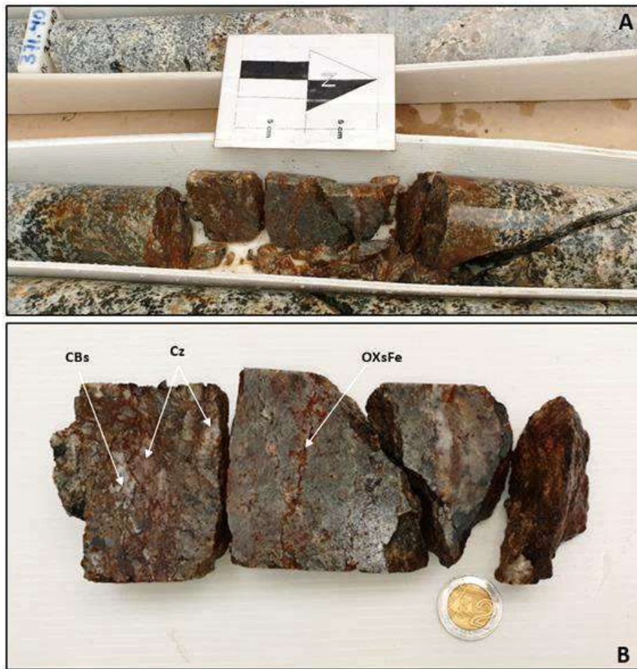
Figura 40. Veta Lucas. De 395.23 a 395.41m (0.18m) brecha de cuarzo, arcillas, carbonatos, óxidos de hierro. Los análisis de laboratorio han reportado valores de 0.183gr/tm Au y 0.30gr/tm Ag para 0.18 m de ancho.
