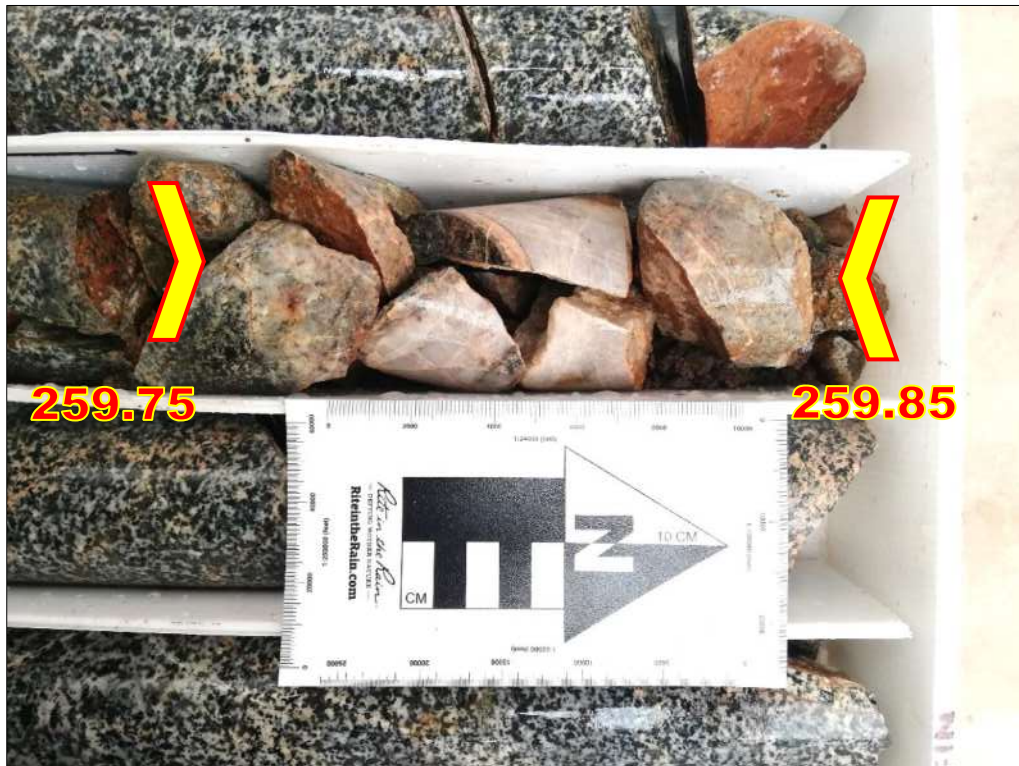
Figura 43. Veta: Cuarzo, carbonatos, arcillas verdes y diorita alterada por fallamiento.
