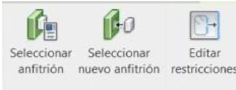
*Figura N° 47. Opciones para signar o determinar el anfitrión del acero modelado en Autodesk Revit*
