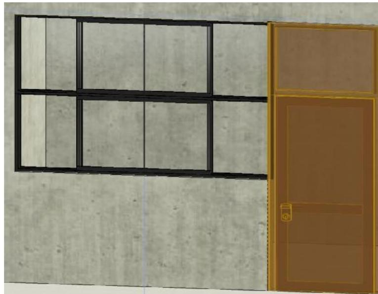
Figura N° 129. Vista 3D de la interferencia entre puerta y ventana – Incidencia 6
