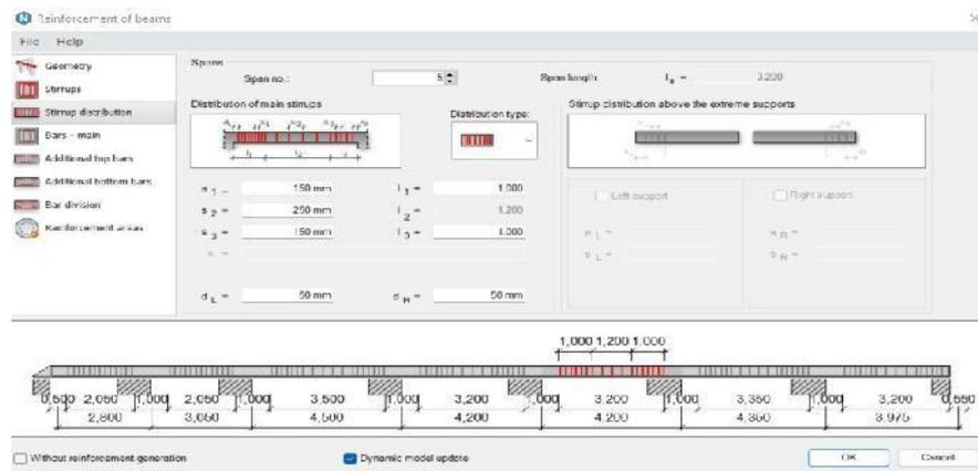
Figura N° 77. Configuración de acero transversal con Navirex
