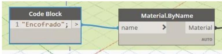
*Figura N° 73. Asignación del Code Block para el material en Dynamo*
