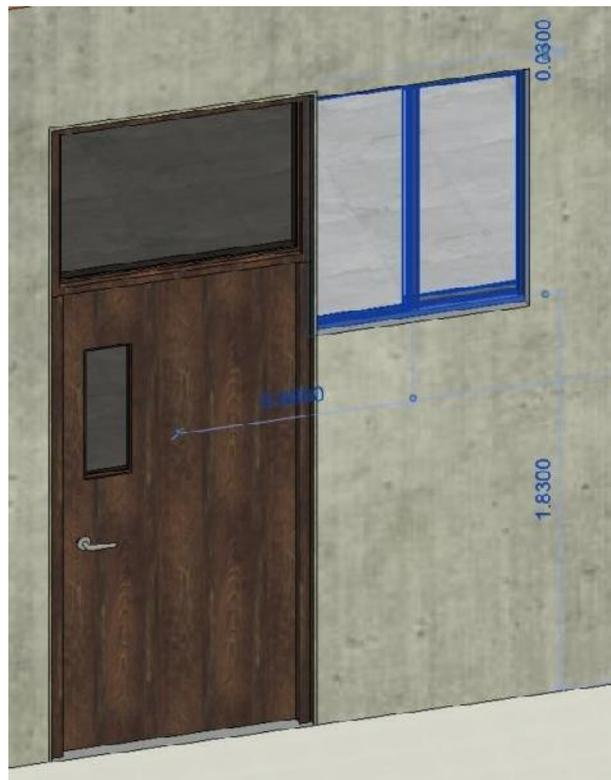
Figura N° 123. Ilustración 1. Vista 3D de la interferencia entre puerta y ventana – Incidencia 4
