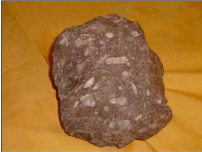
Figura 17. Muestra de una traquita, con una textura porfirítica (Ancochea, 2013).
