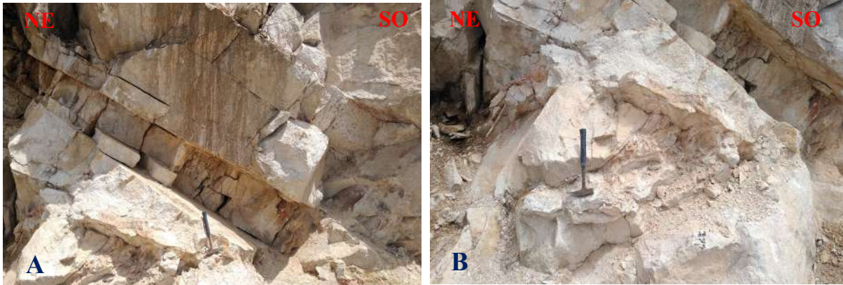
Foto 07. A. ubicación N: 9212374, E: 741381, Cota: 2784. Afloramiento del segundo evento, macizo rocoso de composición riolítica, de coloración blanquecina, moderadamente fracturada. B. Ubicación N: 9212461, E: 711407, Cota: 2810; Afloramiento rocoso de color blanquecino, moderadamente fracturado, de composición riolítica.
