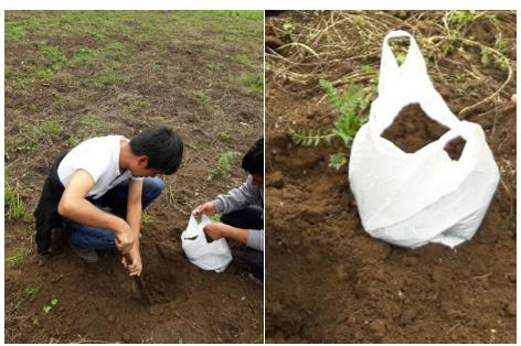
Nota. Con la ayuda de una pala se limpia la primera capa del suelo luego se obtiene la muestra de suelo hasta una profundidad de 25cm.
