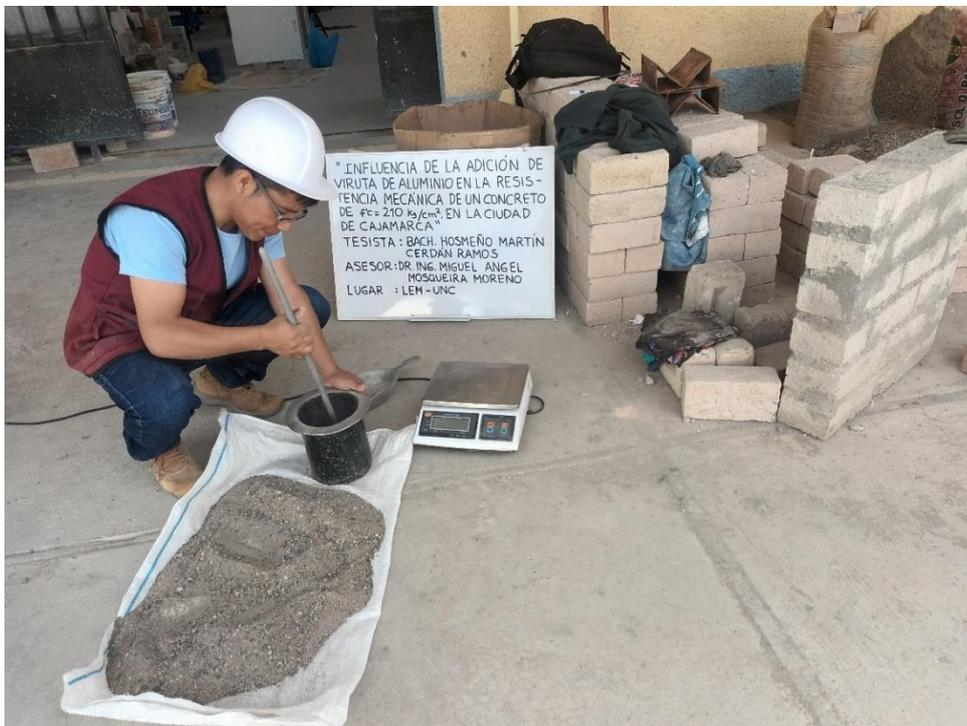
**Figura 32:** Determinación del Asentamiento del concreto.
