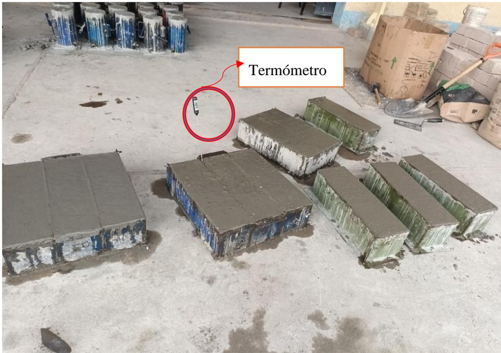
**Figura N° 35:** Elaboración de los especímenes de concreto
