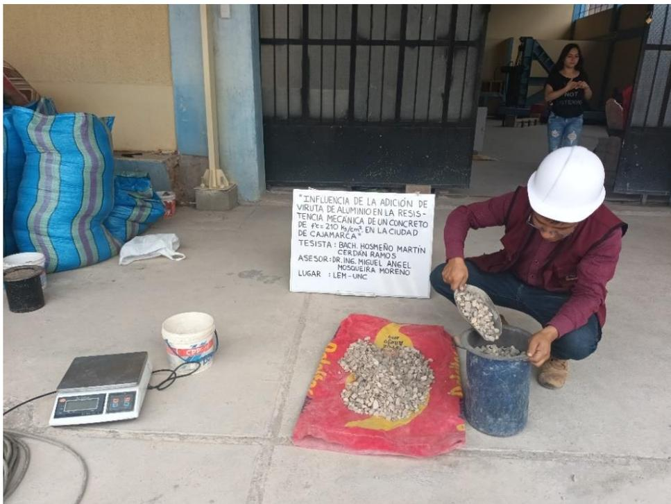
**Figura N° 30:** Peso unitario suelto del agregado fino.
