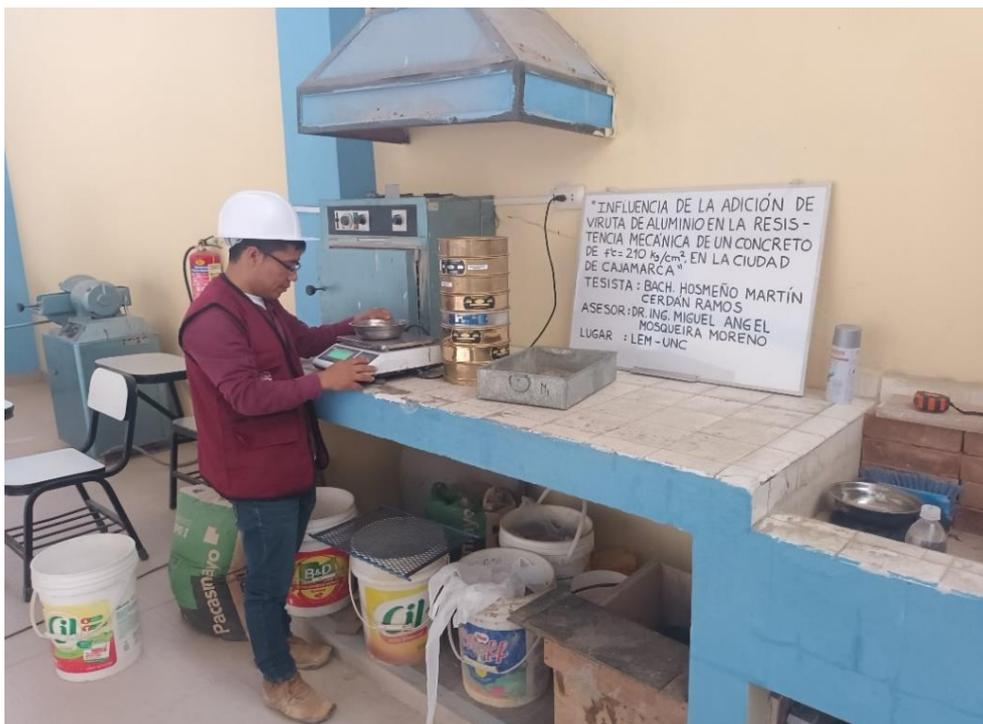
**Figura N° 24:** Análisis Granulométrico del agregado grueso.
