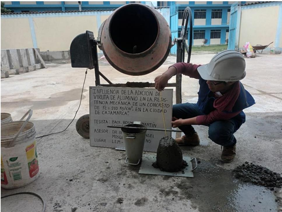
**Figura N° 33:** Peso Unitario del concreto en estado Fresco
