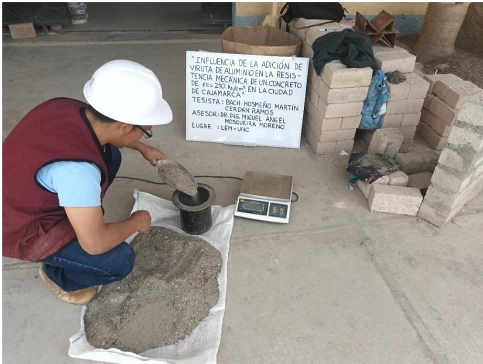
**Figura N° 31:** Peso unitario compactado del agregado fino
