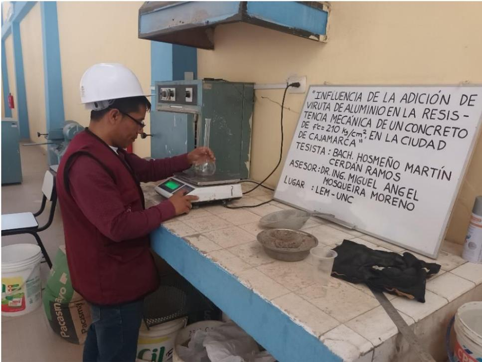
**Figura N° 27:** Determinación del contenido de humedad del de los agregados
