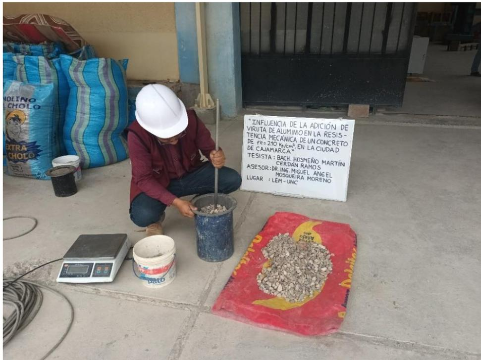
**Figura N° 29:** Peso unitario suelto del agregado grueso.
