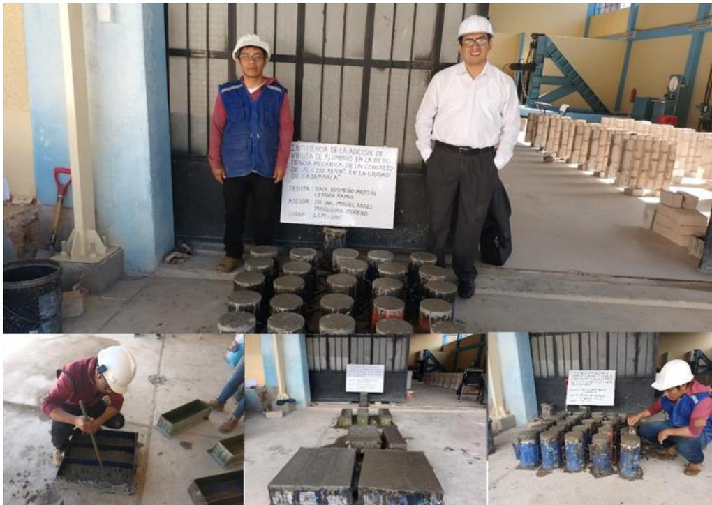
**Figura N° 36: Rotura de Probetas a Compresión**
