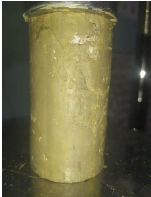
Fotografía N°36: Ensayo de compresión simple Calicata N°11 Muestra N°1
