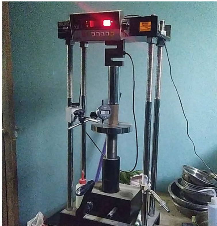
Fotografía N°2: Ensayo de compresión simple - Calicata N° 1
