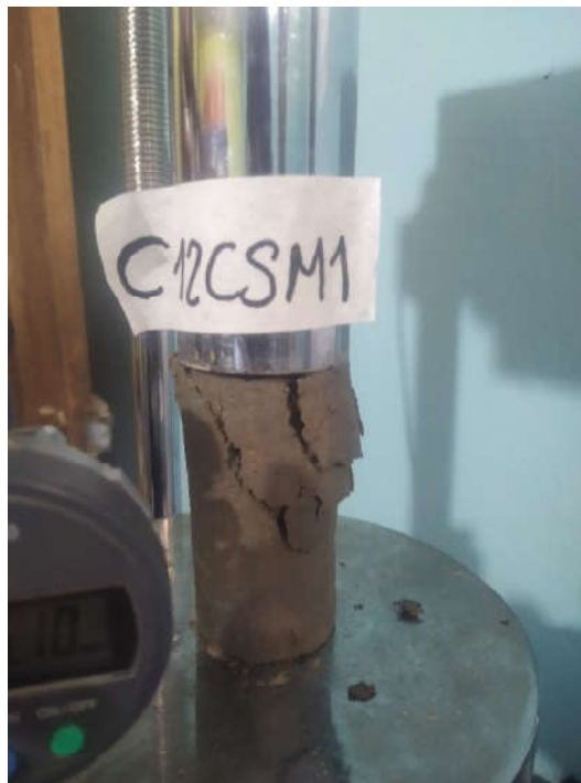
Fotografía N°39: Ensayo de compresión simple Calicata N°12 Muestra N°1
