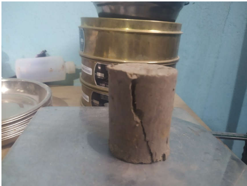
Fotografía N°11: Ensayo de compresión simple Calicata N°1 Muestra N°3
