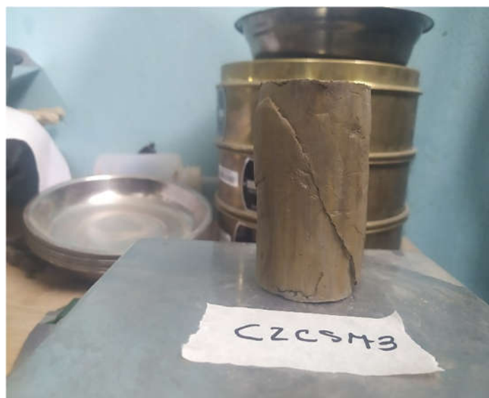
Fotografía N°14: Ensayo de compresión simple Calicata N°2 Muestra N°3
