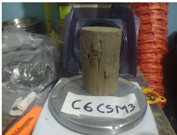
Fotografía N°26: Ensayo de compresión simple Calicata N°6 Muestra N°3
