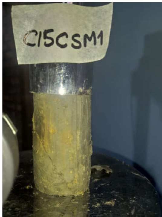
Fotografía N°48: Ensayo de compresión simple Calicata N°15 Muestra N°1
