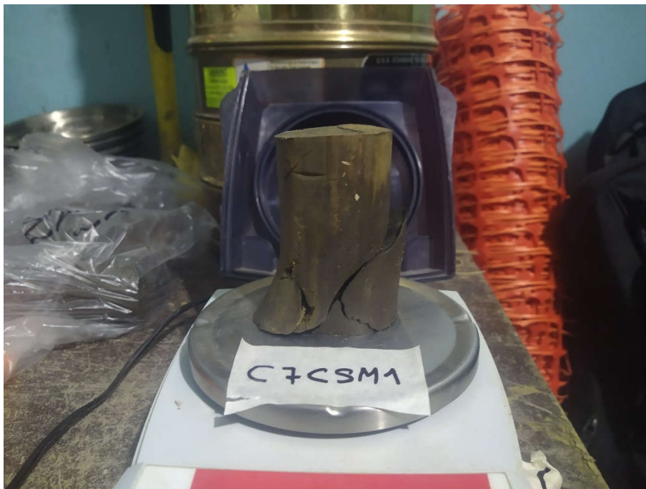
Fotografía N°27: Ensayo de compresión simple Calicata N°7 Muestra N°1
