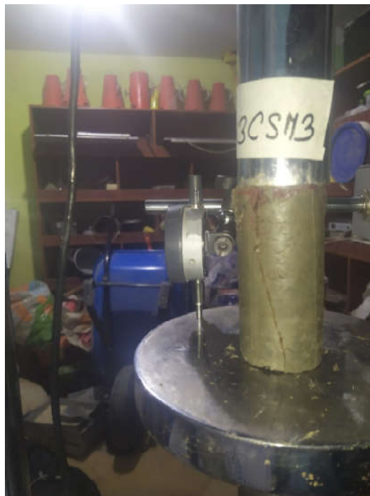
Fotografía N°44: Ensayo de compresión simple Calicata N°13 Muestra N°3
