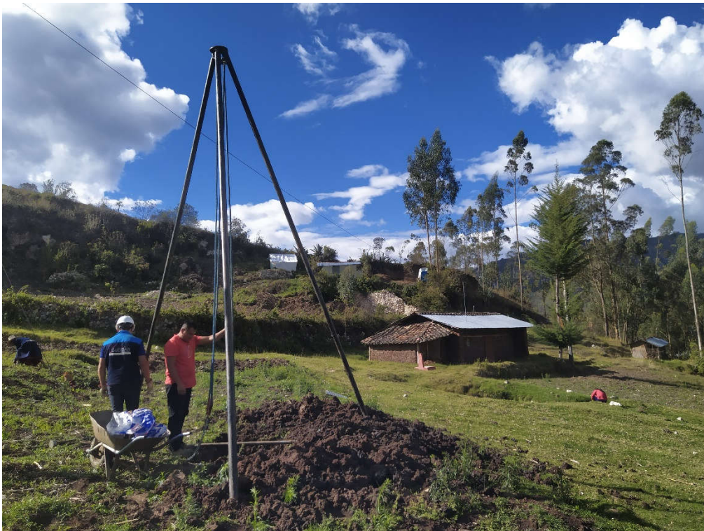
Fotografía N°4: Ensayo penetración estándar (SPT) – Calicata N° 2
