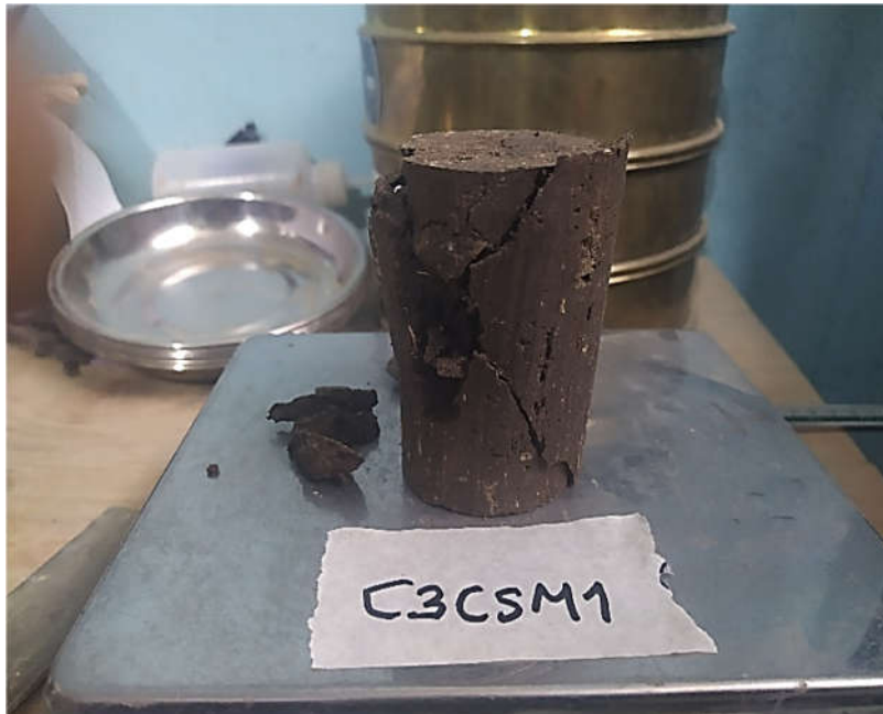
Fotografía N°15: Ensayo de compresión simple Calicata N°3 Muestra N°1
