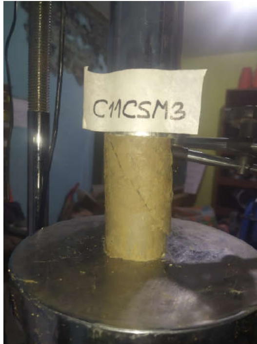
Fotografía N°38: Ensayo de compresión simple Calicata N°11 Muestra N°3
