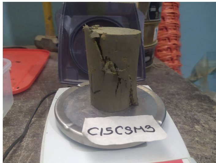
Fotografía N°50: Ensayo de compresión simple Calicata N°15 Muestra N°3
