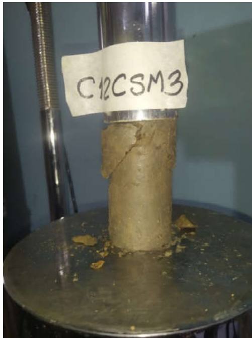
Fotografía N°41: Ensayo de compresión simple Calicata N°12 Muestra N°3
