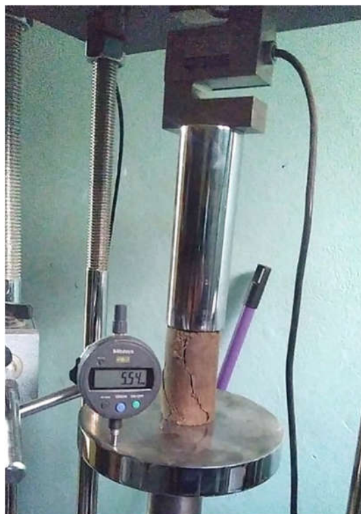
Fotografía N°9: Ensayo de compresión simple Calicata N°1 Muestra N°1
