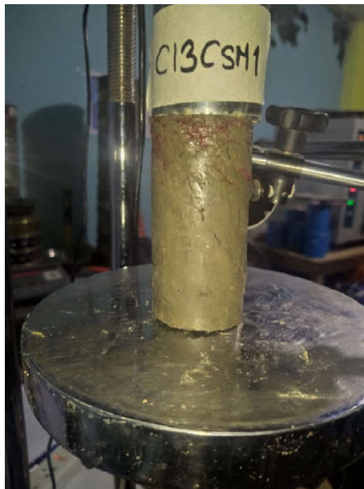
Fotografía N°42: Ensayo de compresión simple Calicata N°13 Muestra N°1
