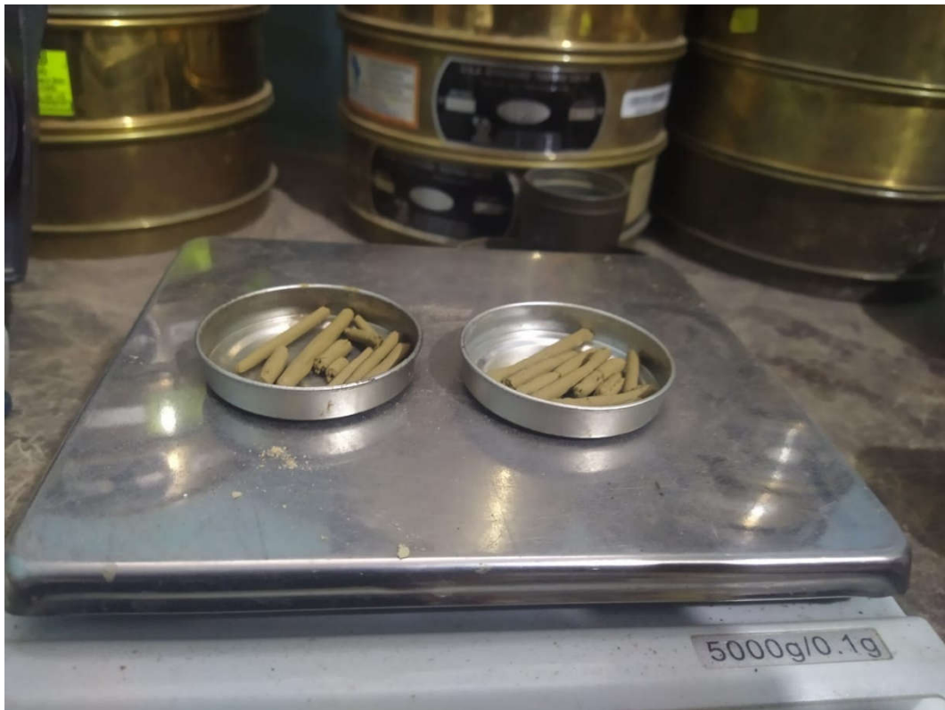
Fotografía N°6: Ensayo de Límite Plástico - Calicata N° 4
