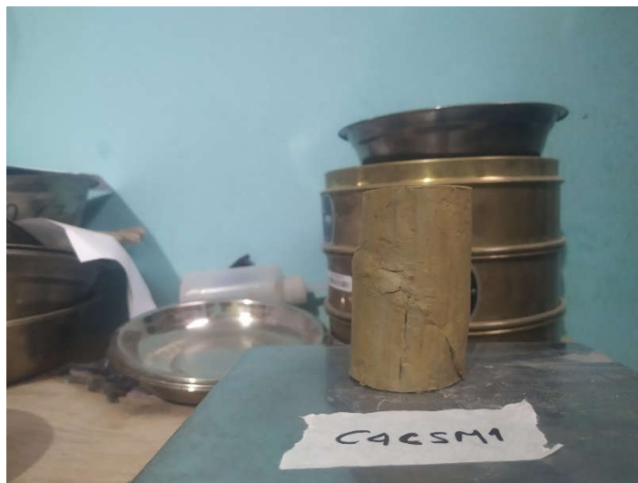
Fotografía N°18: Ensayo de compresión simple Calicata N°4 Muestra N°1
