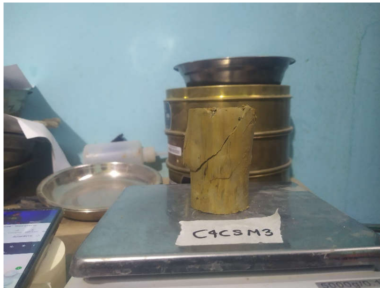
Fotografía N°20: Ensayo de compresión simple Calicata N°4 Muestra N°3
