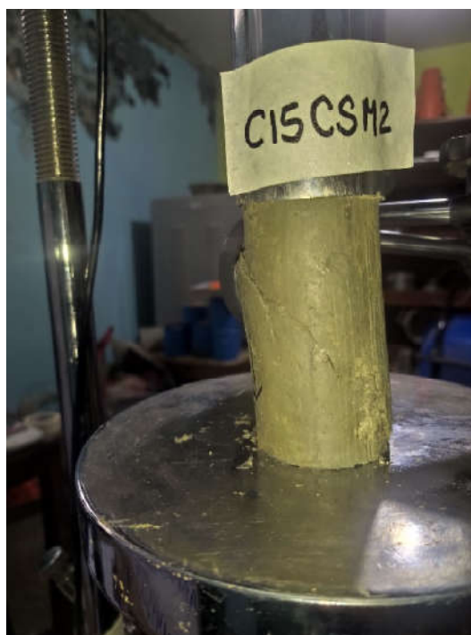
Fotografía N°49: Ensayo de compresión simple Calicata N°15 Muestra N°2
