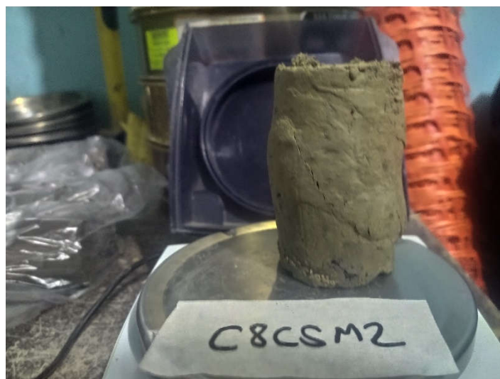
Fotografía N°31: Ensayo de compresión simple Calicata N°8 Muestra N°2
