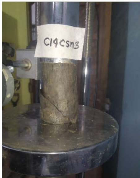
Fotografía N°47: Ensayo de compresión simple Calicata N°14 Muestra N°2
