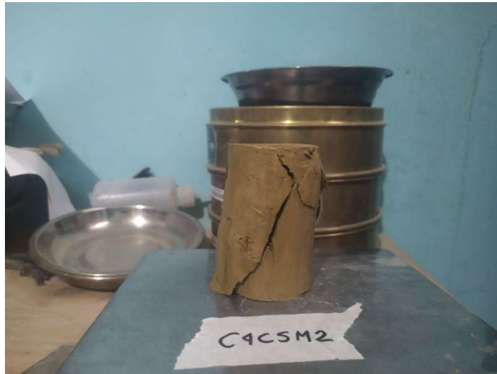
Fotografía N°19: Ensayo de compresión simple Calicata N°4 Muestra N°2
