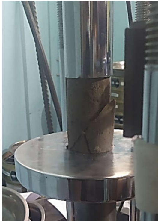
Fotografía N°10: Ensayo de compresión simple Calicata N°1 Muestra N°2
