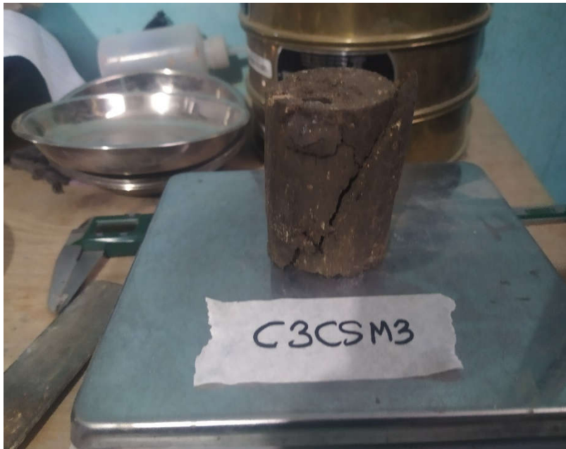
Fotografía N°17: Ensayo de compresión simple Calicata N°3 Muestra N°3
