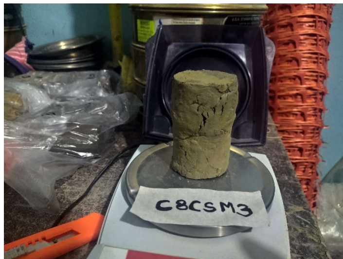
Fotografía N°32: Ensayo de compresión simple Calicata N°8 Muestra N°3
