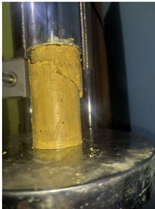
Fotografía N°34: Ensayo de compresión simple Calicata N°10 Muestra N°2
