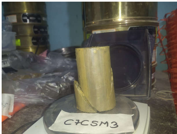
Fotografía N°29: Ensayo de compresión simple Calicata N°7 Muestra N°3
