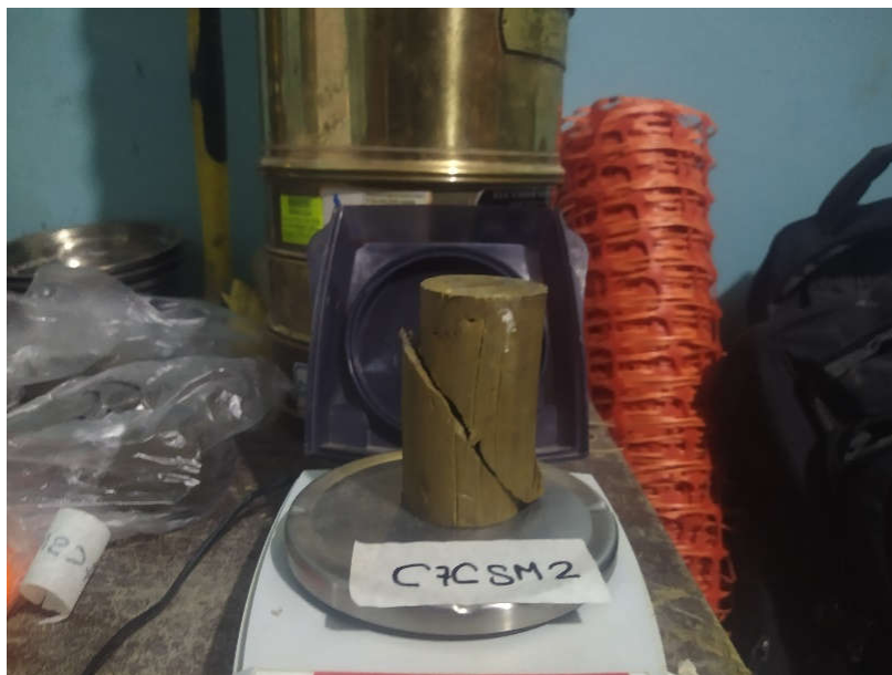
Fotografía N°28: Ensayo de compresión simple Calicata N°7 Muestra N°2
