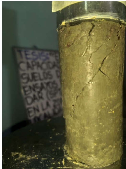
Fotografía N°43: Ensayo de compresión simple Calicata N°13 Muestra N°2
