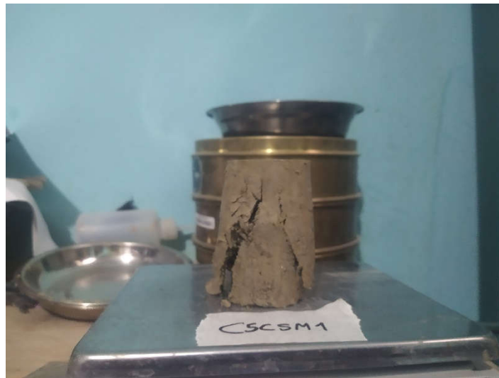
Fotografía N°21: Ensayo de compresión simple Calicata N°5 Muestra N°1
