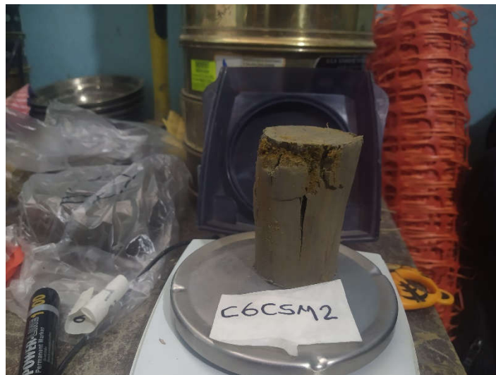
Fotografía N°25: Ensayo de compresión simple Calicata N°6 Muestra N°2
