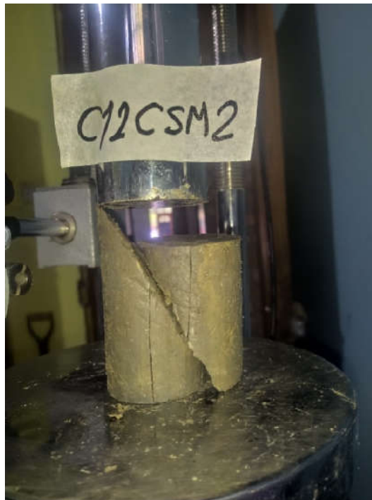
Fotografía N°40: Ensayo de compresión simple Calicata N°12 Muestra N°2
