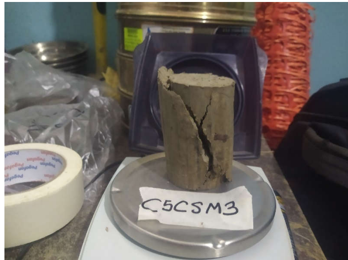
Fotografía N°23: Ensayo de compresión simple Calicata N°5 Muestra N°3
