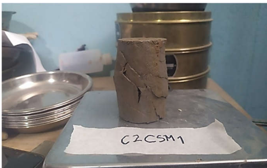
Fotografía N°12: Ensayo de compresión simple Calicata N°2 Muestra N°1
