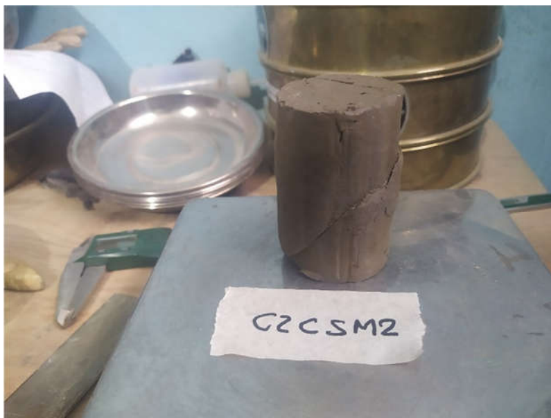
Fotografía N°13: Ensayo de compresión simple Calicata N°2 Muestra N°2
