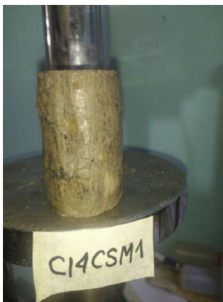
Fotografía N°45: Ensayo de compresión simple Calicata N°14 Muestra N°1
