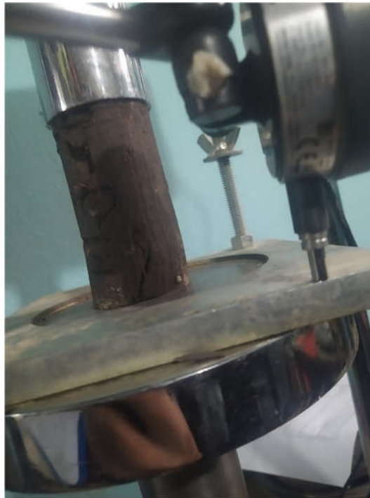
Fotografía N°16: Ensayo de compresión simple Calicata N°3 Muestra N°2
