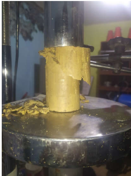
Fotografía N°35: Ensayo de compresión simple Calicata N°10 Muestra N°3
