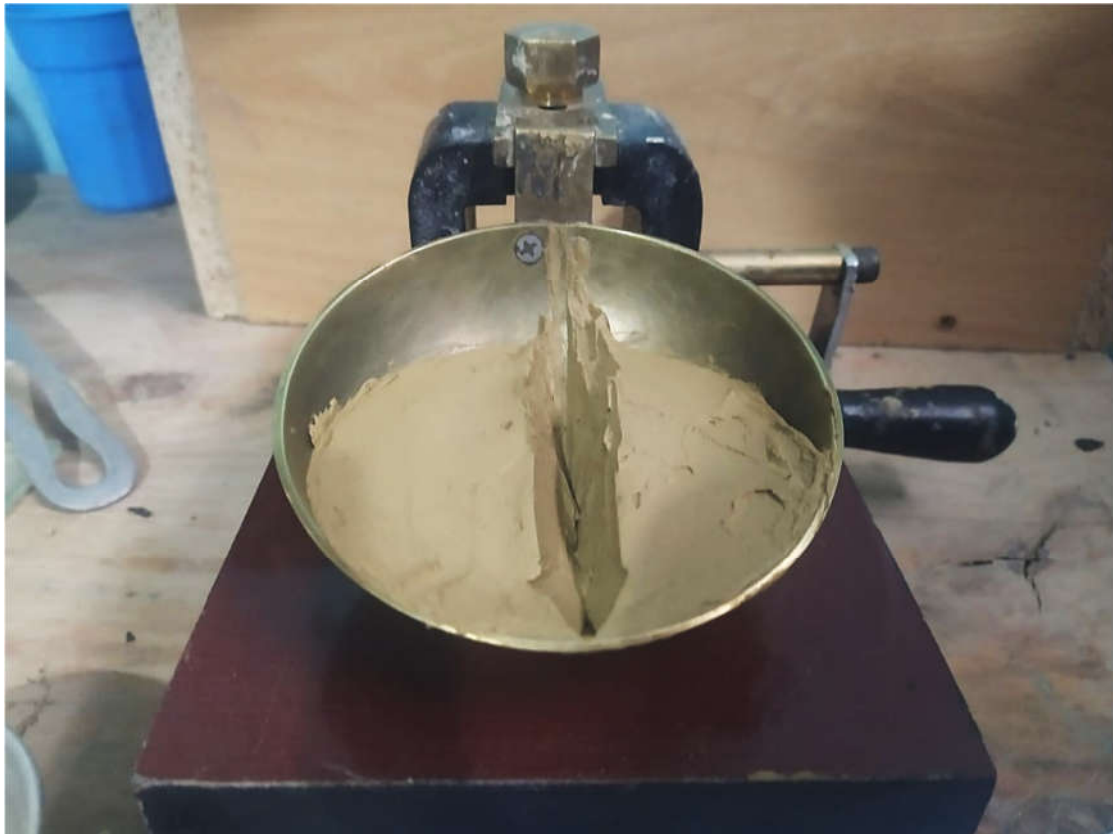
Fotografía N°6: Ensayo de Límite Plástico - Calicata N° 4
