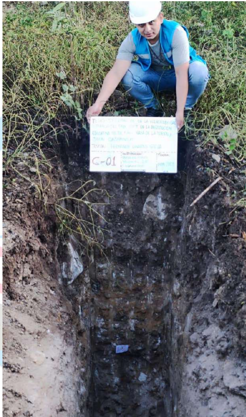
FOTOGRAFIA 01: Muestra la excavación de la calicata C-01 y posterior muestreo correspondiente.
