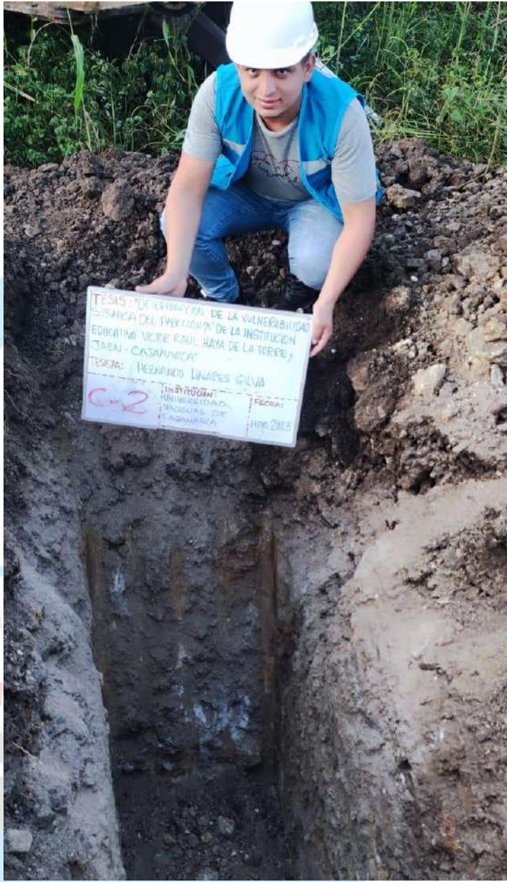
FOTOGRAFIA 02: Muestra la excavación de la calicata C-02 y posterior muestreo correspondiente.
