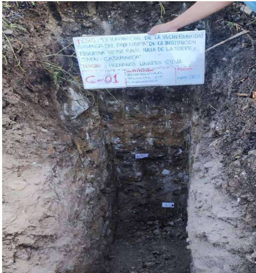
Foto 10: Estudio de mecánica de suelos en el Pabellón "A" de la I.E. Víctor Raúl Haya de la Torre.
