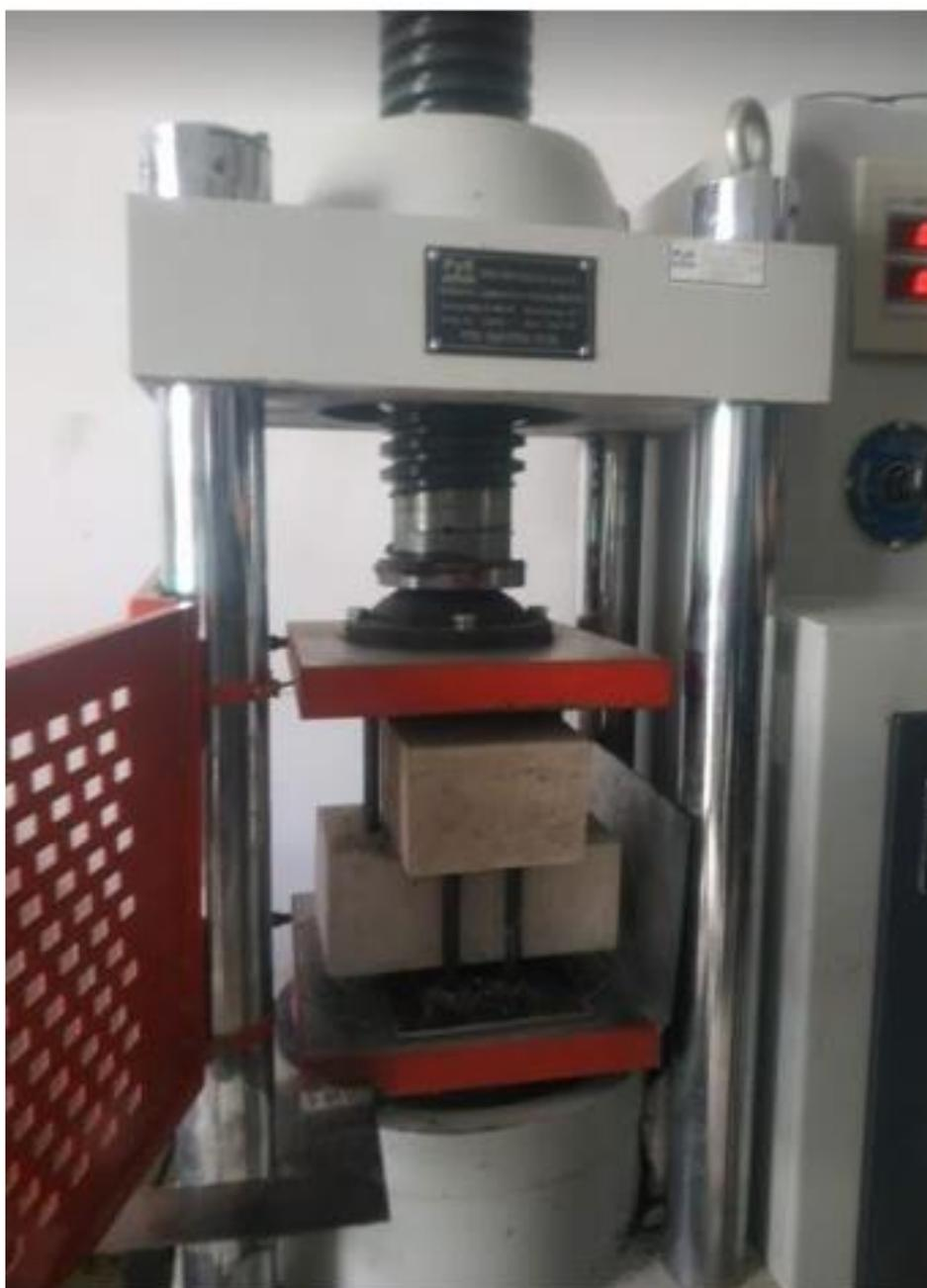
Foto 7. Ensayo para hallar la resistencia a la adhesión por tracción según nos indica la Norma Técnica Guatemalteca NTG 41051 h7 (Comisión Guatemalteca de Norma, 2014) traducción de ASTM C476 (American Society for Testing and Materials, 2000)
