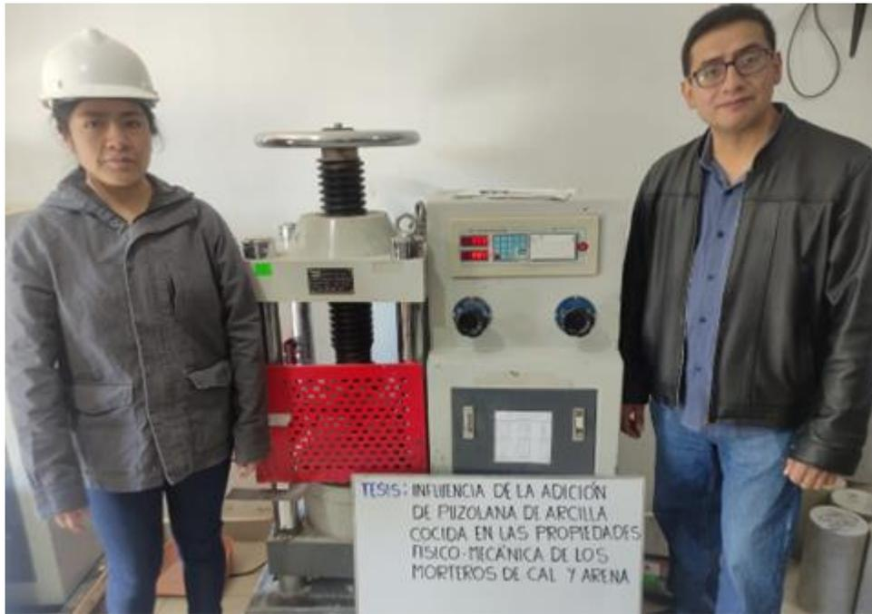
Foto 8. Durante el ensayo para hallar la resistencia a la adhesión por tracción según nos indica la Norma Técnica Guatemalteca NTG 41051 h7 (Comisión Guatemalteca de Norma, 2014) traducción de ASTM C476 (American Society for Testing and Materials, 2000)
