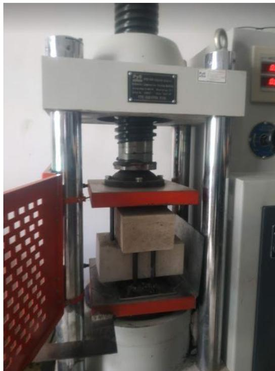
**Ensayo para densidad Aparente De Mortero Endurecido, peso seco( $g/cm^3$ ). Según ASTM C642 (American Society of testing Materials, 2013)**
