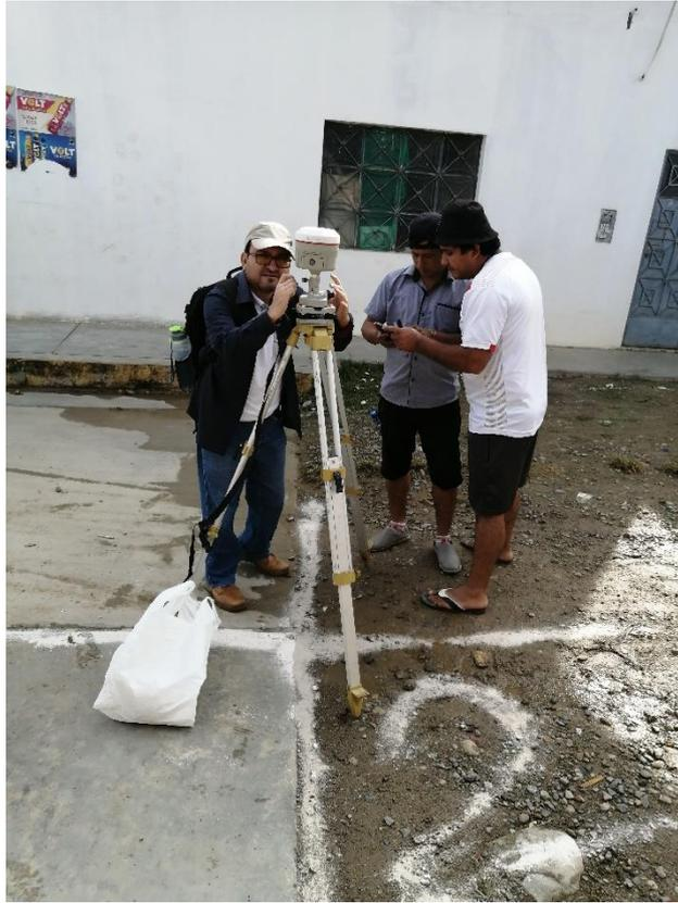
Fotografía 7. Levantamiento topográfico del sector El Parral – ubicación de puntos georreferenciados
