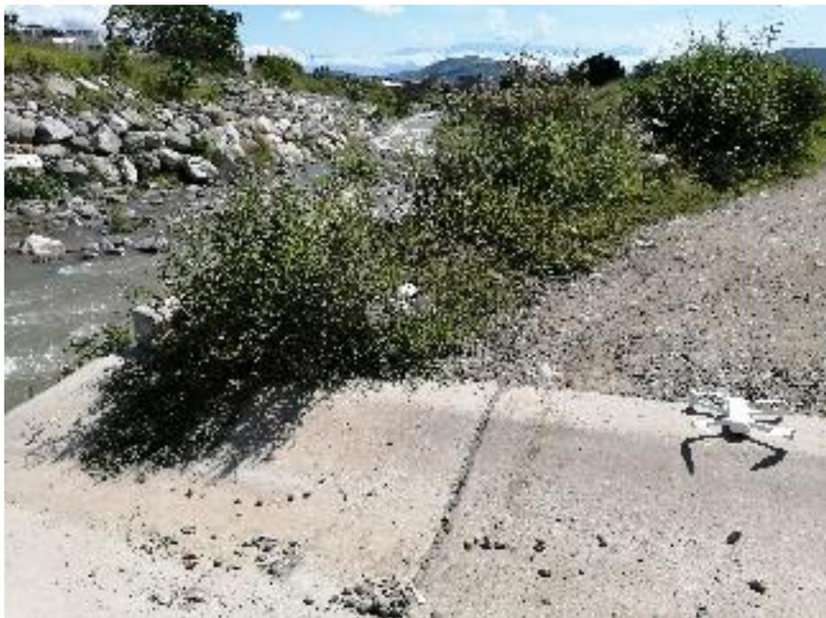
Fotografía 16. Levantamiento topográfico con drom, lo cual dio como resultado el plano y la foto aérea que se empleado en la investigación.
