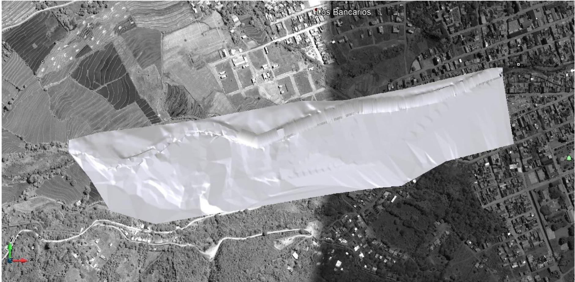
Figura 45. Mapa en planta de las mallas de modelación de quebrada Amojú
