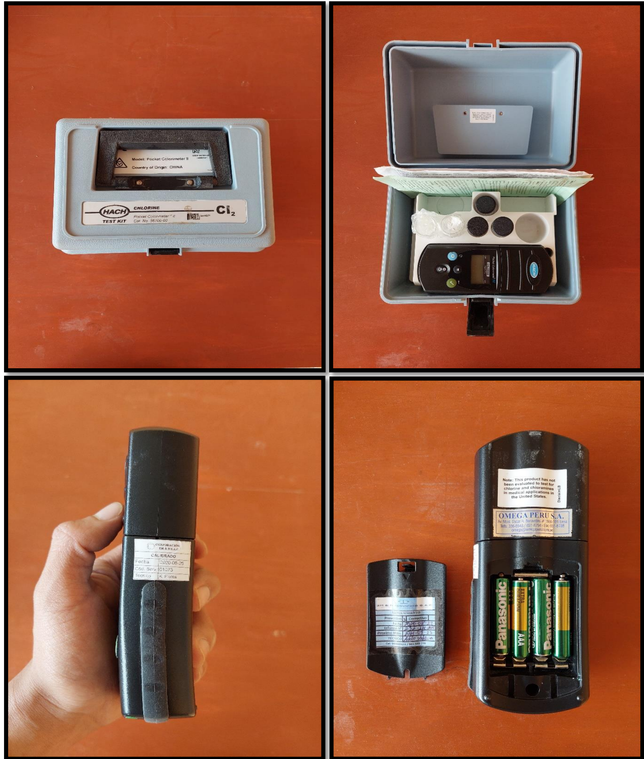
Figura 8. Equipo colorímetro marca HACH calibrado, modelo Pocket Colorimeter II, con una celda de muestra (Zero) y dos celdas cubetas (A y B) de vidrio de 10 ml.
