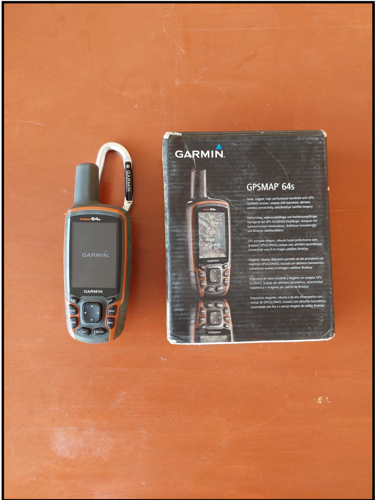
Figura 10. Equipo de Posicionamiento Global (GPS) marca Garmin, modelo GPSMAP64s.
