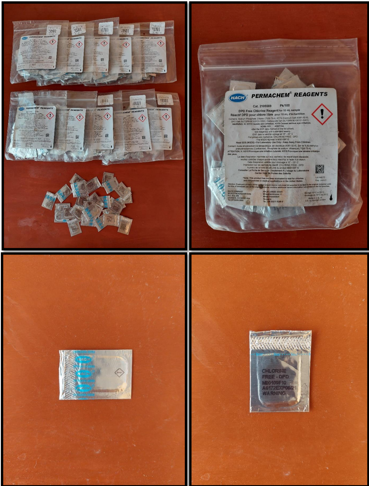
Figura 9. Reactivos en polvo de cloro libre residual para cada celda cubeta de 10 ml.
