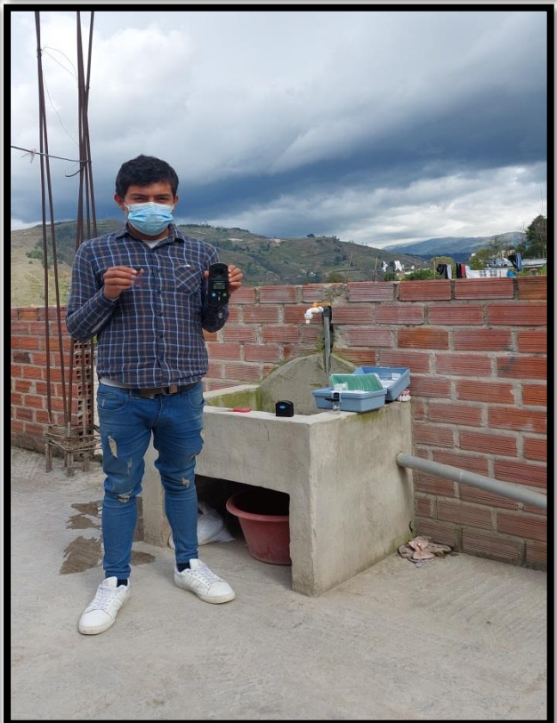
Figura 11. Monitoreo de cloro libre residual en las 356 viviendas desde los meses de Setiembre 2020 a Febrero 2021 con el equipo colorímetro digital, debidamente calibrado.
