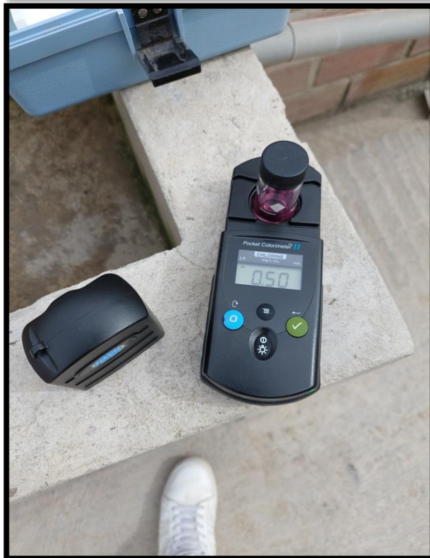
Figura 11. Monitoreo de cloro libre residual en las 356 viviendas desde los meses de Setiembre 2020 a Febrero 2021 con el equipo colorímetro digital, debidamente calibrado.
