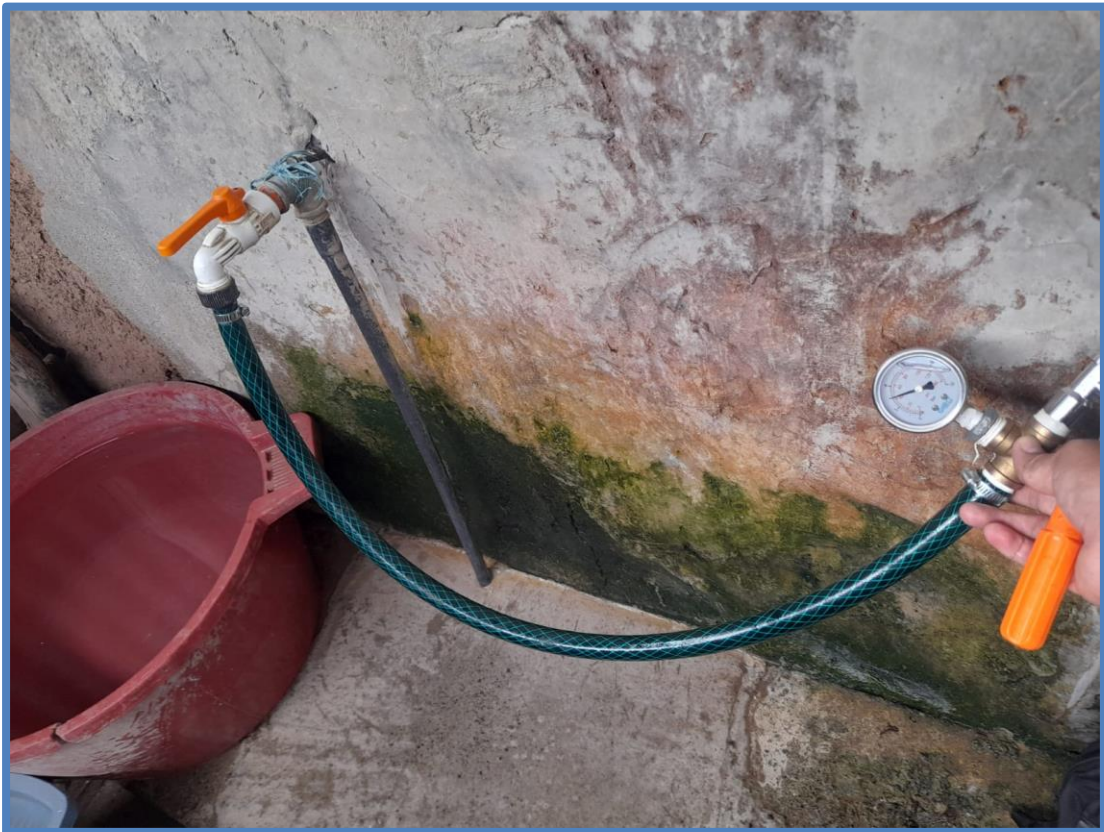
Foto 10: Medición de presión en los domicilios.
